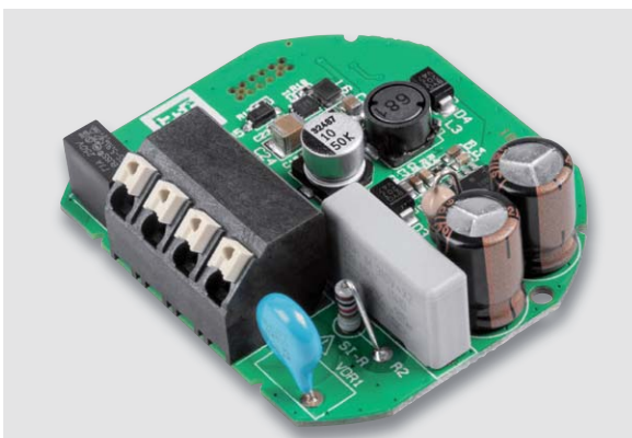
Bild 5: Hier sind die exakt bestückten bedrahteten Bauteile der Stromversorgungsplatine zu sehen.
