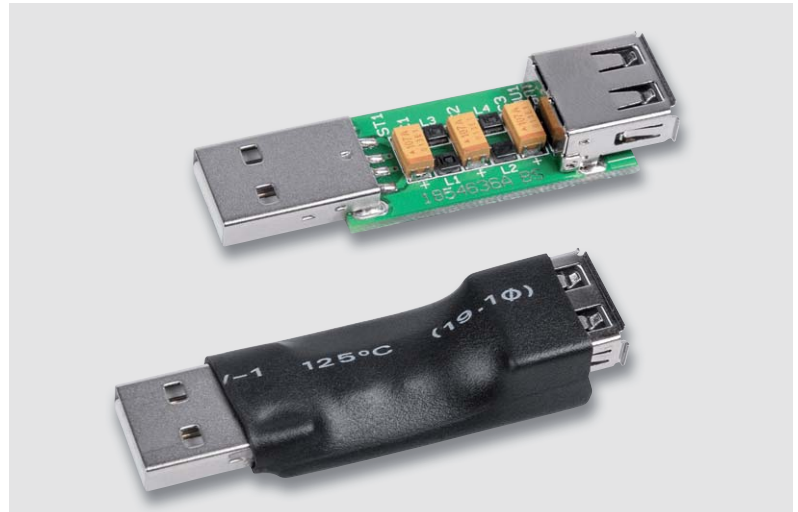
Bild 4: Das USB-EF1 vor und nach dem Einschrumpfen
