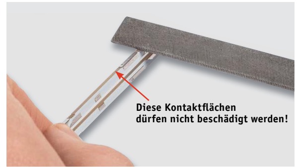
Bild 3: Der Grat wird vorsichtig mit einer Feile entfernt, ohne die Kontakte zu beschädigen.
