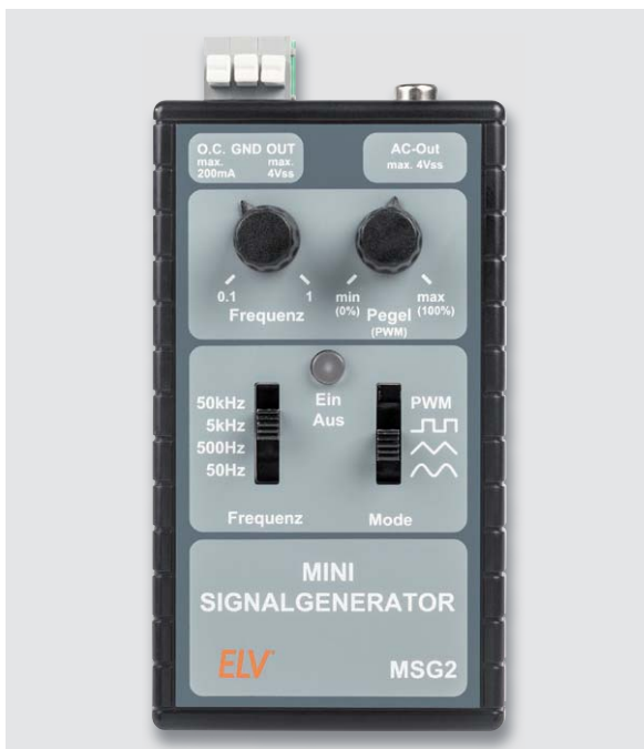
Bild 4: Der Blick auf die Frontplatte des MSG2 zeigt die übersichtliche Anordnung der wenigen Bedienelemente.
