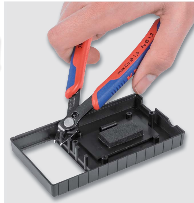
Bild 12: Die vier runden Stege sind mit einem Seitenschneider abzuschneiden.
