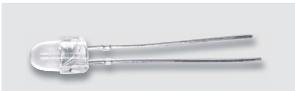
Bild 1: Einfaches Roboterauge: Fototransistor BPW40
