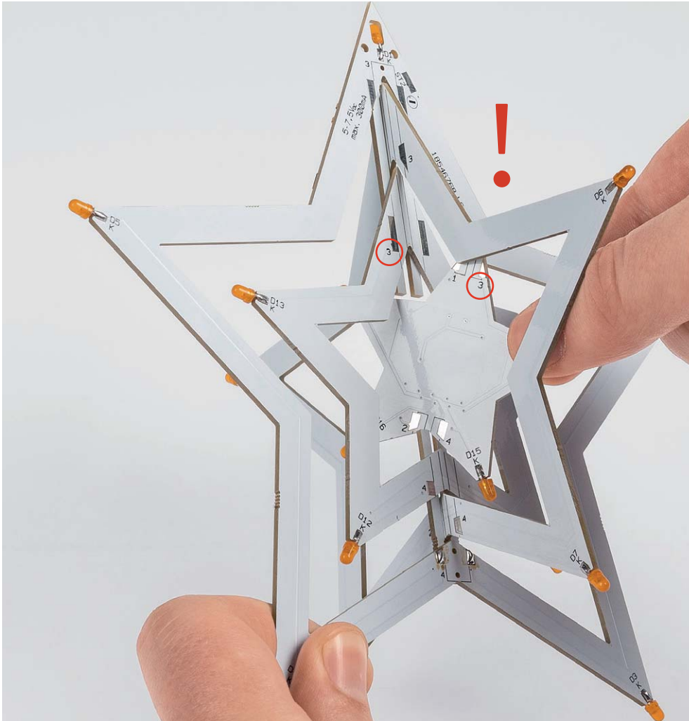
Bild 11: Die mittlere Sternplatine wird eingesetzt.
