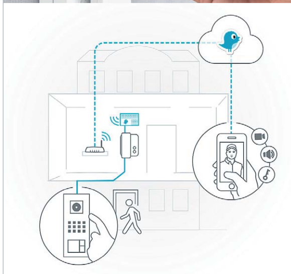
Bild 10: Mit einem IP-Gateway kann man auch eine normale analoge Türsprechanlage zur IP-Anlage machen. Per App lässt sich dann vom Smartphone aus Verbindung mit dem Besucher an der Tür aufnehmen. Die hier gezeigte DoorBird D301 ist mit vielen gängigen Türsprechanlagen, z. B. von Siedle und RITTO, kompatibel. Bilder: DoorBird
