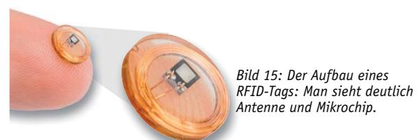
Bild 15: Der Aufbau eines RFID-Tags: Man sieht deutlich Antenne und Mikrochip.
