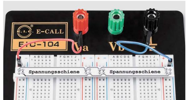
Bild 17: Spannungsschiene im Einsatz auf einem Steckboard
