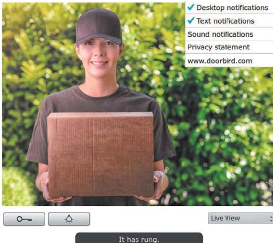
Bild 2: Über ein angebotenes HTML5-Widget kann man per Webbrowser die Kamerabilder ansehen und die Peripheriefunktionen steuern. Bild: Doorbird
