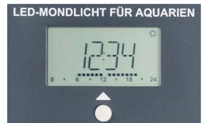
Bild 12: In der Nachtdarstellung erscheint die Balkenleiste entsprechend der Verlaufsrichtung der aktuellen Mondphase: Im oberen Bild wird zunehmender Mond angezeigt, im mittleren Bild Vollmond und im unteren Bild abnehmender Mond.
