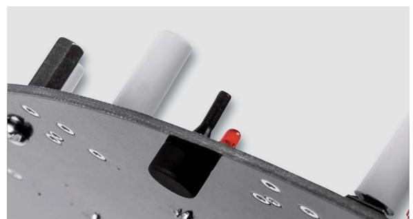
Bild 14: Die GummifüÙe sind, wie hier gezeigt, von unten durch die Platine zu ziehen, bis ihre eingearbeitete Nut in die Platine einrastet.
