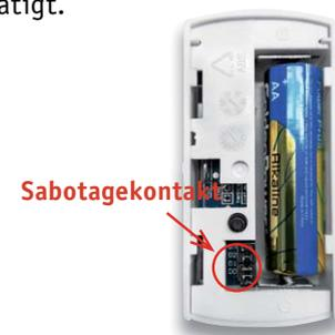
Löschen Sie den Sensor aus der Zentrale und melden Sie den Sensor anschließend wieder an. Beachten Sie beim Anmelden, dass Sie den Sensor lediglich auslösen (Fenster öffnen). Betätigen Sie zum Anmelden nicht den Sabotagekontakt. **ELV**
