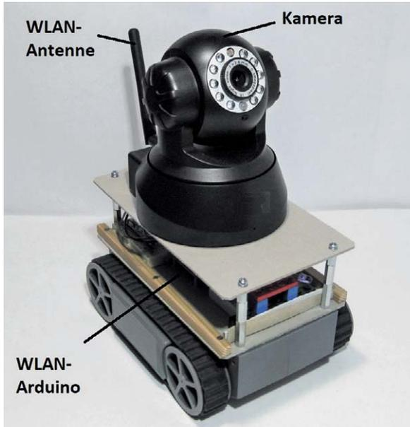
Bild 3: Roboterfahrzeug mit WLAN-Kamera
