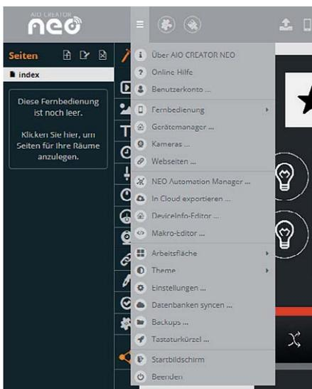
Bild 6: Um nun den Neo-Server einzubinden, ist im Menü der Geräte-Manager zu öffnen. Hier finden sich auch die Menüpunkte zur Einbindung von Netzwerkkameras und zum Start des Neo Automation Managers.
