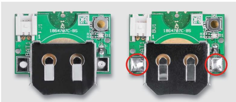
Bild 4: Hier ist die Montage des Buchsensteckers BU1 und des Batteriehalters zu sehen. Der Batteriehalter ist mit reichlich Lötzinn anzulöten, da er durch die Batterie mechanisch belastet wird.
