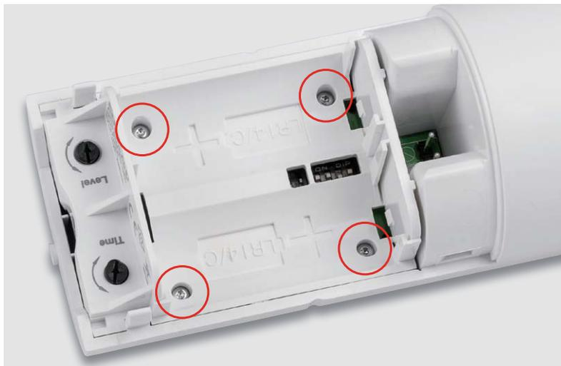
Bild 13: Verschrauben der Leiterplatte mit dem Batteriehalter
