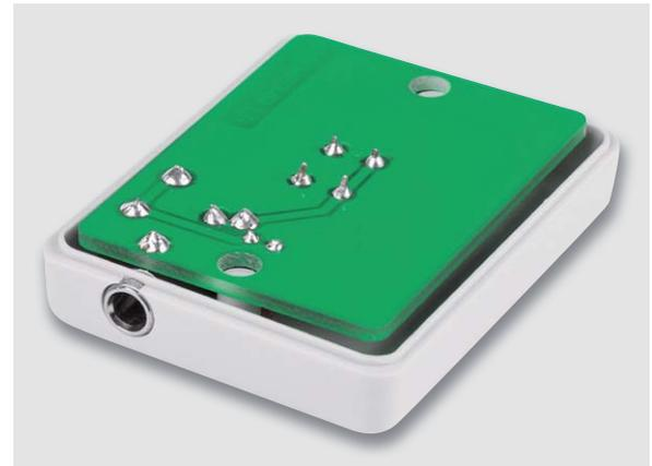
Bild 22: Als Montagehilfe legt man die Platine mit eingesetzter LED kopfüber in die Gehäuseoberschale und lötet die Anschlüsse nun fest.
