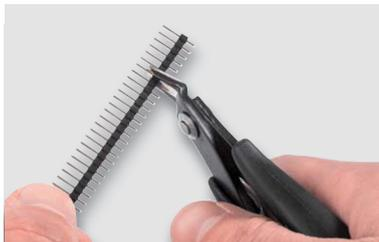
Bild 19: So werden die Stiftleisten zugeschnitten.
