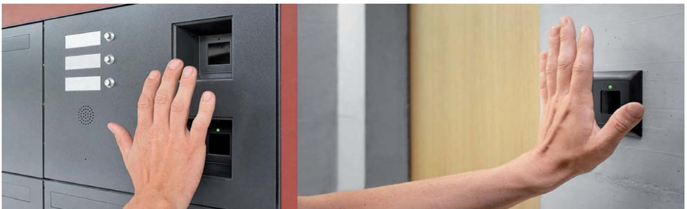
Bild 9: Installationsbeispiele für hochwertige Handvenenleser. Hier muss man die Hand nicht einmal auflegen, einige Zentimeter Abstand genügen.
