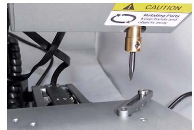
Bild 22: Recht einfach – Fräswerkzeughalterung mit Inbusschraube
