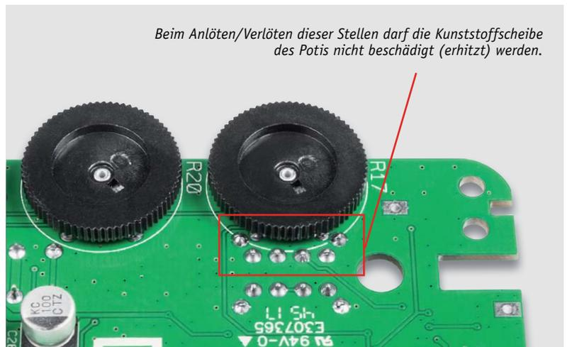
Beim Anlöten/Verlöten dieser Stellen darf die Kunststoffscheibe des Potis nicht beschädigt (erhitzt) werden.
