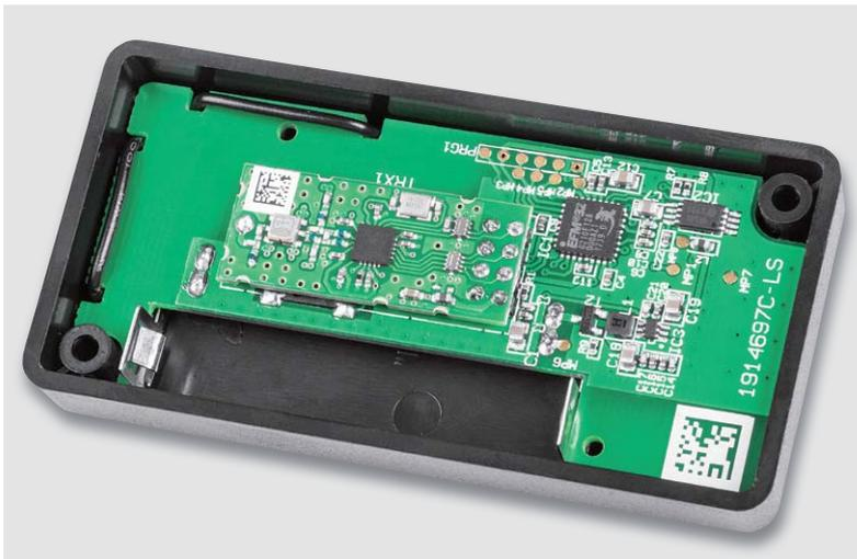
Bild 14: Die in das Gehäuse in der richtigen Lage eingelegte Platine ...
