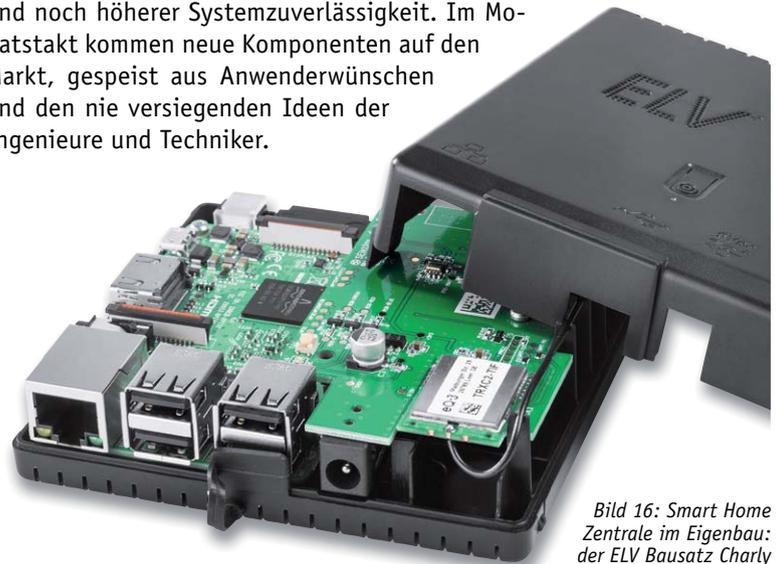
Bild 16: Smart Home Zentrale im Eigenbau: der ELV Bausatz Charly
