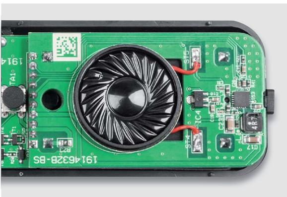
Bild 9: So wird der Lautsprecher angeschlossen und in die Batterieplatine eingesetzt.
