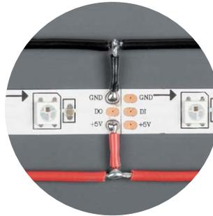
Verstärkung der Spannungsversorgungsleitung durch zusätzliches parallel geführtes Kabel Querschnitt >0,75 mm<sup>2</sup>
