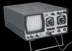
1982 – 10-MHz-Oszilloskop ELV Uniscope
