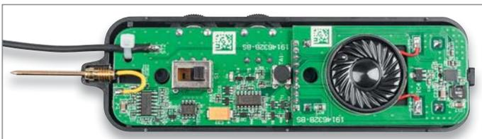
Der Mini-Signalverfolger vereinigt gleich zwei Prüfgeräte in einem handlichen Gehäuse. Ein in der Verstärkung anpassbarer Signalverfolger mit Lautsprecher-Ausgabe und ein integrierter 1-kHz-Sinusgenerator bilden eine handliche Einheit und somit ein vielseitig einsetzbares, mobiles Test-Equipment.
