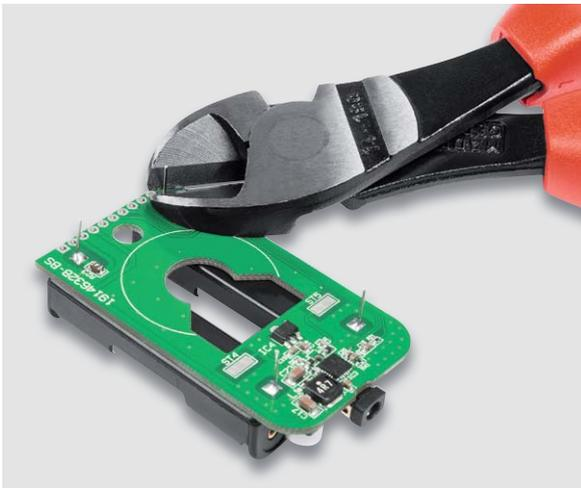
Bild 5: Die Anschlussdrähte (Stahldraht) der Batteriehalter werden mit einem kräftigen Seitenschneider abgeschnitten.
