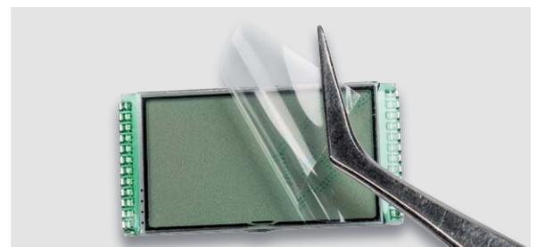
Bild 11: So erfolgt das Abziehen der Display-Schutzfolie.
