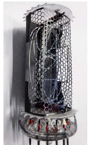
Bild 2: Hier sieht man den Aufbau mit Anodengitter und den hintereinander angeordneten Zeichenkathoden.
