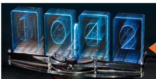
52 Erben der Röhre Lixie, die LED-Version der Anzeigeröhre
