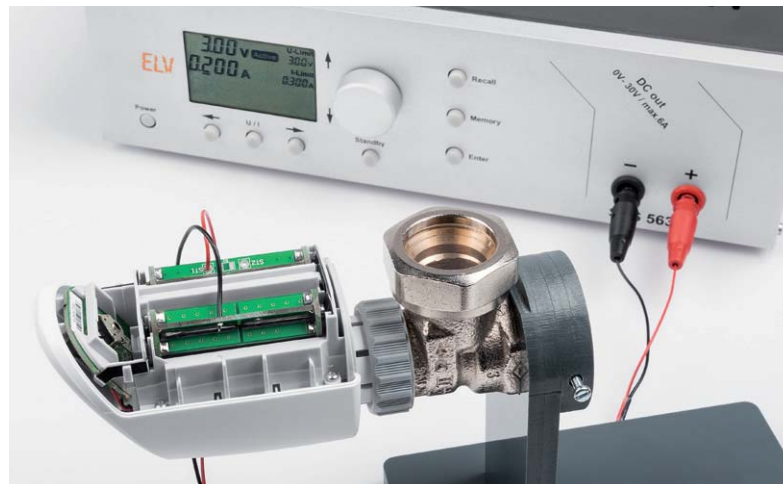
Bild 8: Der Batteriedummy im Einsatz – hier beim Test eines elektronischen Heizkörperthermostats an einem Labornetzteil
