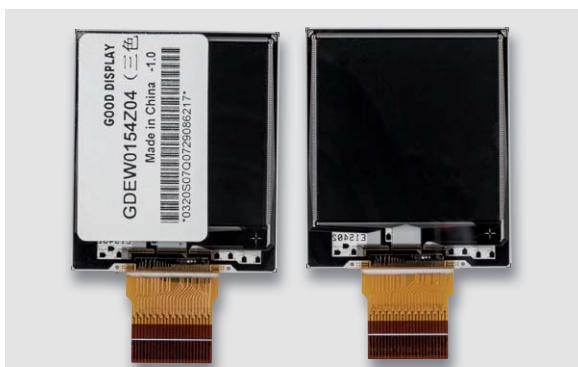
Bild 15: Der Aufkleber auf der Displayrückseite ist vorsichtig zu entfernen.
