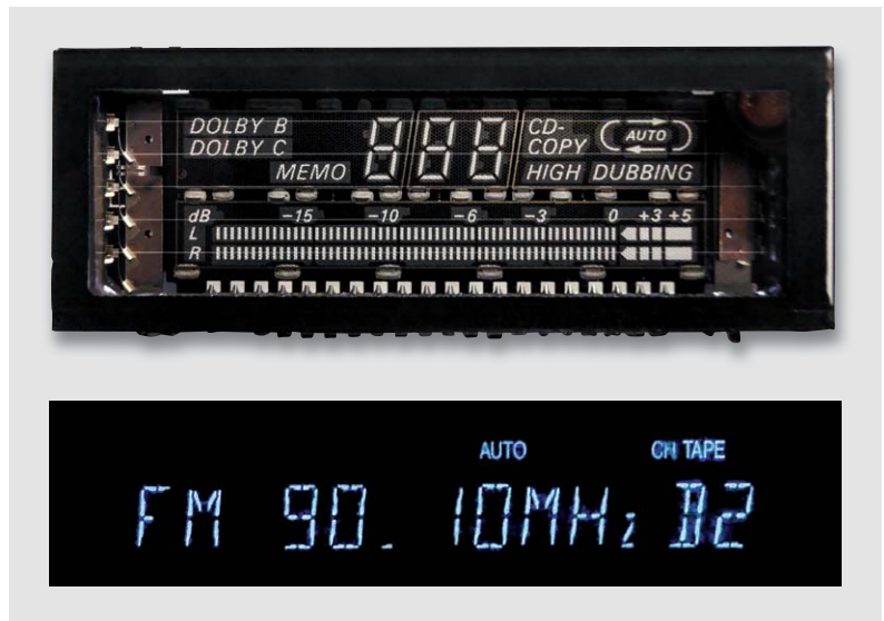
Bild 4: Die VFD – oben sieht man gut das Kathodendrahtgitter vor den Anodenelementen, unten eine solche Anzeige in Aktion.
