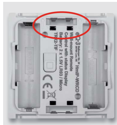
Bild 20: Beim Aufsetzen des Anzeigeegeräts ist ebenfalls darauf zu achten, dass die eingepprägten Pfeile nach oben weisen.
