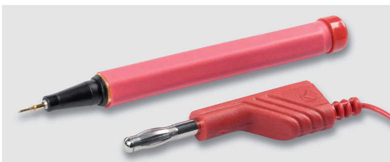
Bild 14: So sieht die fertige Messspitze mit einem passenden 4-mm-Bananenstecker aus.
