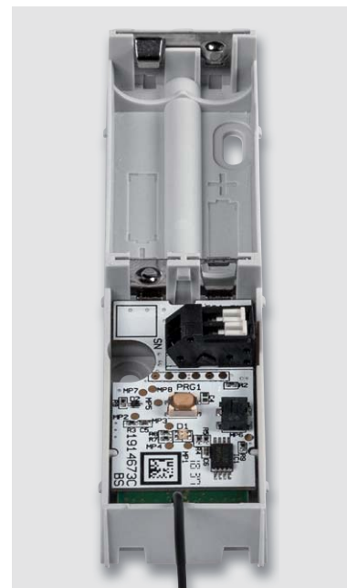
Bild 6: So werden Platine und Batteriebrückenkontakt in die Gehäuseunterschale eingelegt.
