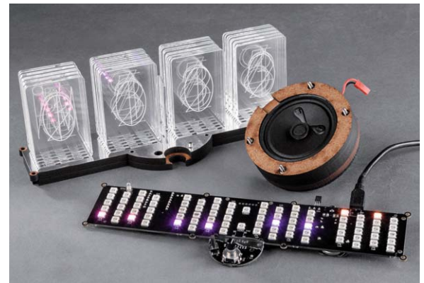
Bild 8: Hier ist gut zu sehen, wie der Lautsprecher im Holzgehäuse untergebracht ist – Voraussetzung für einen guten Klang, zu dem auch der Holzkorpus des Zifferträgers beiträgt.
