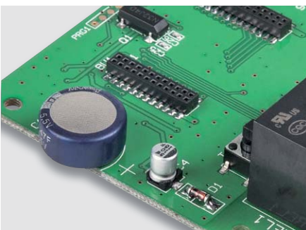
Bild 12: Einlöten des Goldcap
