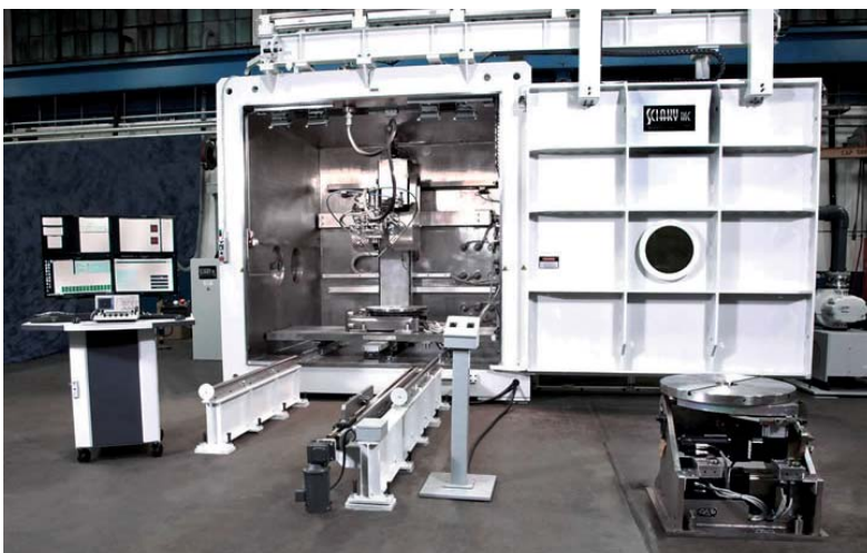
Bild 12: Komplexe, hochbelastbare Teile, z. B. für Flugzeuge, entstehen auf überdimensionalen EBM-Maschinen. Foto: Sciaky
