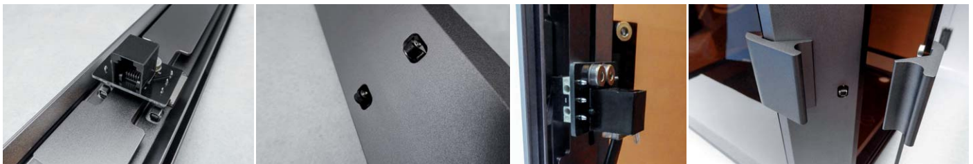
Bild 6: Die mitgelieferten und über ein Kabel an einen freien Port der Steuerelektronik angeschlossenen Türkontakte sorgen für ein sofortiges Abschalten des Lasers beim Öffnen einer der beiden Türen.
