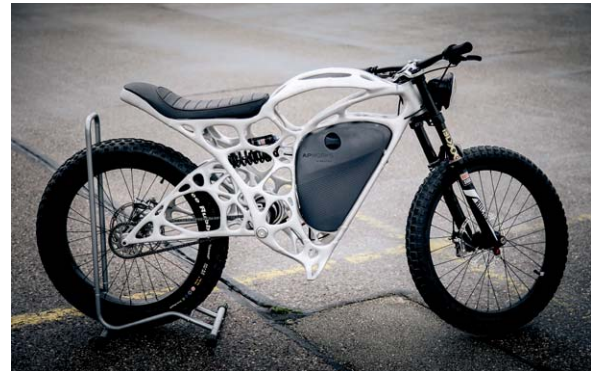
Bild 11: Der Light Rider von APWorks zeigt, dass auch komplizierteste Strukturen per 3D-Druck realisierbar sind. Foto: APWorks
