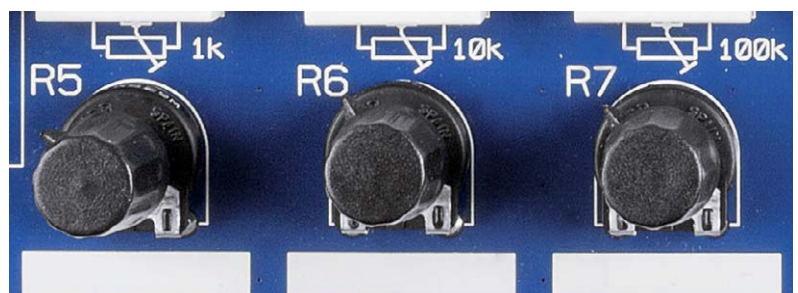
Bild 8: Drei Potentiometer mit unterschiedlichen Werten ermöglichen eine vielfältige Nutzung.
