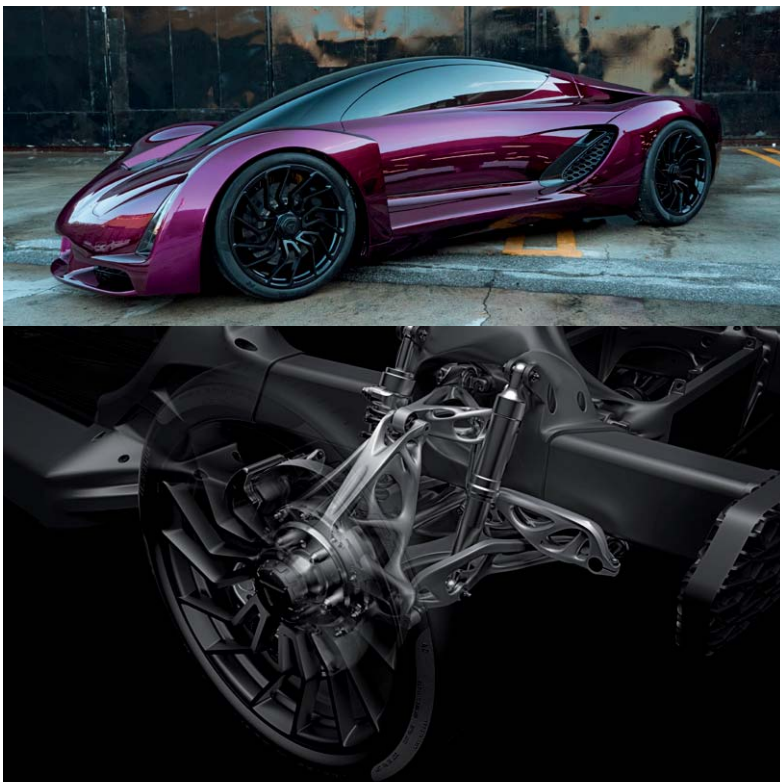
Bild 10: Chassis nahezu ausschließlich aus additiv hergestellten Metall-, Kunststoff- und Verbundteilen – der „Divergent Blade“-Sportwagen. Fotos: Divergent3d.com
