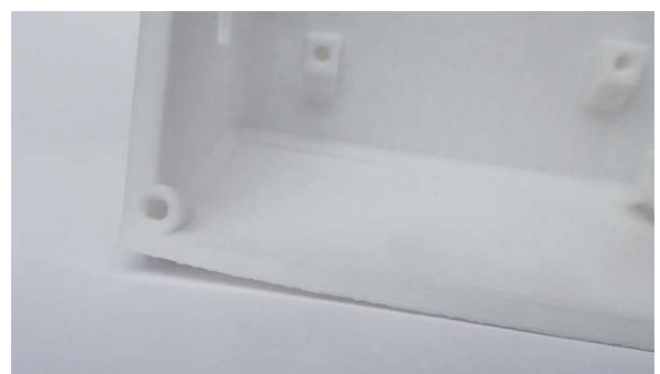
Bild 1: Typisches Warping – durch unterschiedliche Abkühlungseffekte hebt die Grundfläche an einer Ecke ab und verkrümmt sich.
