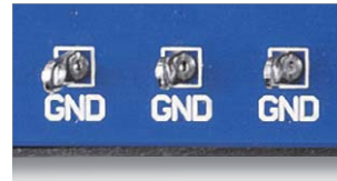
Bild 10: Massepunkte (Lötösen) erlauben den bequemen Anschluss von Messgeräten (GND-Anschluss)
