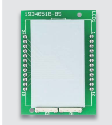
Bild 16: Aufkleben der Reflektorfolie
