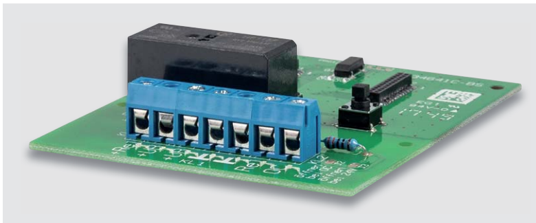
Bild 11: Einlöten der Schraubklemmen
