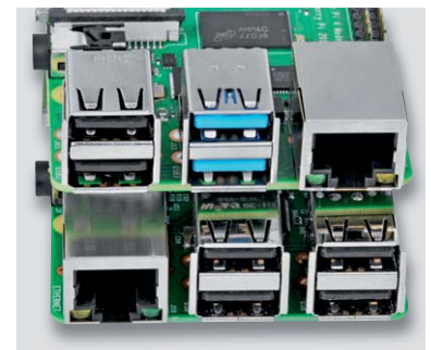
Bild 2: USB-/Ethernet-Anschlüsse beim Raspberry Pi 4 (oben) im Vergleich zum Raspberry Pi 3 (unten)
