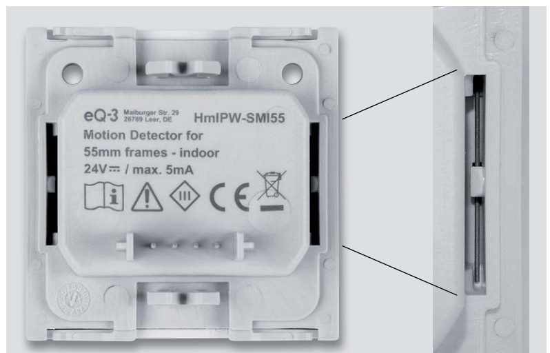
Bild 12: So sind die Federdrähte für die Tasterwippe einzusetzen.
