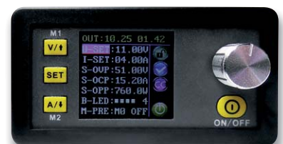
Bild 3: In 10 Datenspeichern können Spannungen, Ströme, Grenzwerte usw. abgespeichert werden, wobei Speicher 0 dem automatischen Wiederaufruf der vor dem letzten Ausschalten eingestellten Daten dient.
