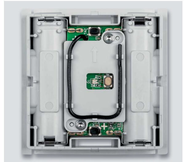
Bild 6: Der Antennenhalter wird mit zwei Schrauben fixiert und die Antenne wie hier gezeigt in die Halterungen eingelegt.
