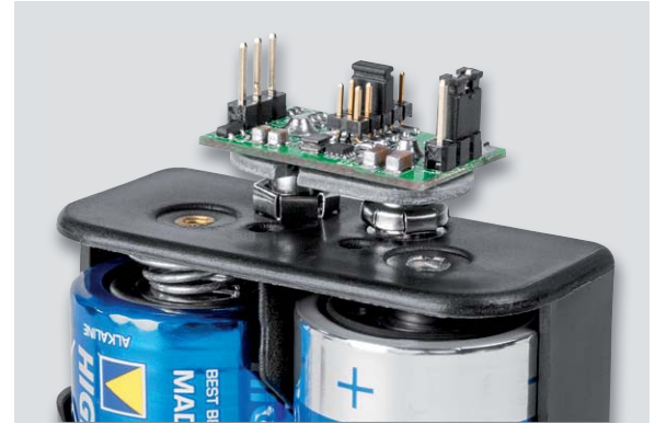
Bild 2: BAP5 aufgesteckt auf einen Batteriehalter
