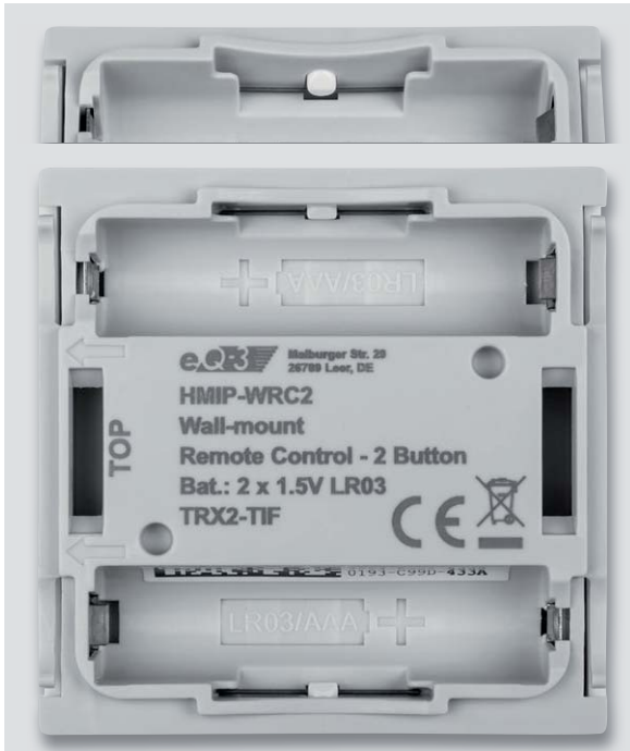
Bild 8: So wie oben zu sehen, wird der Federdraht auf jeder Seite unter den Kunststoffnasen des Gehäuses eingelegt. Unten ist das mit beiden Federdrähten bestückte, einsatzfertige Gerät zu sehen.
