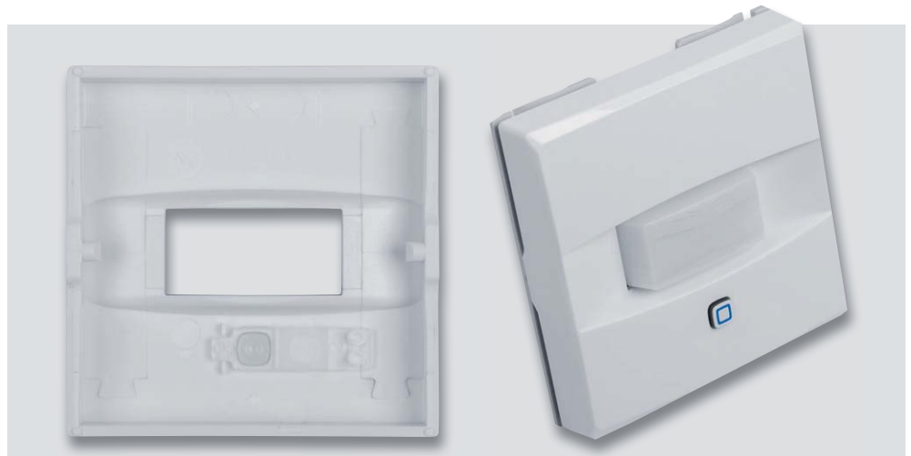
Bild 11: Beim Aufsetzen der Tasterwippe ist auf die richtige Position des Lichtleiters/ Tastenstößels zu achten.
