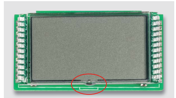
Bild 7: Anhand der Angussnase des Displays wird die richtige Positionierung vorgenommen. Die Nase muss an der Markierung im Bestückungsdruck liegen.
