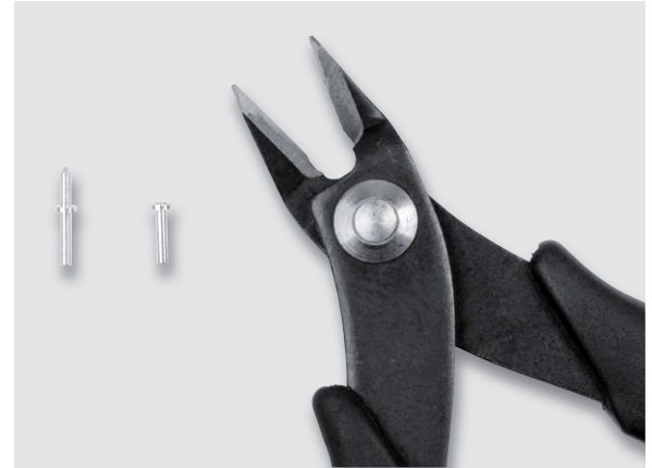
Bild 14: Die spitze Lötseite der Lötstifte wird mit einem Seitenschneider entfernt.
