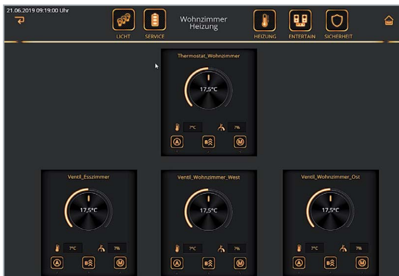
Bild 10: Seite für die Heizkörper
