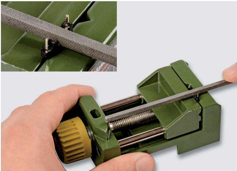
Bild 23: Mit einer Feile wird die Stiftleiste bearbeitet. Dabei ist ein kleiner Schraubstock sehr hilfreich.
