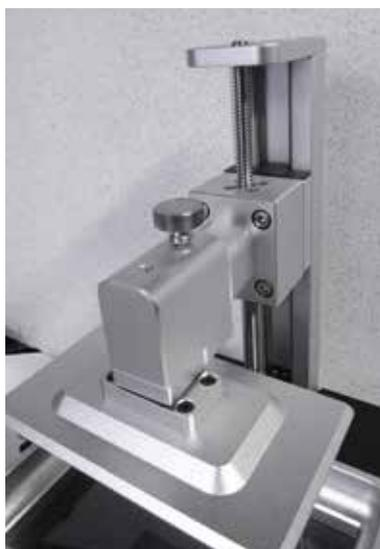
*Bild 7: Das weit verbreitete Konstruktionsprinzip der Aufhängung der Druckplattform, hier am Anet A4: Plattform samt Träger mit einer Rändelschraube auf der Z-Achse fixiert. Die Ausrichtung der Plattform erfolgt halbautomatisch, deren Fixierung über vier Schrauben.*
