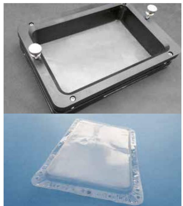
**Bild 10:** Stark verschlissene FEP-Folie – diese Folie muss ausgetauscht werden. Unten ist sie im eingebauten Zustand zu sehen.
