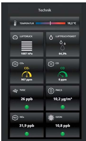
Bild 11: Der in AIO CREATOR NEO integrierte uHoo-Sensor in der Remote-Ansicht
