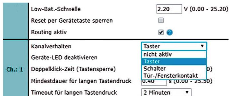
Bild 11: Der Konfigurationsdialog des HmIP-DSD-PCB in der WebUI der CCU
