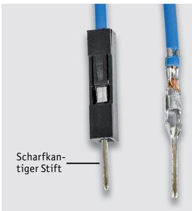
Bild 7: Kabel mit „Dupont“-Stecker
