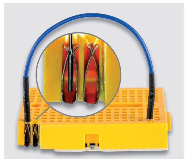
Bild 4: Die Buchsenkontakte eines Steckboards im Detail
