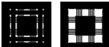
*Bild 5: Drei Teilbilder der gesamten, je nach Objekt bis zu mehreren Zehntausend Schichten umfassenden Druckdatei. Diese werden nacheinander bei jeder neuen Schicht projiziert.*
