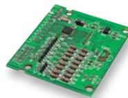
**Antwort** von ELV: Für die Steuerung des 8-Kanal-Sendemoduls HM-MOD-EM-8 können Sie die Ausgänge 2 bis 9 (Stiftleistenkontakte) des IRE8-Fernbedienungsempfängers verwenden. Diese schließen Sie an die Eingänge 24 bis 31 (Stiftleiste ST2) des HM-MOD-EM-8 an. Ferner ist das GND-Potential (Pin 10) des IRE8 mit dem GND-Potential des Sendemoduls (Pin 32) zu verbinden.
