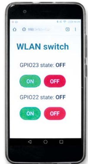
Bild 5: Das Smartphone als Steuerzentrale für den ESP32
