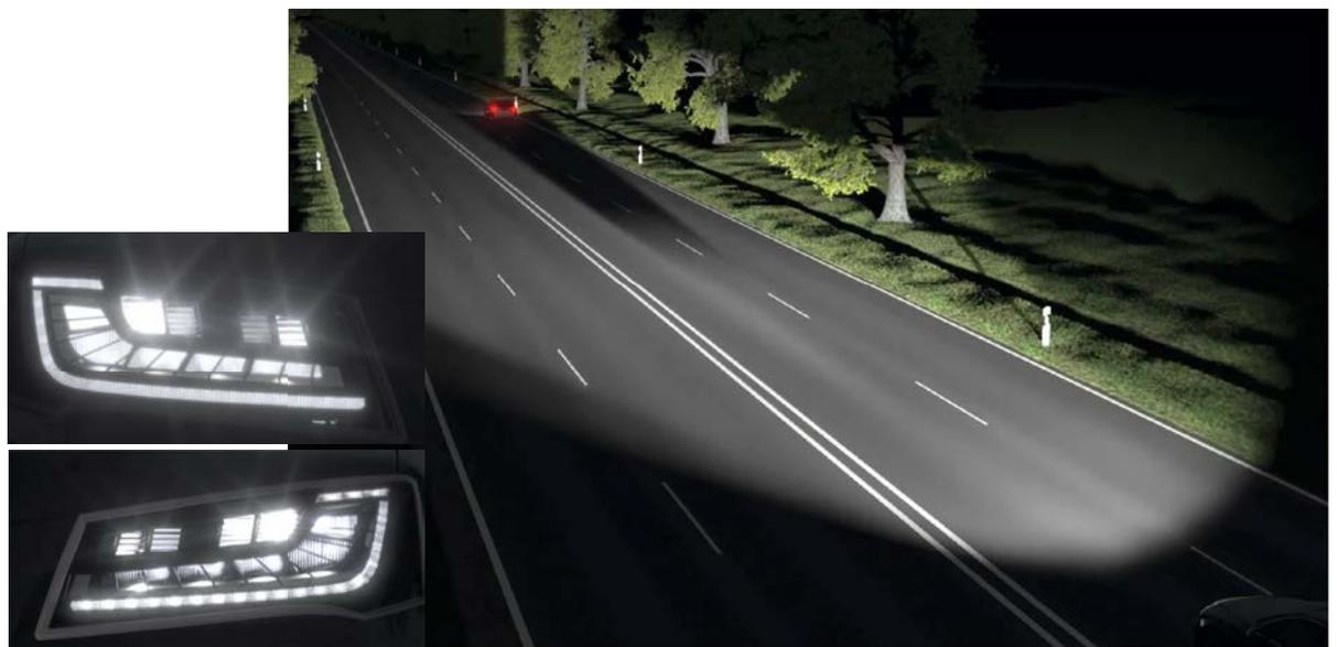
*Bild 10: Erfasst die Kamera die Rückleuchten eines vorausfahrenden Fahrzeugs, wird abgeblendet und die Hell-Dunkel-Grenze hinter dem Vorausfahrer kontinuierlich bei der Annäherung abgesenkt. Bild: HELLA*
