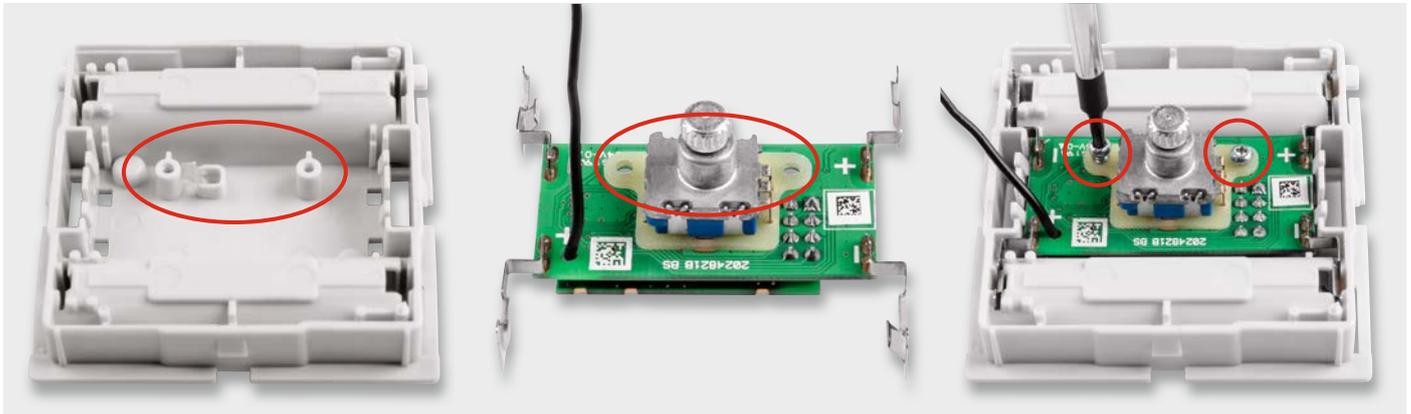
Bild 6: So erfolgt der Einbau der Platine in die Unterschale.
