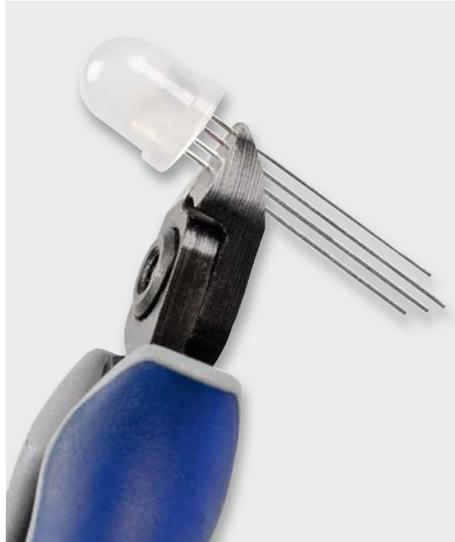
Bild 6: So sind die LED-Anschlüsse der WS2812 zu kürzen.
