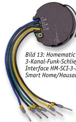
Bild 13: Homematic 3-Kanal-Funk-Schließerkontakt-Interface HM-SCI-3-FM für Smart Home/Hausautomation
