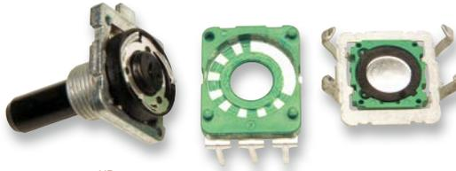
*Der Aufbau eines mechanischen Inkrementalgebers*
