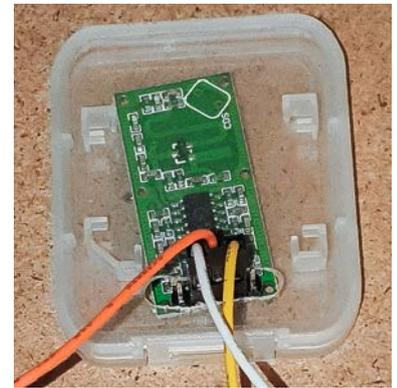
Bild 8: Radarmodule
