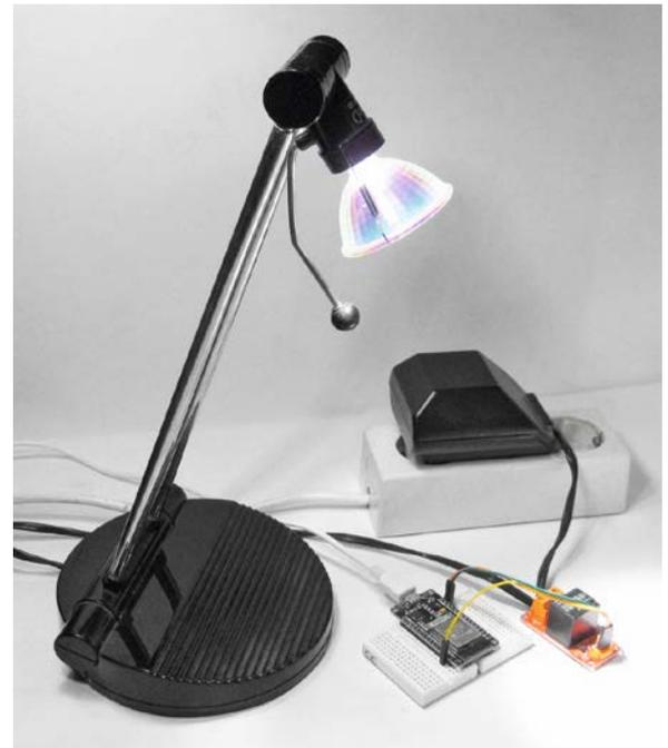
Bild 4: Schalten einer 12-V-Halogenlampe via ESP32 und Relaismodul
