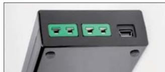
Zwei Anschlüsse für externe K-Type-Sensoren und ein Micro-USB-Anschluss für die Datenübertragung
