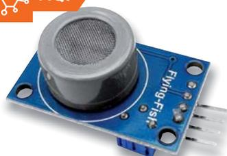
Bild 7: Der CO-Sensor MQ7 mit Anschlussbelegung des Breakout-Boards
