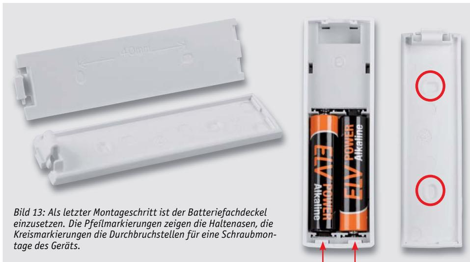
Bild 13: Als letzter Montageschritt ist der Batteriefachdeckel einzusetzen. Die Pfeilmarkierungen zeigen die Haltenasen, die Kreismarkierungen die Durchbruchstellen für eine Schraubmontage des Geräts.
