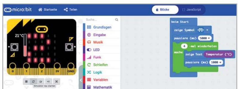
Bild 7: Ein einfaches Programm, hier für den Abruf der Temperatur des bordeigenen Temperatursensors, ist schnell erstellt und simuliert.
