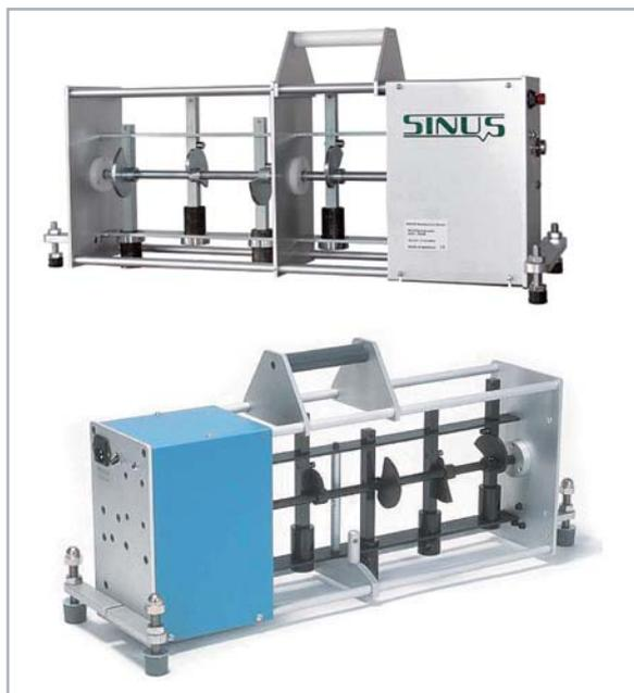
Bild 11: Norm-Trittschallhammerwerk (zwei Ausführungsbeispiele)
