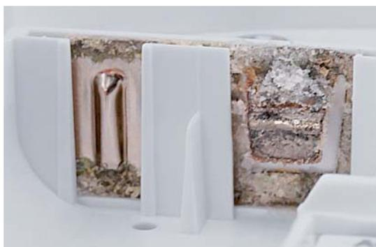
Bild 12: Kaliumcarbonat-Ablagerungen am Batteriekontakt
