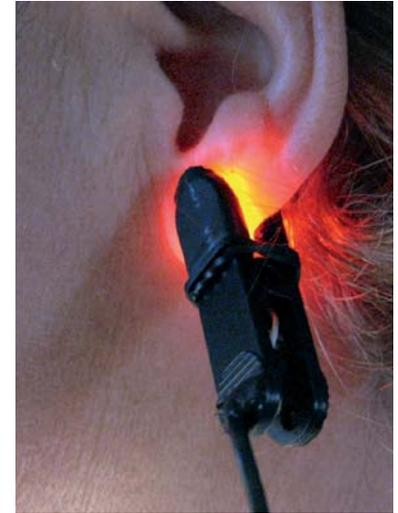
Bild 7: Pulssensor am Ohr
