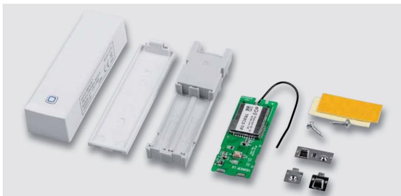
Bild 4: Der komplette Lieferumfang des Bausatzes inklusive Befestigungsmaterial
