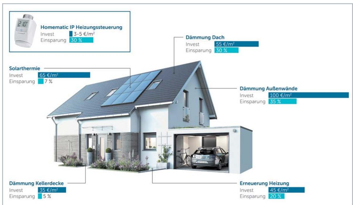
Bild 3: Einsparpotenziale am Beispiel eines Einzelhauses
