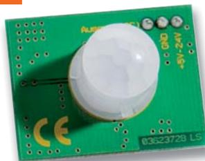
Bild 20: Der PIR-Sensor PIR13 von ELV
