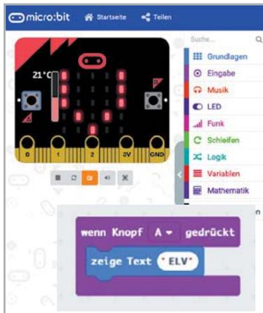
Bild 8: Hier wird auf eine Eingabe hin ein Text ausgegeben.
