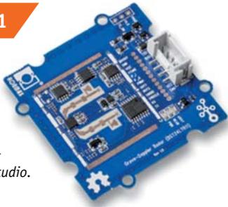
Bild 18: Der Radarsensor BGT24LTR11 von SeeedStudio.
