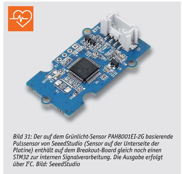
Bild 31: Der auf dem Grünlicht-Sensor PAH8001EI-2G basierende Pulssensor von SeeedStudio (Sensor auf der Unterseite der Platine) enthält auf dem Breakout-Board gleich noch einen STM32 zur internen Signalverarbeitung. Die Ausgabe erfolgt über I<sup>2</sup>C. Bild: SeeedStudio
