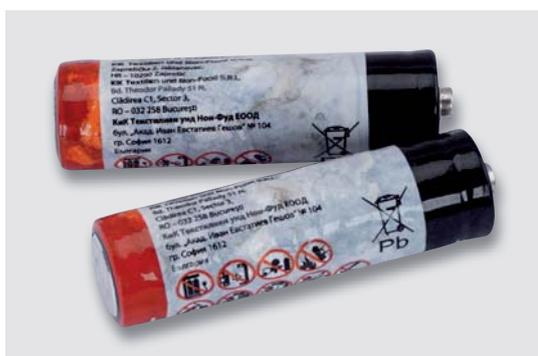
Bild 13: Typische Gehäusekorrosion von Zink-Kohle-Batterien
