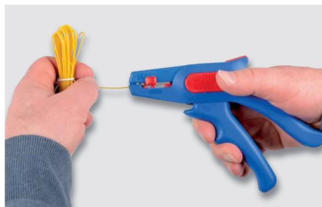
Bild 14: Abisolierzange
