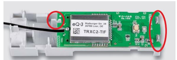
Bild 8: Die mit den Batteriekontakten voran in das Gehäuseunterteil eingesetzte Platine
