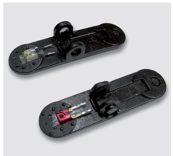
Bild 5: Im Eigenbau hergestellter Pulssensor
