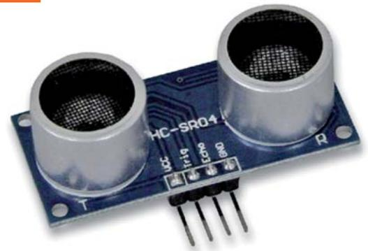
Bild 17: Der Ultraschallsensor HC-SR04
