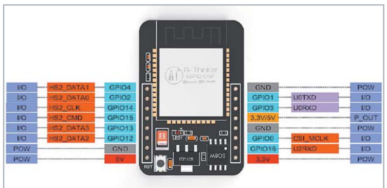
Bild 4: Die Anschlussbelegung des ESP32-CAM. Bild: AI Thinker
