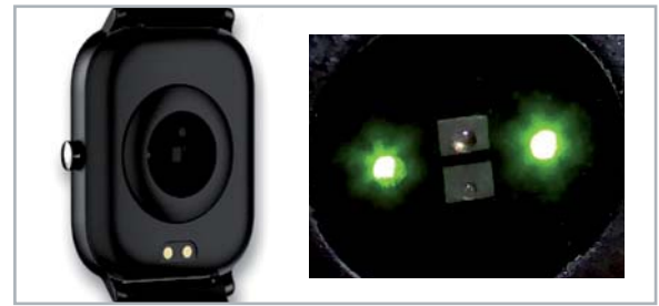
Bild 9: Der Kombisensor auf der Rückseite der Uhr. Für Messungen am Handgelenk hat sich schmalbandiges grünes Licht bewährt.
