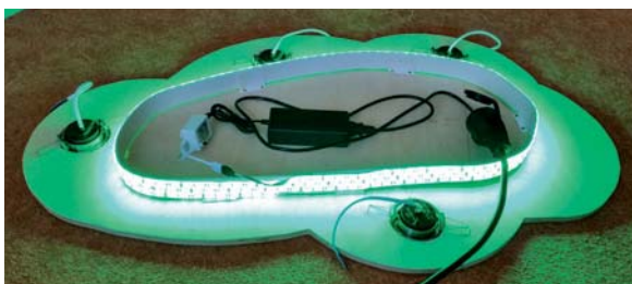
Erster Test mit LED-Stripe
