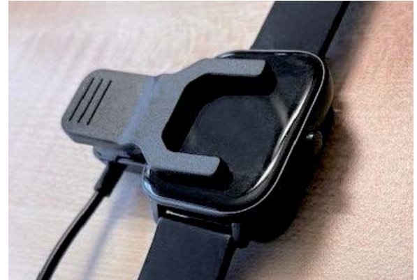
Bild 2: Das Laden erfolgt über zwei Ladekontakte an der Uhr in einer speziellen Ladehalterung.
