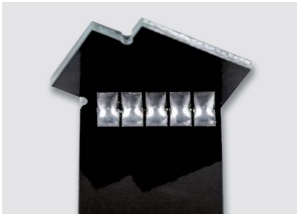
Bild 11: Innenseite der verlötete Abdeckkappe
