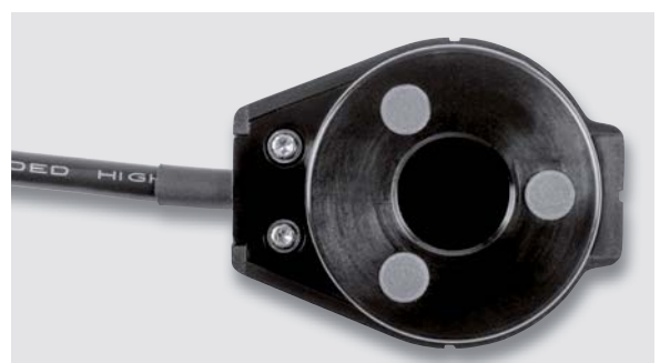
Bild 12: Als letzter Schritt erfolgt das Einkleben der drei GummifüÙe in das Gehäuse.
