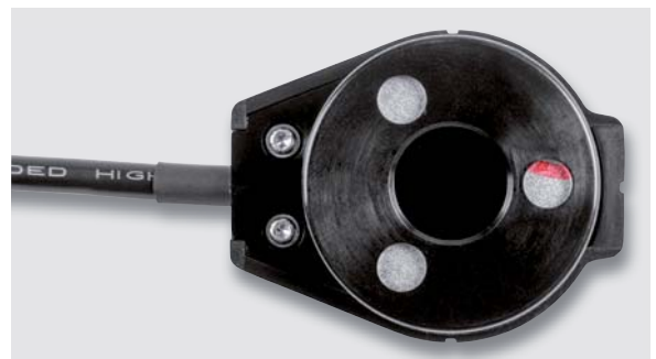
Bild 11: Hier ist der auf die GummifüÙe aufgelegte Magnet durch das verschlossene sowie verschraubte Gehäuse zu sehen.
