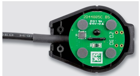
Bild 10: So ist die Platine in das Gehäuse einzulegen, anschließend werden die vier GummifüÙe aufgeklebt.
