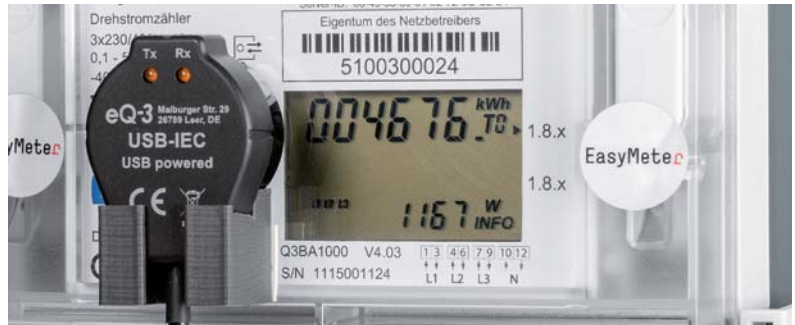
Bild 13: Der in einen im 3D-Druck hergestellten Halter eingesetzte USB-IEC an einem EasyMeter Q3B
