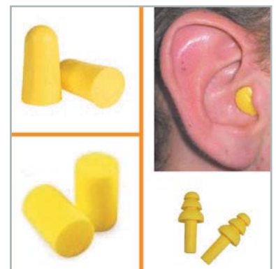
Bild 2: Beispiele für Gehörschutzstöpsel und deren Einsatz im äußeren Gehörgang. Die beiden Ausführungen auf der linken Bildseite (oben und unten) bestehen aus ganz bestimmtem Schaumstoff, den man in zusammengedrückter Form in den Gehörgang einführt, wo er sich nach kurzer Zeit wieder ausdehnt und sich so der Kontur des Gehörganges optimal anpasst.
