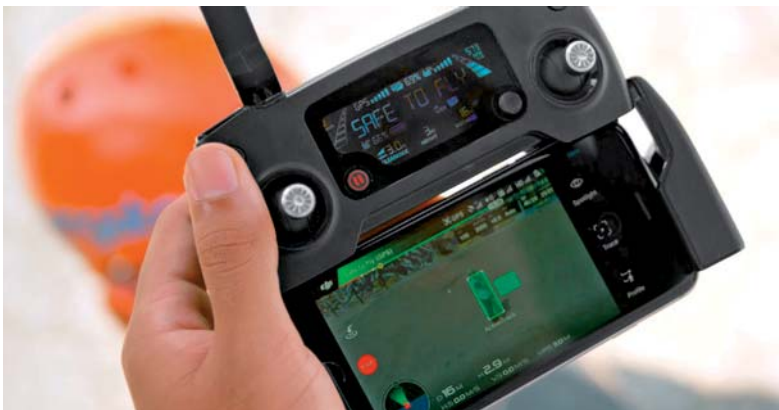
Bild 15: Das Ziel fest im Blick und hinterher! Im Active-Track-Modus verfolgt die Drohne selbstständig ein zuvor per Kamera fixiertes Ziel. Bild: DJI
