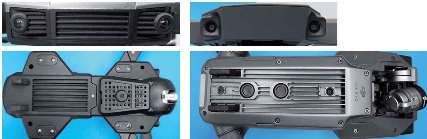
Bild 27: Komplette Sensorausstattung für Hinderniserkennung und Orientierung oder einfacher Distanzsensor – auch darin unterscheiden sich die Drohnenklassen. Links eine einfach ausgestattete Drohne der 250-Euro-Preisklasse, diese trägt an der Front nur LEDs. Rechts die Sensoren der Mavic Pro. Hier gibt es zusätzlich Sensoren für die Hinderniserkennung nach vorn.
