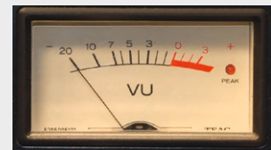
Ein analoges VU-Meter, hier bereits mit einem separaten LED-Indikator (Quelle: Wikipedia)
