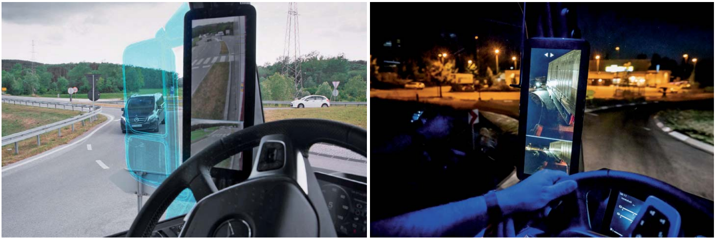
Bild 18: Der Kamera-Außenspiegel eliminiert großflächige Spiegelanbauten, der Fahrer hat mehr Sicht. Infrarot-Scheinwerfer erleichtern die Sicht bei Nacht. Bilder: Daimler
