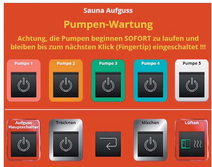
Bild 14: Pop-up für die Pumpenwartung
