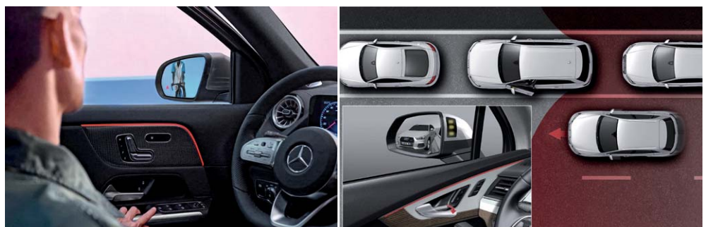
Bild 14: Der Ausstiegswarner warnt auch im Stand, wenn sich jemand beim Öffnen der Tür im toten Winkel befindet. Bilder: Daimler/Audi
