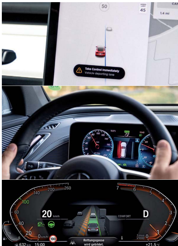
Bild 11: Lenkassistenten gibt es in verschiedenen Ausbaustufen, von der Spurverlassenswarnung bis zum aktiven Spurwechselassistenten. Das Bild unten zeigt, dass auch externe Warnungen hier einfließen können. Bilder: Tesla/Daimler/BMW
