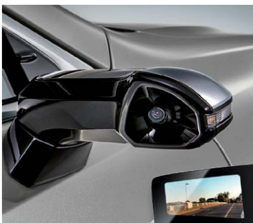
Bild 16: Kamerasysteme statt Außenspiegel findet man bei Pkws noch nicht allzu oft, das ist auch eine optische Frage. Wie man dies lösen kann, zeigt z. B. Toyota (links). Rechts eine Displaystudie zum Thema von Continental. Bilder: Toyota/Continental
