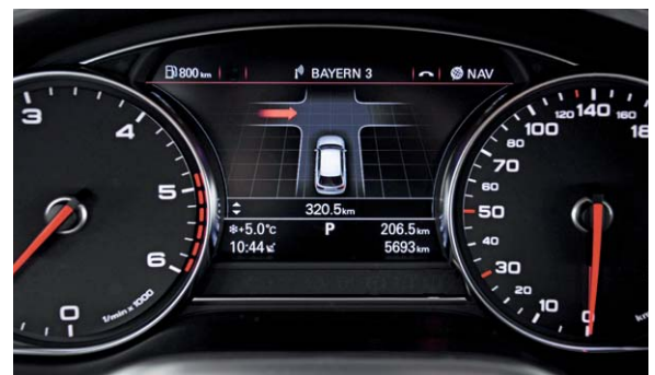
Bild 19: Der Querverkehrswarner warnt z. B. an unübersichtlichen Ausfahrten oder Einmündungen. Bild: Audi
