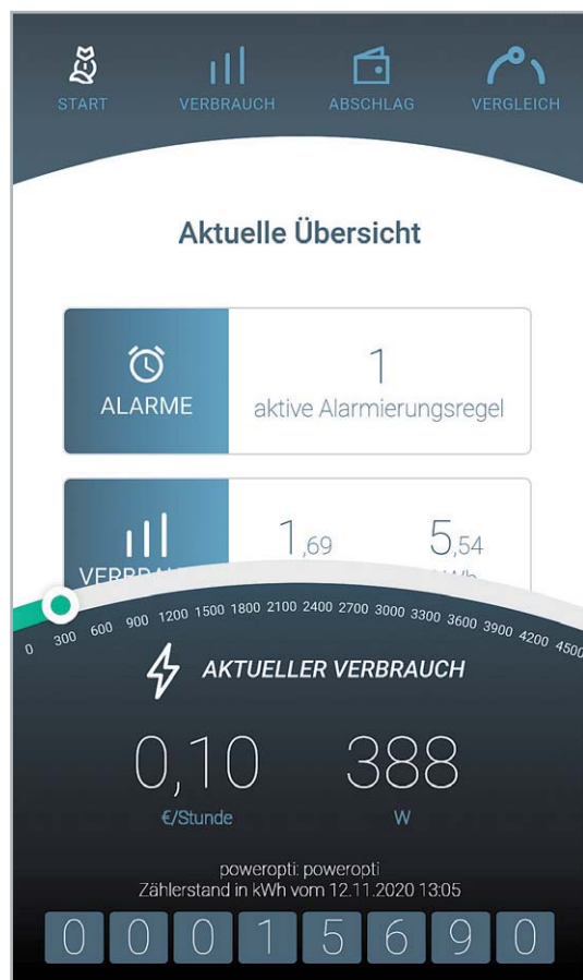
Bild 5: Anzeige der Leistungswerte und des Zählerstandes
