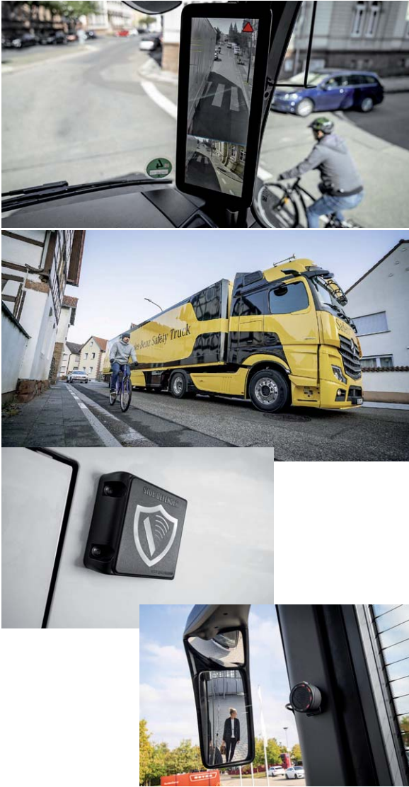
Bild 15: Vermeidet schwere Abbiegeunfälle – der kamerabasierte Totwinkelwarner für Nutzfahrzeuge, oben serienmäßiger Einbau, unten als Nachrüstsystem. Bilder: Daimler
