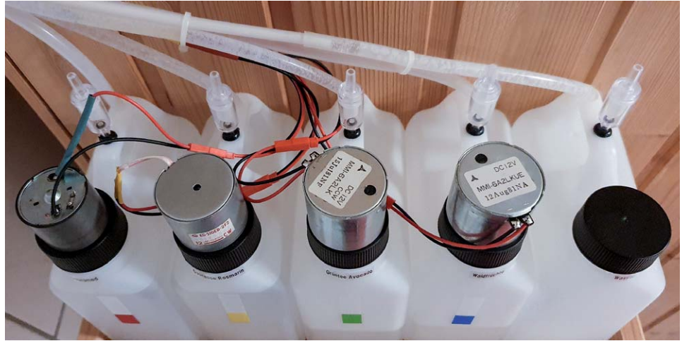
Bild 4: Detailansicht der Kanister mit Motoren und Schlauchzuführung
