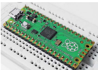
Bild 2: Auf einem Breadboard lassen sich die Headerleisten am besten einsetzen und verlöten. Rechts die Beschriftung der Anschlüsse auf der Unterseite des RPi Pico.
