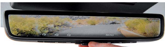
Bild 17: Die Heckkamera statt Innenrückspiegel kann viele Sichtbehinderungen beseitigen, hier beim Nissan Armada. Bild: Nissan
