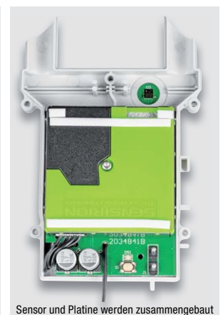
Sensor und Platine werden zusammengesetzt
