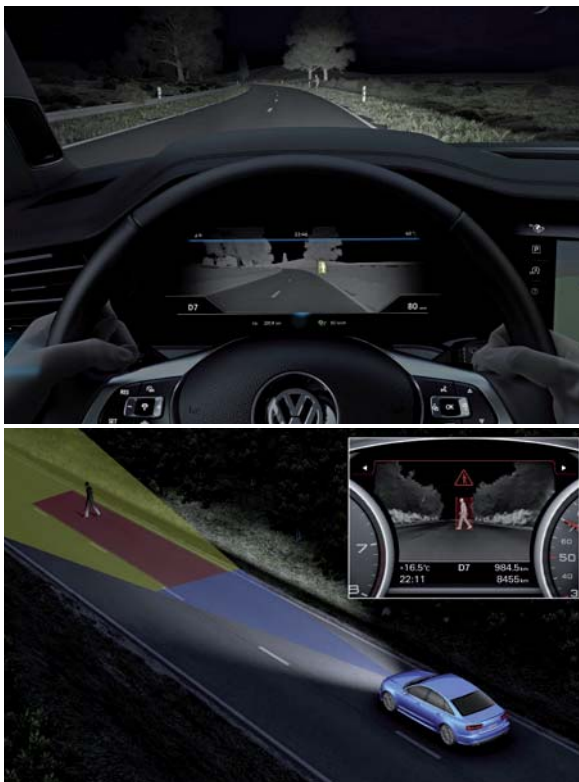
Bild 4: Nachtsichtsysteme ermöglichen die sichere Erfassung z. B. von Personen bei Dunkelheit und in größerer Entfernung. Bilder: VW/Audi
