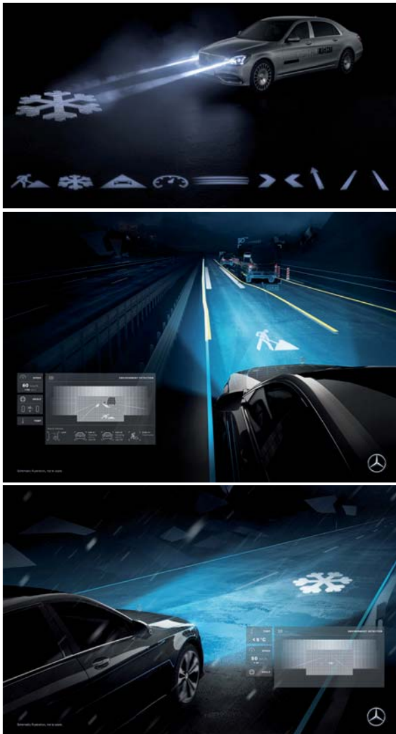
Bild 3: Die HD-Pixel-Technologie von Daimler erlaubt das Projizieren von Warnsymbolen auf die Fahrbahn. Bilder: Daimler
