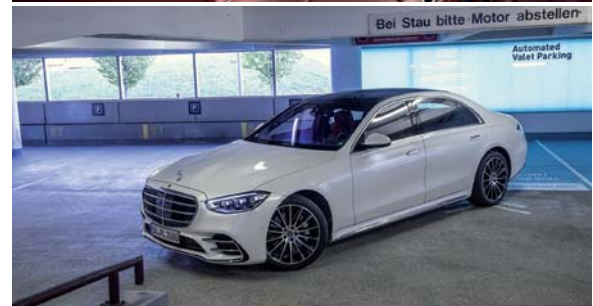
Bild 10: Die Mercedes S-Klasse sucht sich im Dialog mit der Parkhaus-Infrastruktur autonom eine freie Parklücke. Bilder: Daimler
