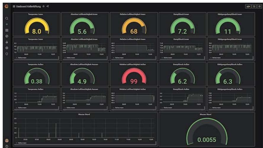
Bild 2: Ein mit Grafana erstelltes Dashboard zeigt die Daten der Datenbank in Echtzeit sowie in Langzeitdiagrammen an. Dieses Tool öffnet auch die weltweite Kontrollmöglichkeit per Internet.
