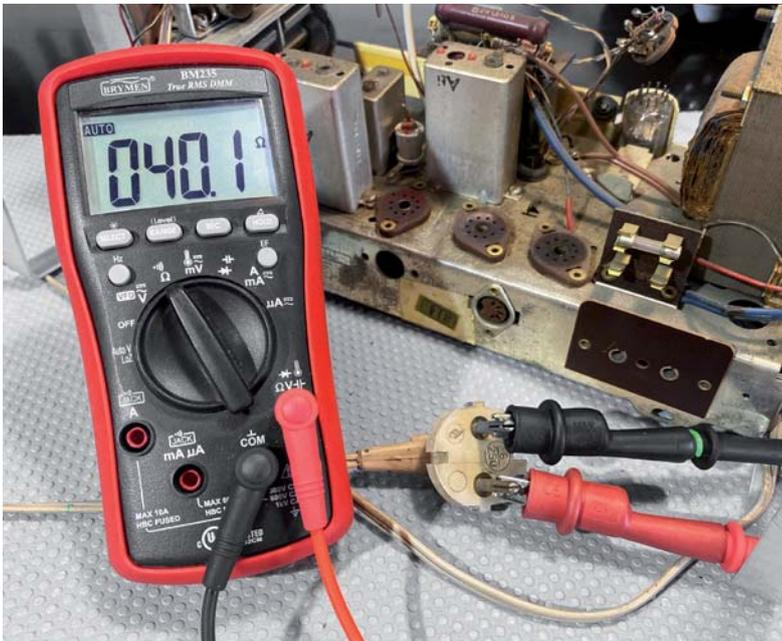
Bild 8: Messung des Widerstands des Netzprimärkreises
