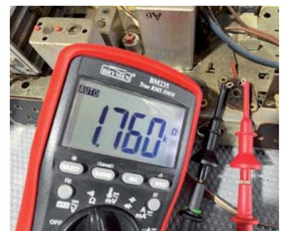
Bild 12: Messung des DC-Widerstands des Primärkreises des Ausgangstransformators
