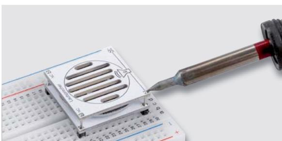
Bild 37: So werden zum Schluss die Stifte auf der Platinenoberseite angelötet.
