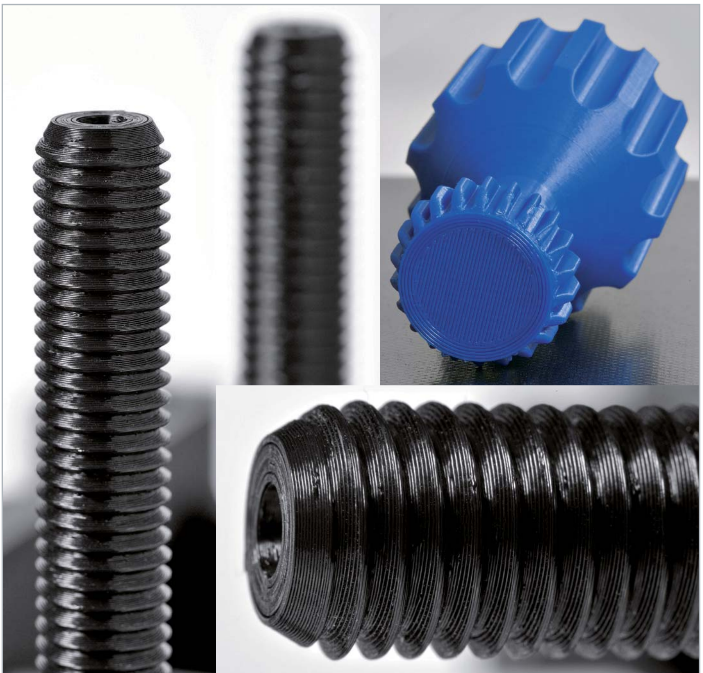
Bild 18: Die Einzelteile wurden mit einer Schichthöhe von 0,12 mm gedruckt. Das Ergebnis ist mehr als zufriedenstellend.
