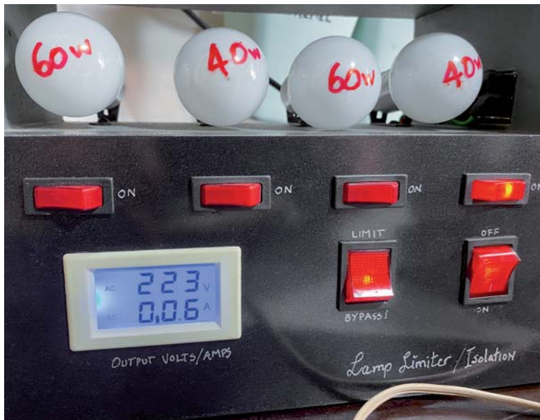
Bild 7: Der Glühlampen-Begrenzer zeigt eine sehr geringe Stromaufnahme an.
