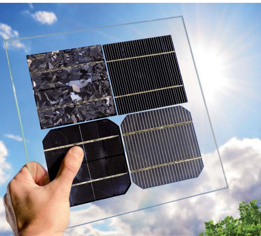
Bild 2: Im Aussehen gut zu unterscheiden: Links oben eine polykristalline Zelle, die monokristallinen Zellen sind in unterschiedlichen Färbungen und Strukturen verfügbar.
