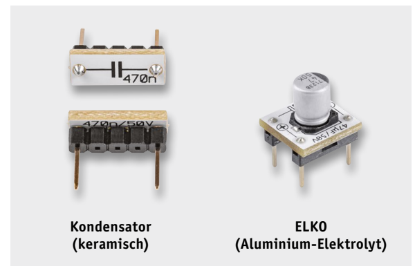
Bild 7: Unterschied zwischen keramischen Kondensatoren und ELKOs
