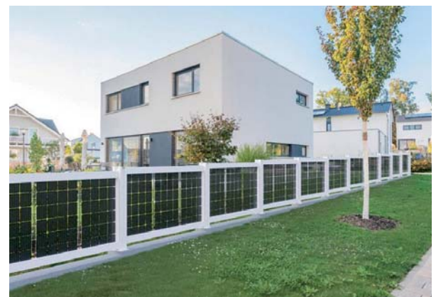
Bild 14: Der bifaciale Solarzaun wird in verschiedenen Zaunfeldformen angeboten. So kann man damit auch das Grundstück umfrieren. Bilder: Next2Sun/solarcarport [7]
