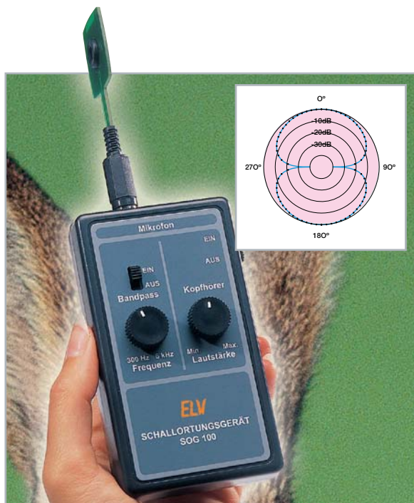
Bild 15: Schallortungsgerät SOG 100 (ELVjournal 4/2003, S. 61–67), ausgerüstet mit einem Gradientenmikrofon, das dank seiner völlig symmetrischen Achtercharakteristik Geräuschquellen sehr genau orten kann, und zwar durch Minimumpeilung von zwei verschiedenen Orten aus.
