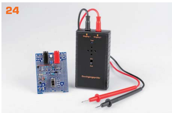
24 Durchgangsprüfer selbst gebaut
