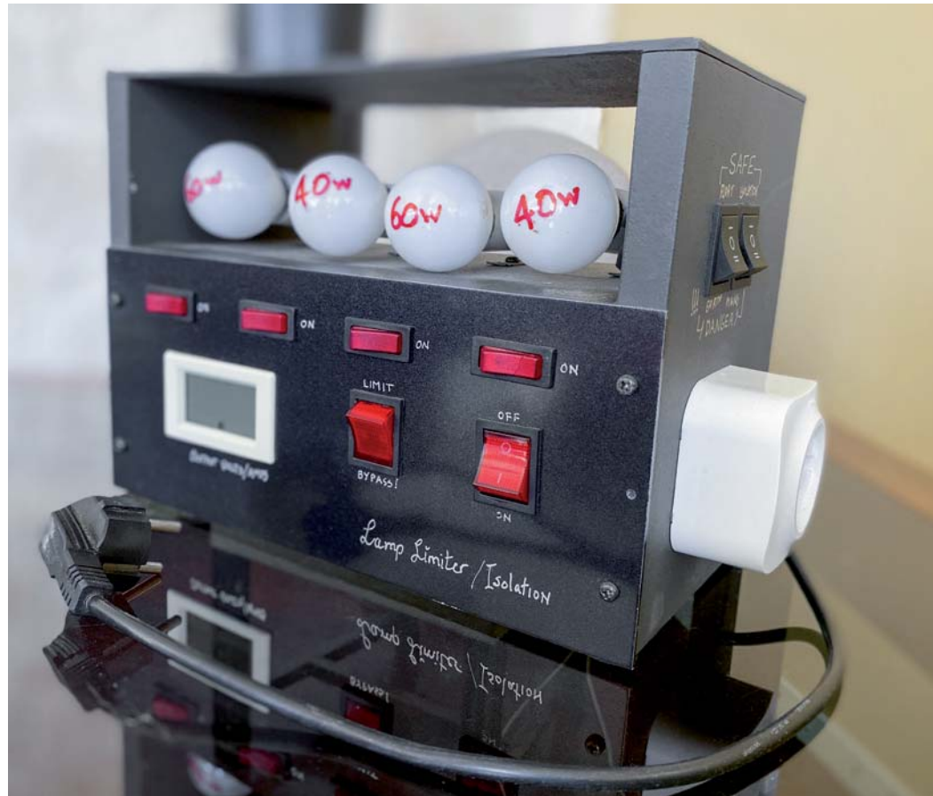
Bild 4: DIY-Trenntransformator und Glühlampen-Begrenzer. Er hat einen ON-/OFF-Hauptschalter, einen LIMIT-/BYPASS-Schalter und ermöglicht außerdem das Zuschalten verschiedener Glühlampen, um den Strom zu begrenzen. Zwei 40- und zwei 60-W-Glühlampen ermöglichen eine große Kombination von zuschaltbaren Lampen-Leistungstufen (40-60-80-100-120-140-160-200 W). Außerdem hat das Gerät zwei Schalter an der Seite, die es ermöglichen, die Netzerde hinzu- oder wegzuschalten sowie den Isolationstransformator komplett zu überbrücken. Ein digitales Messgerät zeigt den aufgenommenen Strom und die Spannung, die tatsächlich an die Last (das Radio) weitergeleitet wird. Ich verwende normalerweise nur dieses Gerät, ohne einen Spartransformator, mit sehr guten Ergebnissen.
