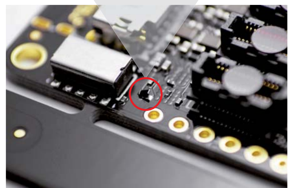
Bild 12: Tombstone-Effekt bei SMD-Bauteilen
