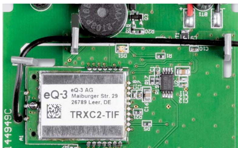
Bild 11: Die Verlegung der Antenne
