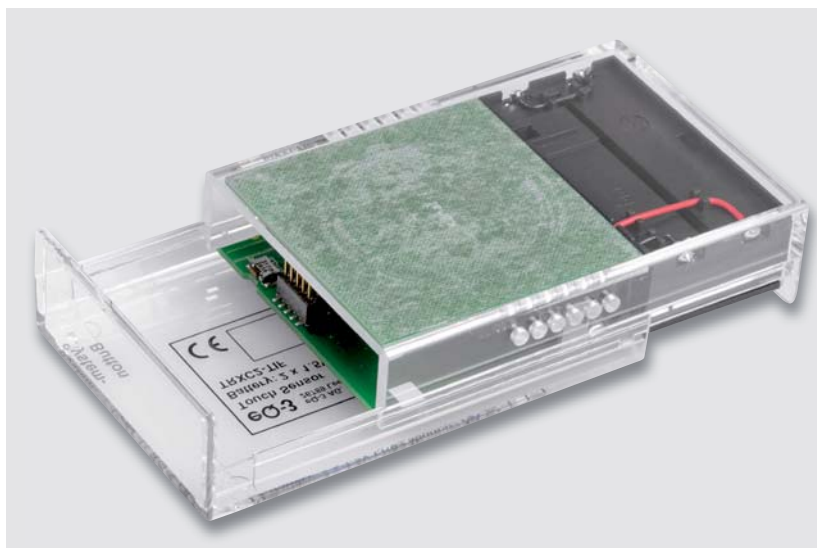
Bild 1: HmIP-STI im transparenten Schiebegehäuse
