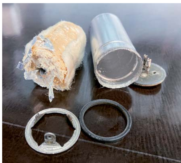
Bild 4: Der entfernte Teil des alten Kondensators
