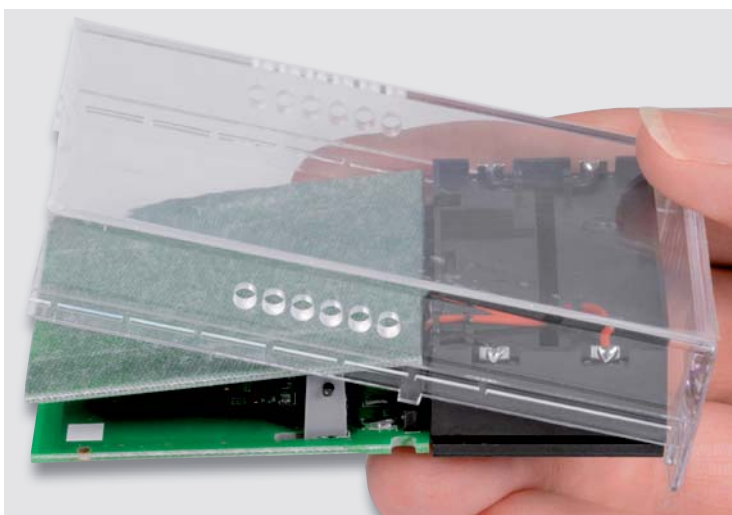
Bild 16: So erfolgt das erste Einsetzen der Platinen in die Gehäuseoberschale.
