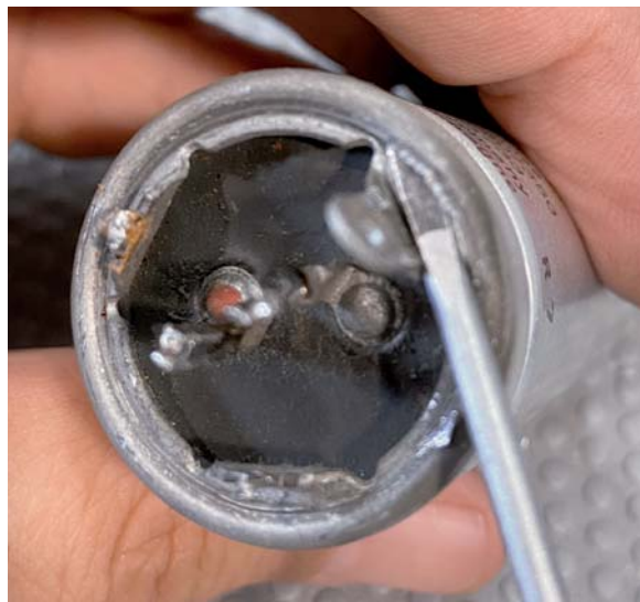
Bild 3: Anheben der Ummantlung vom Sockel
