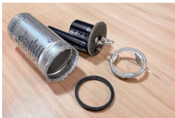
Bild 5: Mit neuen Kondensatoren bestückter Metallbecher
