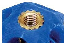
Bild 9: Ist für geringere mechanische Beanspruchung geeignet – kalt eingepresster M2-Ruthex-Gewindeeinsatz
