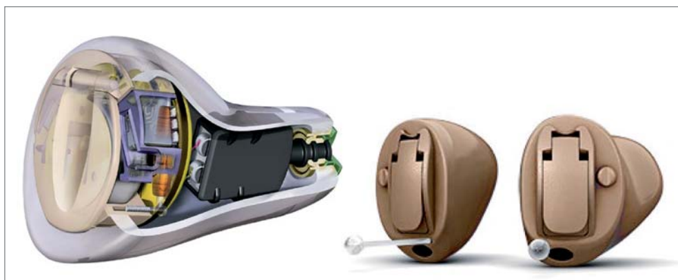
Bild 8: Im-Ohr-Hörgeräte. Im linken Bild erkennt man rechts innerhalb des Gehäuses den Hörer in Neopren-Taschen. Links unterhalb des Deckels befindet sich die Batterie. Zwischen Hörer und Batterie liegt die Verstärkerplatine. Rechtes Bild: Tief im Gehörgang sitzende Geräte.
