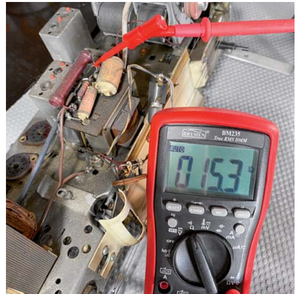
Bild 9: Der Widerstand zwischen dem Punkt A und einem der Beine des Widerstands beträgt 15,3 Ω.
