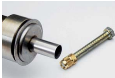
Bild 11: Alternative zur Erwärmung per Lötkolben – Heißluftgerät und Einsetzen mit Bolzen. Beachtet man die mit den Gewindeeinsätzen mitgelieferten Herstellervorgaben für die Einsatzlöcher, gelingt das Einsetzen dank der Führungen sehr gut. Mit passenden Bolzen/Schrauben kann man die genau senkrechte Lage kontrollieren.
