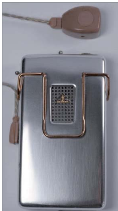
Bild 6: Taschen-Hörgerät mit ansteckbarem Außenhörer und zwei Übertragern im Inneren, schon mit Gegentakt-Endstufe, Typ 324 Super von Siemens-Reiniger, Erlangen.
