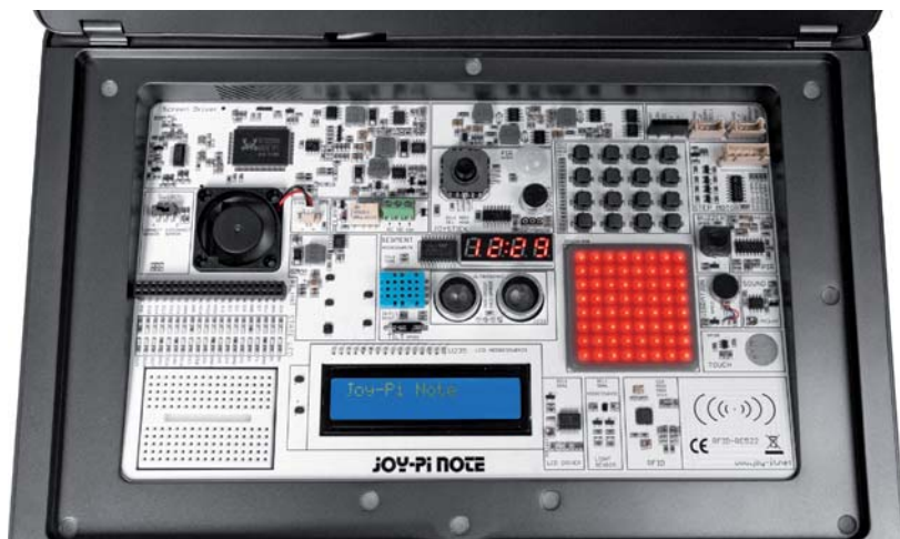
Bild 2: Im Joy-Pi Note sind alle Komponenten fest eingebaut und verkabelt.
