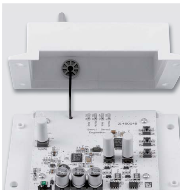
Bild 16: Einführen der Drahtantenne in die Gummiantenne
