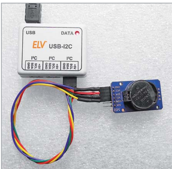
Bild 16: Das ELV USB-I 2 C-Interface ist ein universell einsetzbares Werkzeug für die Entwicklung, das Testen und Experimentieren. Hier ist eine DS3231-RTC angeschlossen.
