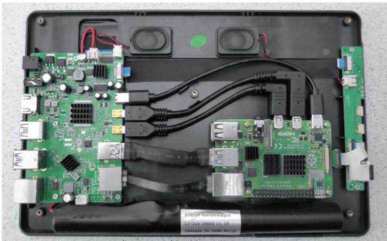
Bild 3: Ein Blick in das Innere des fertig aufgebauten RasPad 3, unten ist der Akku zu sehen
