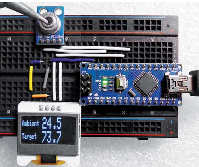
Bild 7: Eine typische, kleine Mikrocontroller-Applikation mit einem Arduino Nano als Master, einem Infrarot-Temperatursensor MLX90614 und einem OLED-Display als Slaves am I 2 C-Bus
