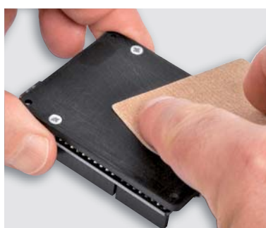
Bild 18: Die Oberfläche der Acrylplatte muss mit Schleifpapier aufgeraut werden.
