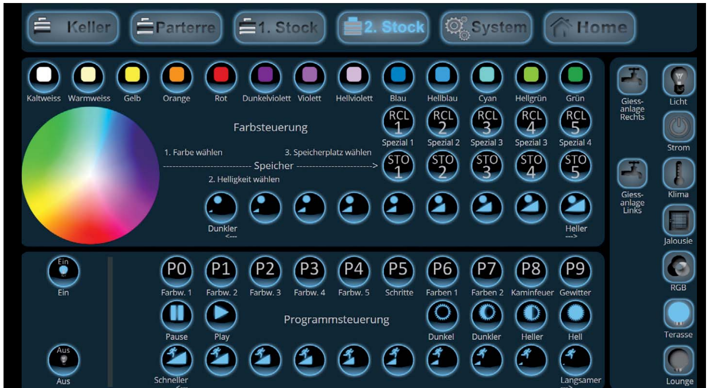
Bild 15: Bedienseite Gartenbeleuchtung über AIO Creator NEO
