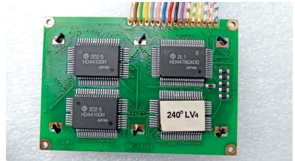
Bild 7: Mehrzeiliges LC-Display mit HD44780-Controller und zusätzlichen Zeilentreibern
