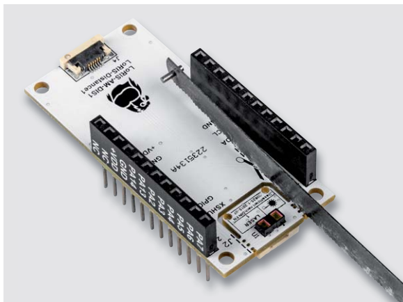
Bild 8: Mit einem kleinen Sägeblatt lässt sich die Ausbrechplatte gut heraustrennen.
