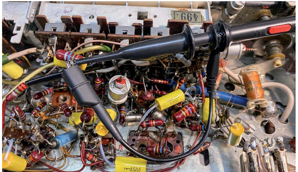
Bild 13: Kurzgeschlossener Tastkopf am Oszillatorteil des Radios
