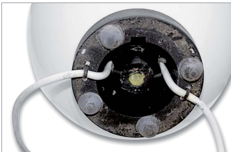
Bild 13: Anschlussleitungen und Zugentlastung
