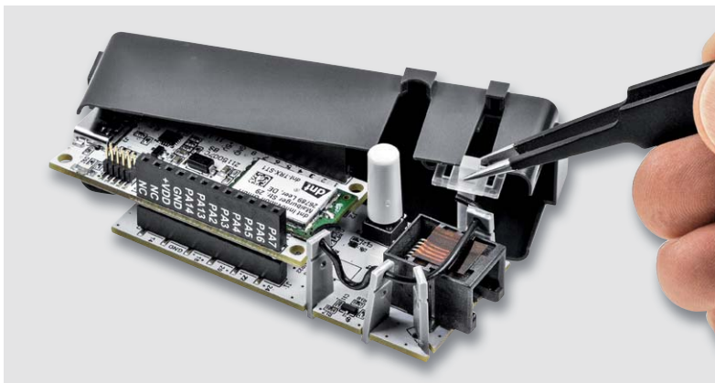
Bild 15: Montage der Gehäuseinnenschale und Einsetzen des Lichtleiters
