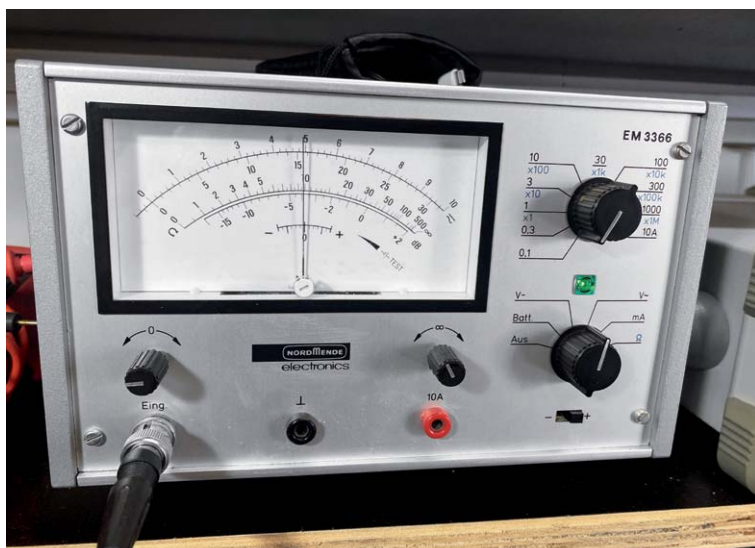
Bild 13: Für den Abgleich eignet sich ein analoges AC-Voltmeter sehr gut.
