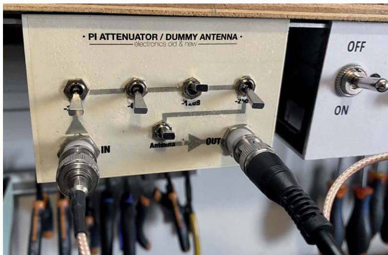
Bild 12: DIY-Dämpfungsglied zur Reduzierung der Signalamplitude
