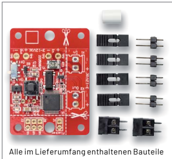
Alle im Lieferumfang enthaltenen Bauteile
