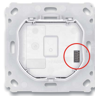
Bild 10: Ausrichten der Relaisplatine. Die Buchsenkontakte müssen genau auf die Steckerleiste der Controllerplatine aufgesetzt werden.
