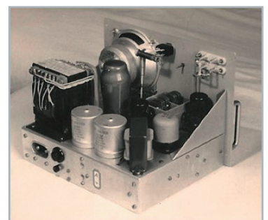
Bild 6: Zweikreis-Kurzwellenempfänger für das 20-m-Band [1]. Links: Vorderansicht, rechts: Blick auf das Innere des Geräts, auf das Chassis ohne Gehäuse. Direkt vor der Röhre 2 (EF 11) erkennt man den Doppel-Drehkondensator. Das dazugehörige Schaltbild zeigt das Bild 7.
