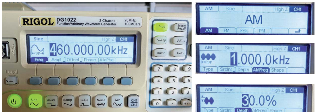
Bild 10: Wir übertragen eine 460-kHz-Trägerwelle, 30 % amplitudenmoduliert (AM) mit einem hörbaren Ton (1 kHz).
