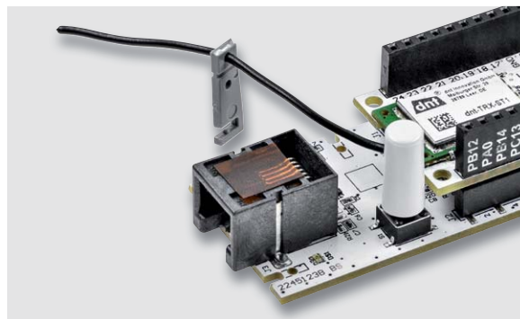
Bild 12: Die Antennenhalter werden einzeln aufgefädelt und eingesetzt.
