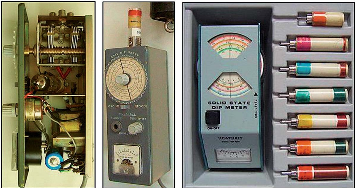
Bild 11: Praktische Ausführungen von Grid-Dipmetern. Weitere Geräte dieser Art gab es von Grundig, RFT und vielen anderen Herstellern – alles Röhrengeräte. Das Gerät hier rechts außen stammt z. B. von Heathkit, mit sieben Steckspulen. Beim Gerät im Bild links außen erkennt man die Elektronenröhre im Zentrum des Chassis und den Doppel-Drehkondensator, der in der Mitte elektrisch an Masse liegt, siehe dazu auch Bild 10.
