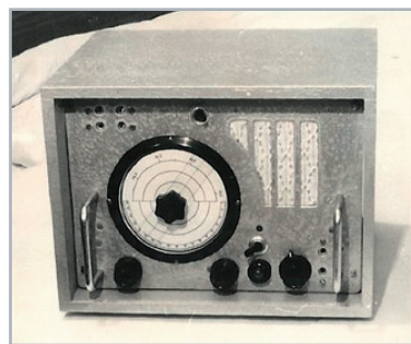
Bild 6: Zweikreis-Kurzwellenempfänger für das 20-m-Band [1]. Links: Vorderansicht, rechts: Blick auf das Innere des Geräts, auf das Chassis ohne Gehäuse. Direkt vor der Röhre 2 (EF 11) erkennt man den Doppel-Drehkondensator. Das dazugehörige Schaltbild zeigt das Bild 7.
