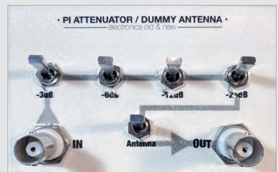
Bild 8: DIY-Pi-Dämpfungsglied
