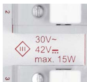
Bild 8: Auf der Platine sind die max. zulässigen Werte für die Ein- und Ausgangsspannung sowie die der Leistung angegeben.
