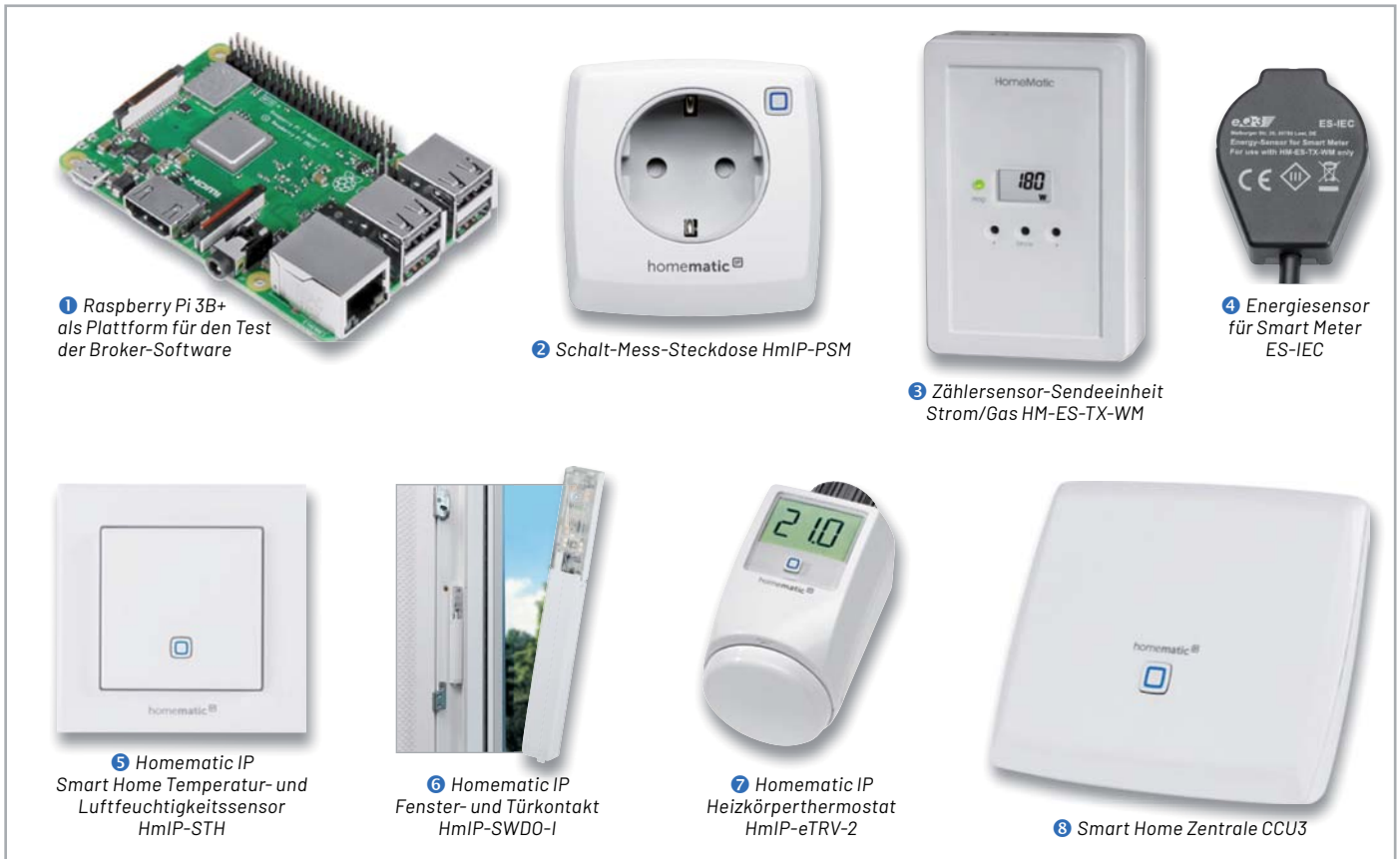
Bild 1: Überblick über alle Hardware-Komponenten für die Haussteuerungslösung
