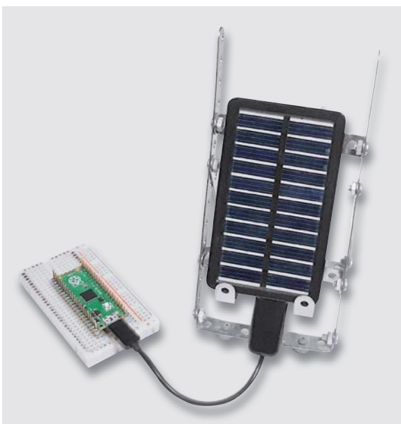
Bild 13: Autarker Datenlogger mit Solar-Powerbank
