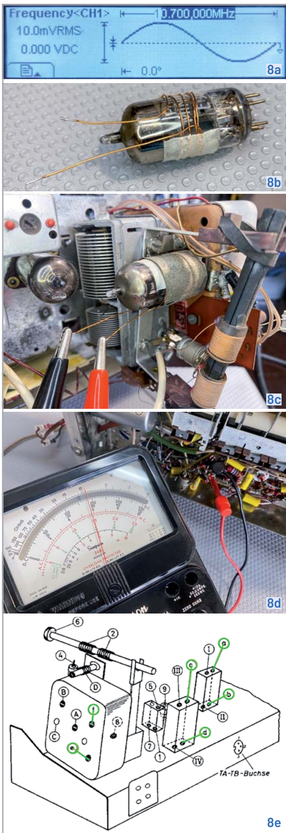
Bild 8: Die verschiedenen Schritte des UKW-ZF-Abgleichs mit Angabe der jeweiligen Kerne
