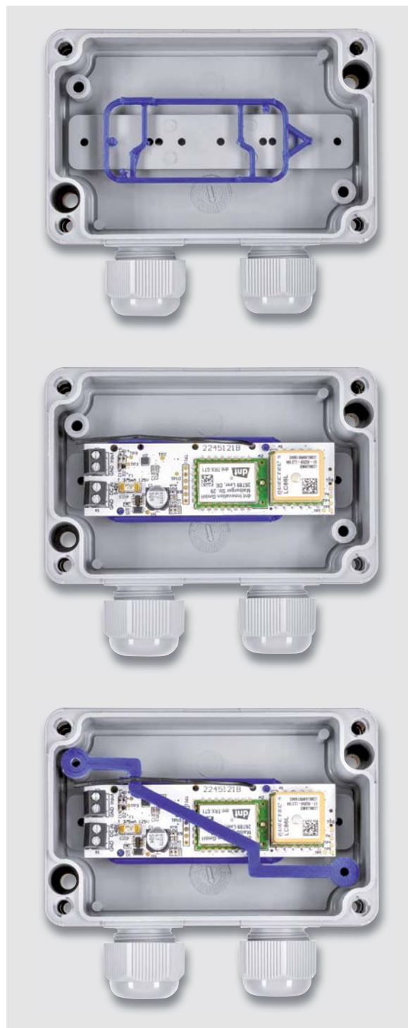
Bild 8: Einbau in ein Bopla-Gehäuse mithilfe der 3D-gedruckten Befestigungsteile
