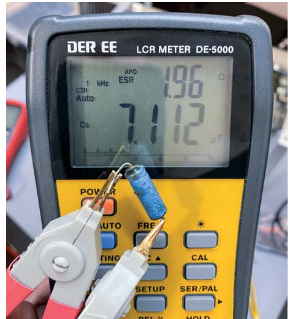
Bild 5: Die gemessenen Werte des ausgetauschten Diskriminator-kondensators
