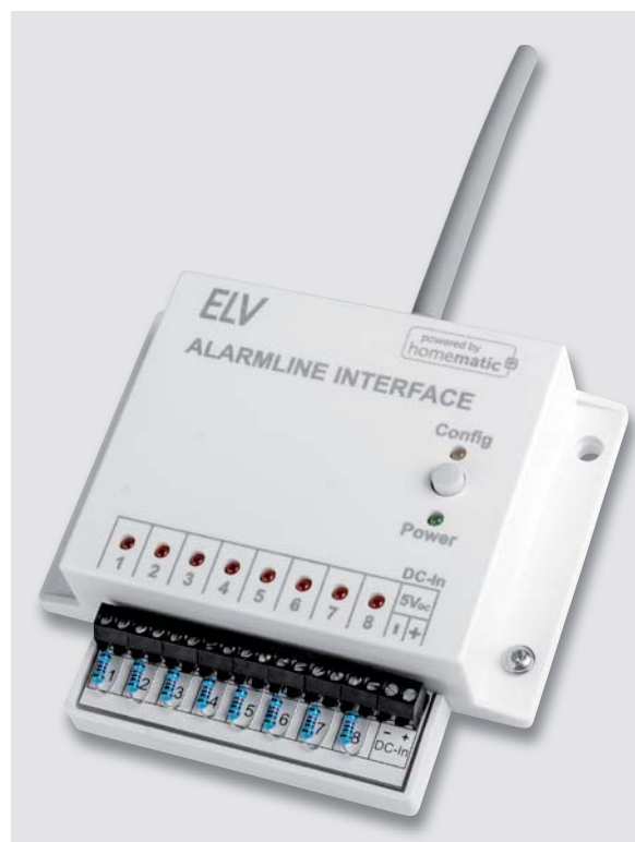
Bild 18: Die 10-k \Omega -Widerstände werden bei fehlenden Widerständen in der Linie und bei nicht genutzten Linieneingängen benötigt.
