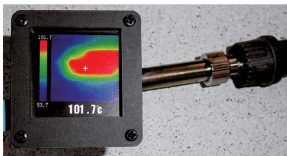
Bild 19: Mit dem Infrarot-Tempersensor MLX90614 lässt sich bereits eine rudimentäre Wärmebildkamera aufbauen – hier registriert sie das Aufheizen einer Lötspitzen Spitze.
