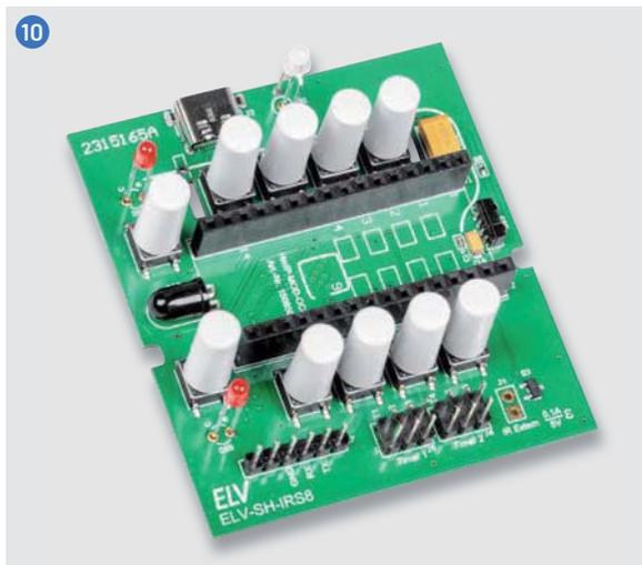
Nun werden die Tasterkappen auf die Taster S1-S10 gesetzt. **Dabei bitte vorsichtig vorgehen!** Durch die Höhe der Taster ist der Hebel recht groß und kann bei unvorsichtigem Aufsetzen zur Beschädigung des Tasters führen. Im Bild ist die fertig bestückte Platine zu sehen.
