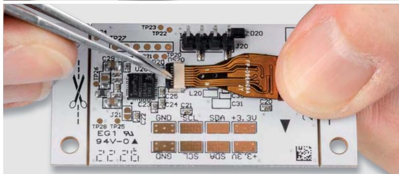
Führen Sie das Kabel in den Steckverbinder und klappen Sie anschließend den Hebel nach unten. Das Kabel ist nun fixiert.
