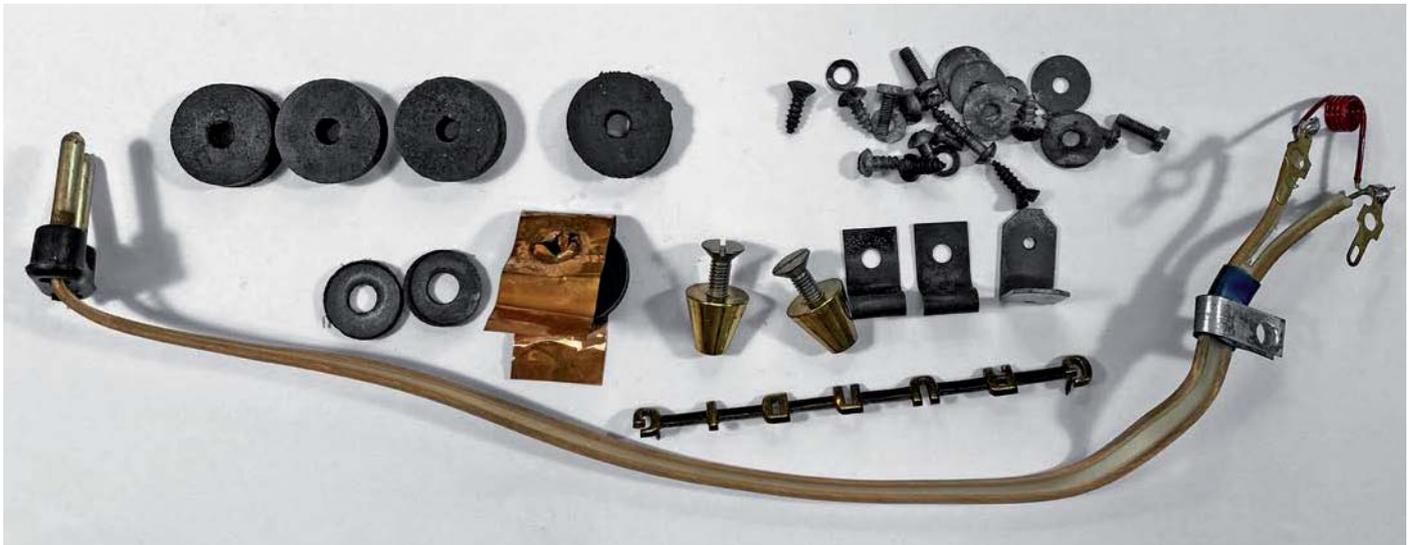
Bild 9: Alle Zubehörteile sind ordnungsgemäß gereinigt und können wieder für den Zusammenbau verwendet werden.
