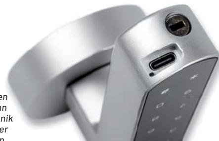
Bild 3: Über einen USB-C-Port kann man die Elektronik bei ausgefallener Batterie speisen.
