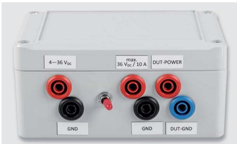
Bild 16: Die Anschlüsse der „Messbox“ auf der Rückseite
