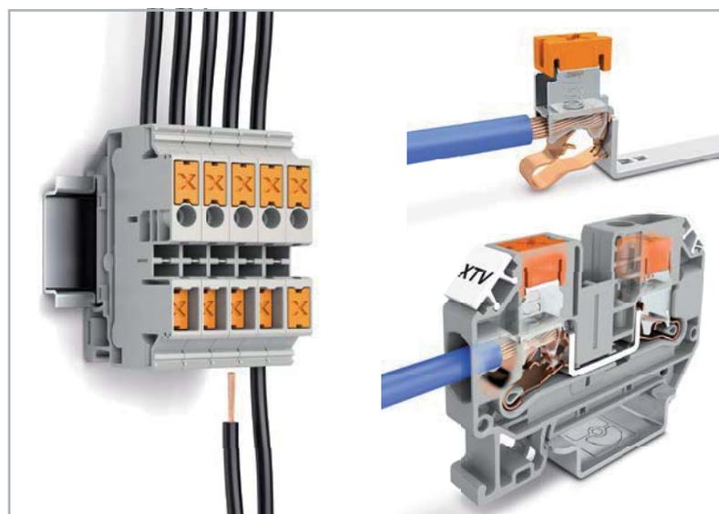
Bild 17: Hier ist die Wirkungsweise der ausgeklügelten Federklemmtechnik Push-X gut zu sehen. Auch hier werden feindrängige Leiter durch einen Drücker arretiert und gelöst. Bild: XTV-Reihenklemme, PHOENIX CONTACT
