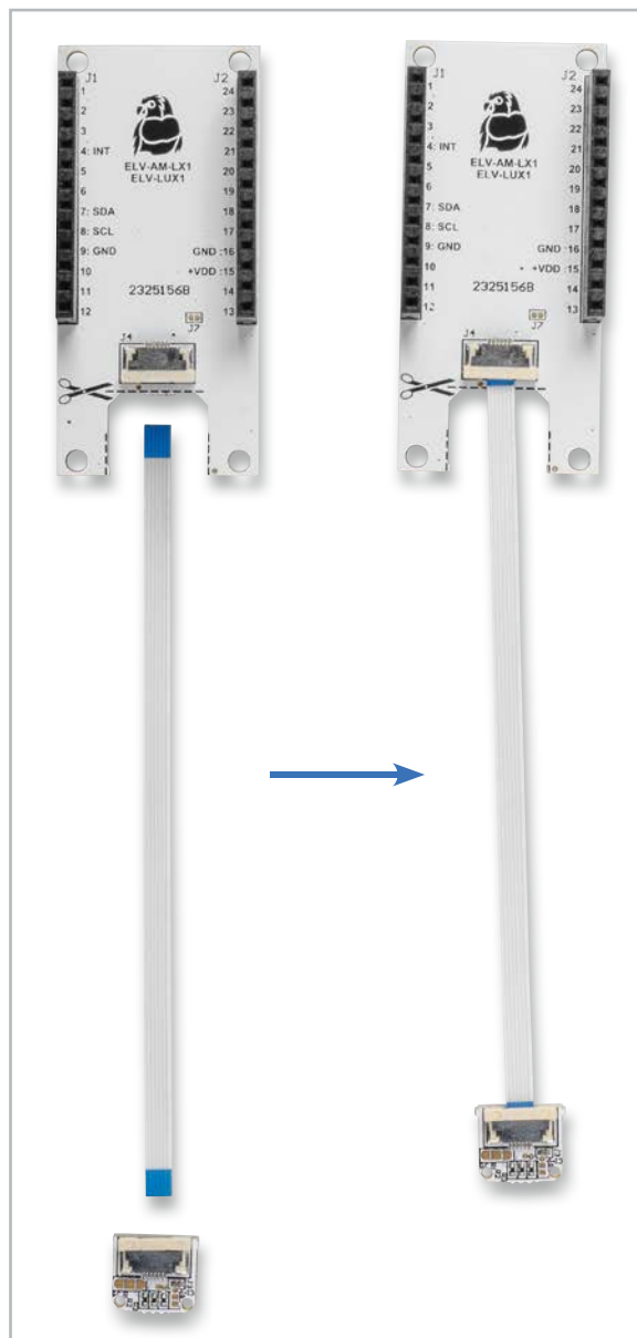
Bild 6: Nach dem Herausbrechen wird die Sensorplatine wie im Bild gezeigt mit dem Kabelanschluss auf dem Applikationsmodul verbunden.
