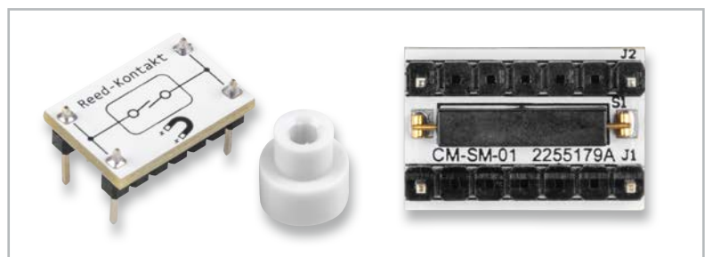
Bild 12: Reed-Kontakt mit Testmagnet
