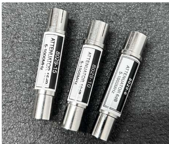
Bild 8: Drei Dämpfungsglieder zur Reduzierung des Ausgangssignalspegels, wenn 88 dB \mu V für Ihre Bedürfnisse zu hoch sind.
