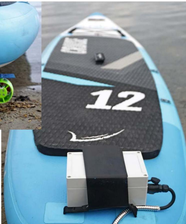
Bild 12: SUP-Montage der Empfangsbox
