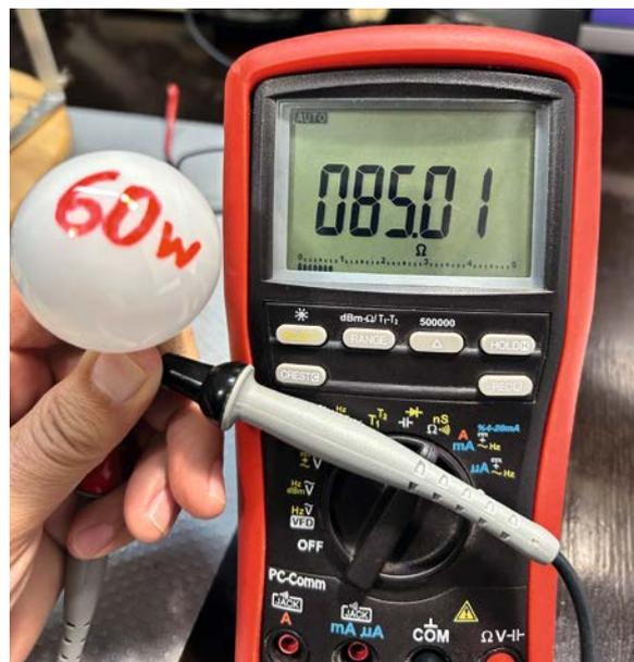
Bild 2: Der Widerstand einer kalten 60-W-Glühlampe
