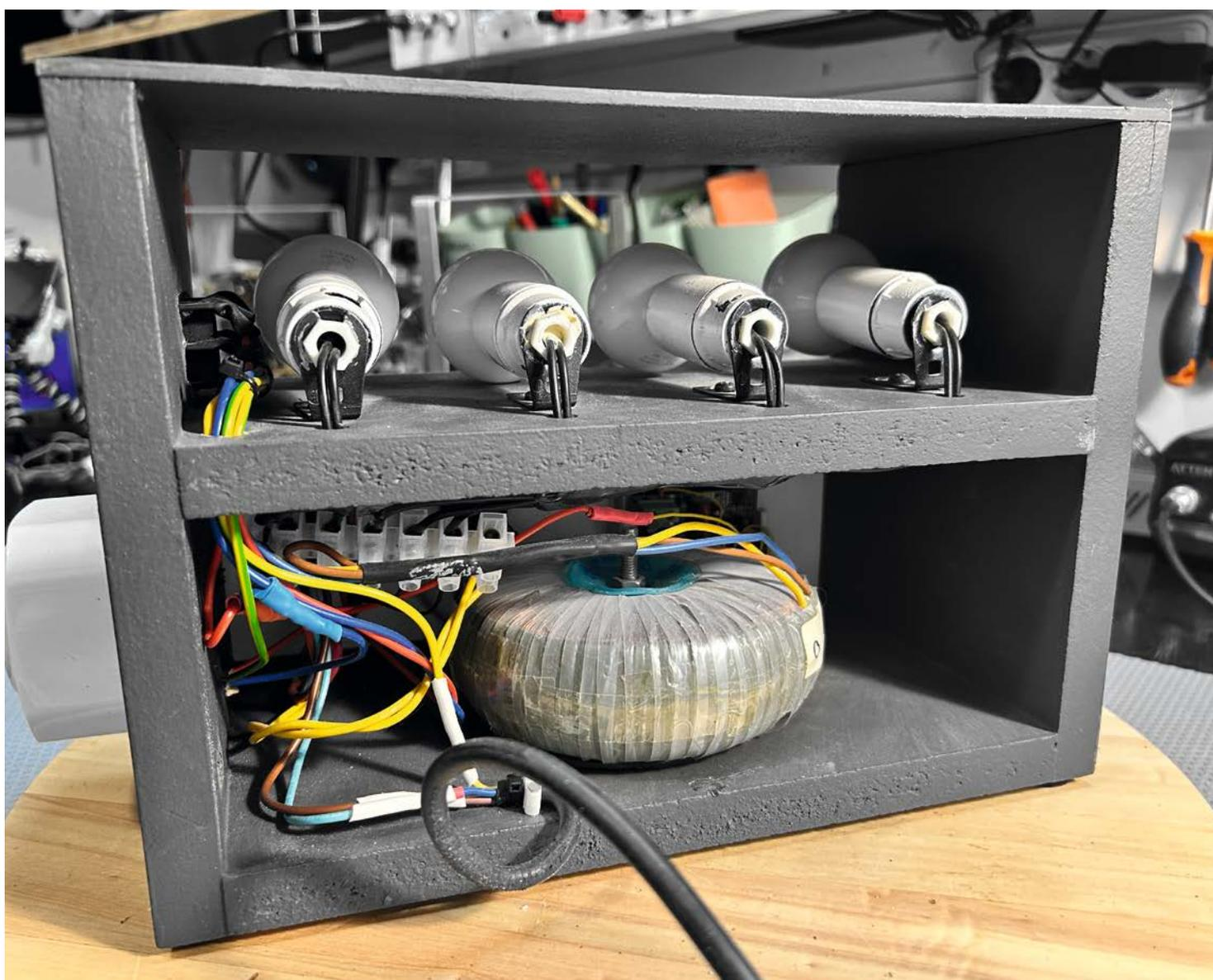
Bild 10: Die interne Verdrahtung des Lampenstrombegrenzers bzw. Trenntransformators
