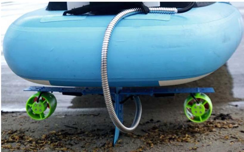
Bild 11: SUP-Montage der Antriebseinheit
