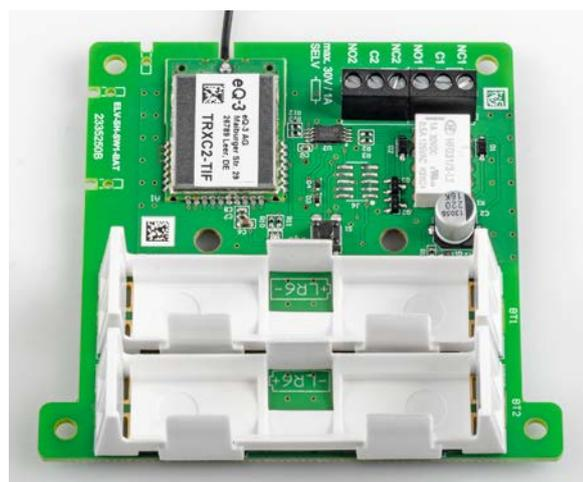
Bild 10: Einsetzen der Batteriehalter
