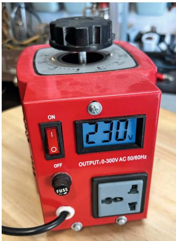
Bild 6: Variabler Spartransformator für die Elektronikwerkstatt
