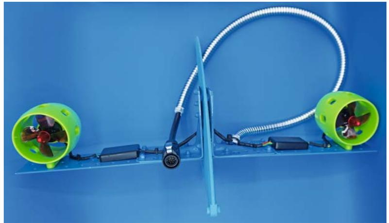
Bild 1: Antriebseinheit für das SUP
