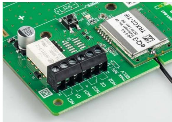
Bild 9: Montage der Schraubklemmen
