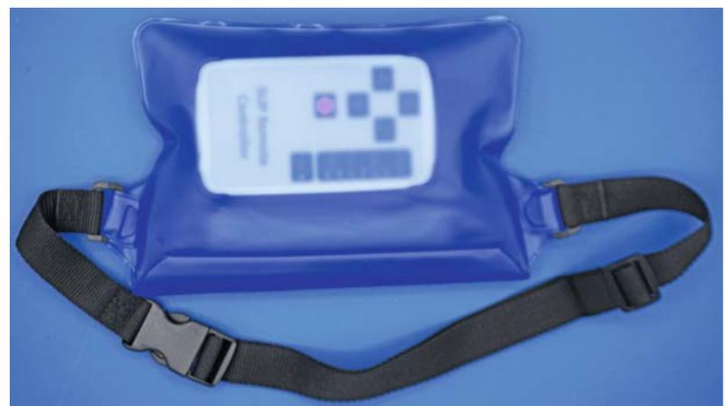
Bild 20: Fertiger Handsender in wasserdichter Verpackung
