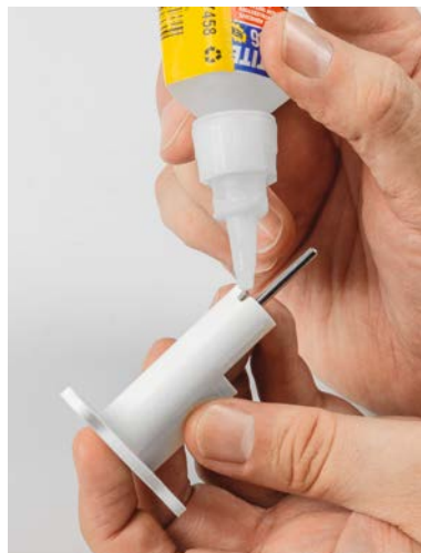
Bild 37: Einkleben der Achse für das Anemometer
