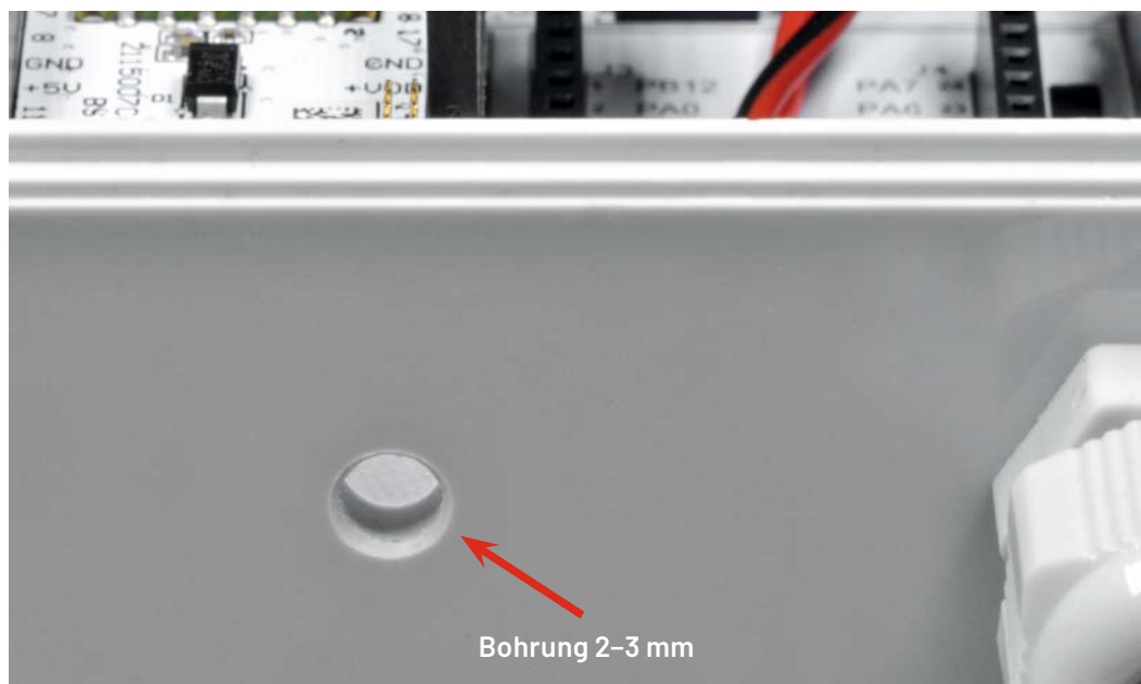
Bild 28: So wird eine Druckausgleichsmembran montiert.
