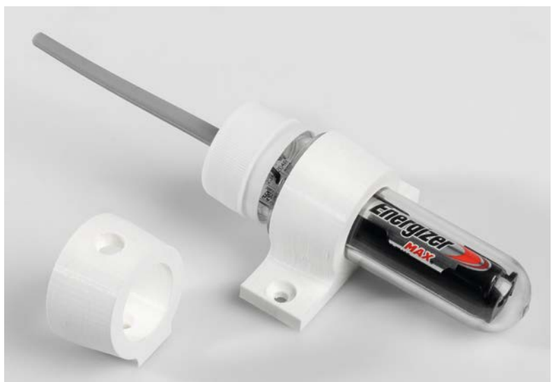
Bild 7: 3D-gedruckte Halterungen für den ELV-LW-0M0
