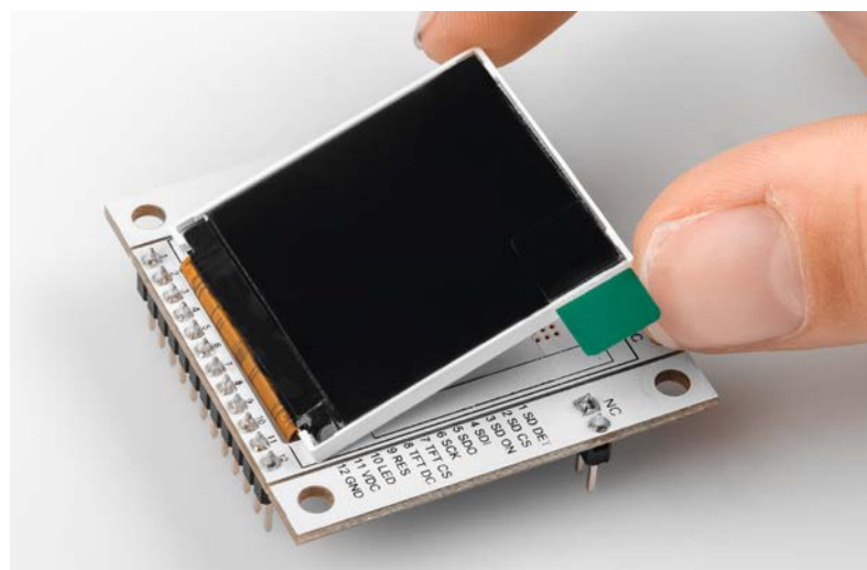
Bild 12: Montage des Displays auf der Platine
