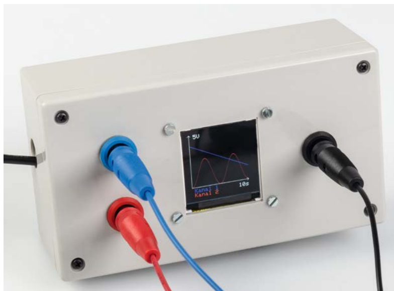
Bild 15: Das PAD-TFT-Display in einem Gehäuse verbaut
