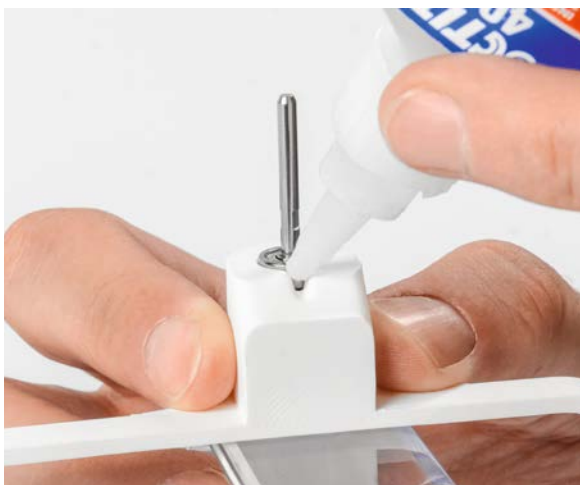
Bild 34: Fixieren der Achse mit Sekundenkleber
