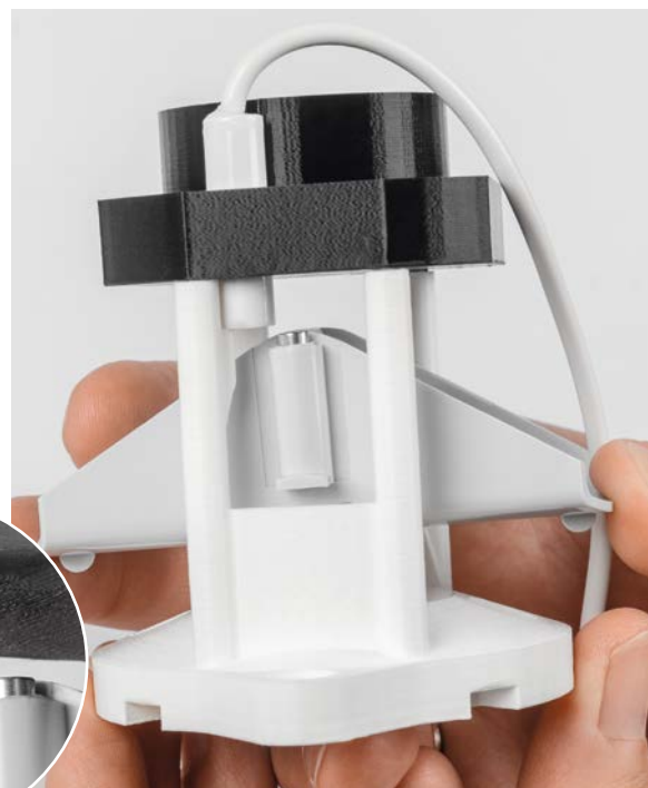
Bild 42: Einsetzen des Reed-Kontakts
