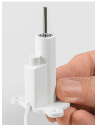
Bild 38: Einführen des Reed-Kontakts parallel zur Achse des Anemometers
