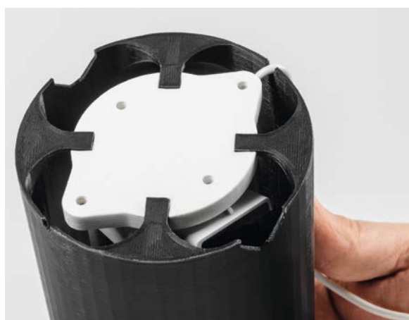
Bild 43: Einsetzen des Wippenhalters in die Abdeckung
