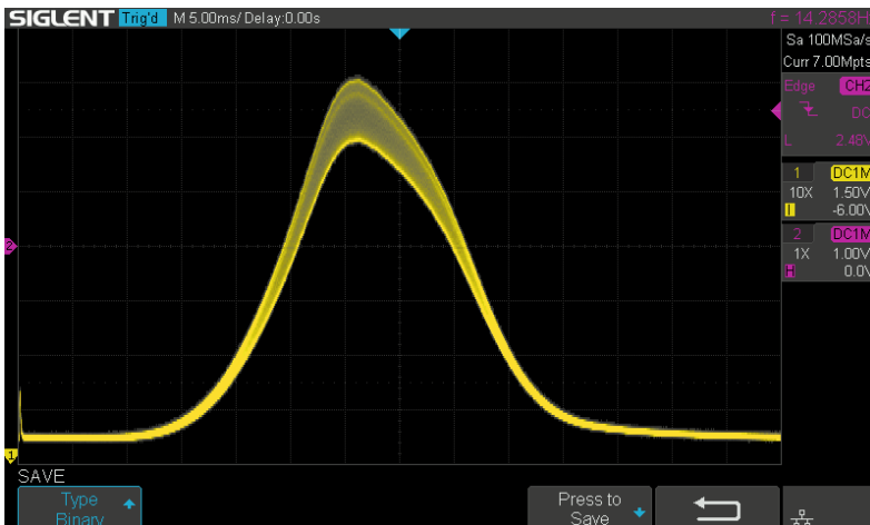
Bild 6: Die Form der Frequenzkurve nach Anwendung der „Peaking“-Methode
