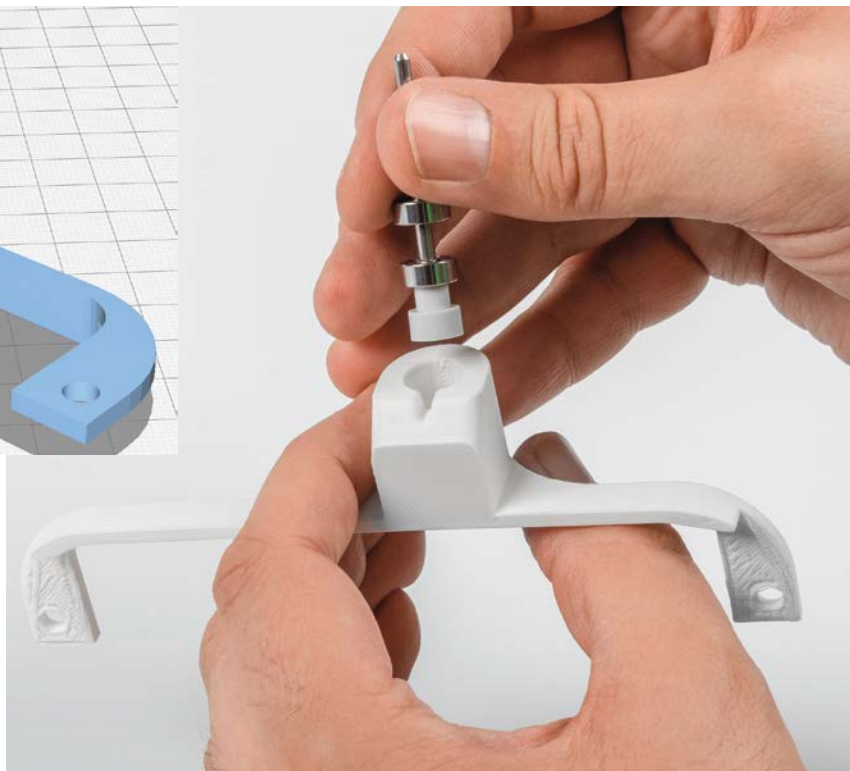
Bild 31: Einführen der Achse in den Haltebügel für die Windfahne
