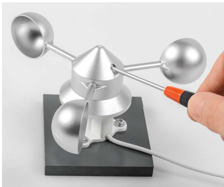
Bild 39: Befestigen der Anemometer-Mechanik auf der Achse
