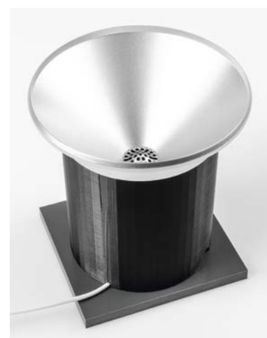
Bild 44: Aufsetzen des Regentrichters auf die Konstruktion
