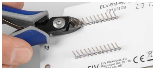
Bild 16: Das Abschneiden der Anschlussdrähte
