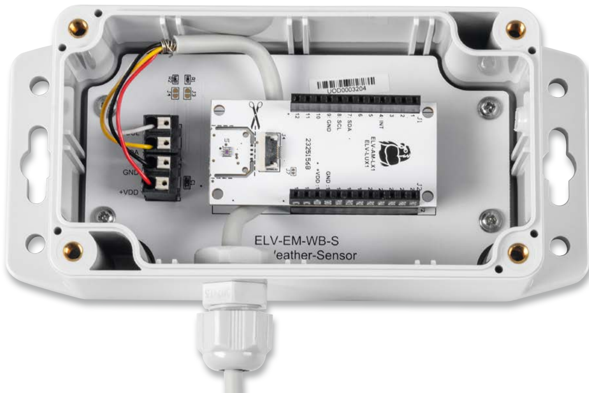
Bild 25: Ein abgesetzter I 2 C-Sensor des ELV-Wetterboards im vorgesehenen Installationsgehäuse
