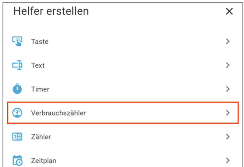
Bild 36: Erstellung eines Verbrauchszähler-Helfers
