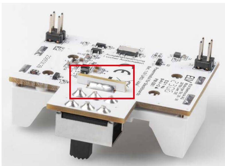
Bild 11: Die Abstandshalterplatine wird mit der Basisplatine verlötet.
