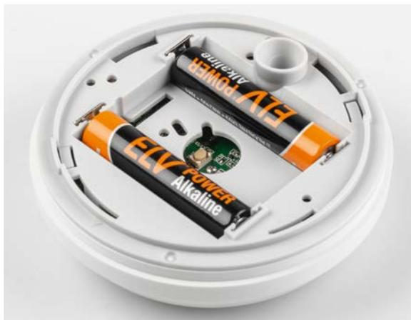
Bild 17: Einlegen der Batterien
