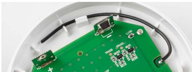
Bild 15: Verlegung der Antenne in der Gehäuseunterschale
