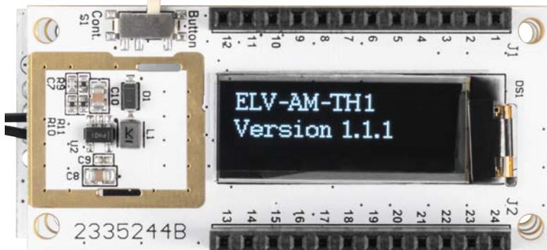
Bild 2: Anzeige des Applikationsnamens und der Firmware-Version auf dem Display
