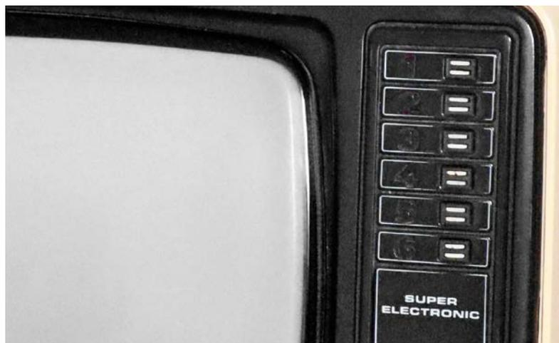
Bild 7: Sensortasten an einem 1970er-Grundig TV (Quelle: Walter Cicchetti, stock.adobe.com)
