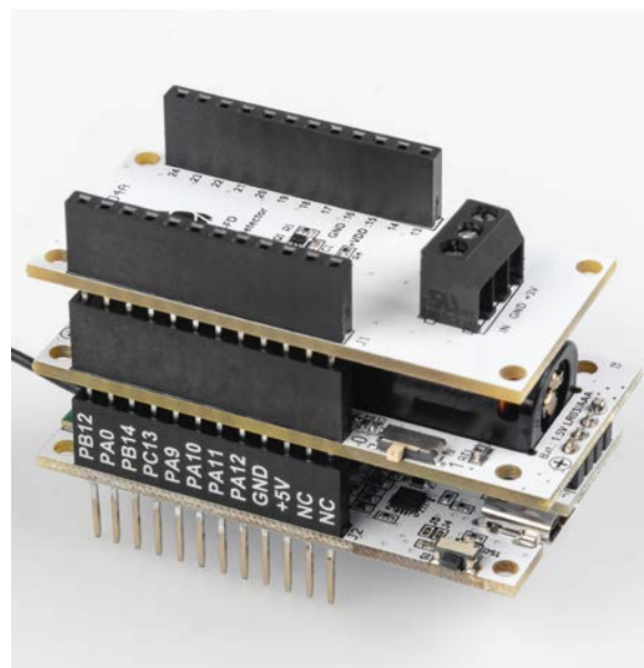
Bild 2: Anwendungsbeispiel für einen Modulstapel bestehend aus ELV-AM-FD (oben), dem ELV-PM-LR03 (Mitte) und der ELV-LW-Base (unten)
