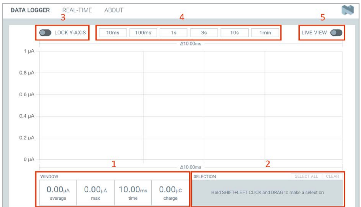
Bild 7: Data-Logger-Bereich der Power-Profiler-Software
