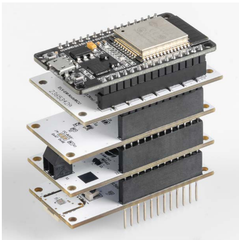
Bild 1: NodeMCU mit ELV Erweiterungsmodule NodeMCU und aufgesteckten Applikationsmodulen (ELV-AM-TH1, ELV-AM-AP, ELV-AM-LX1)
