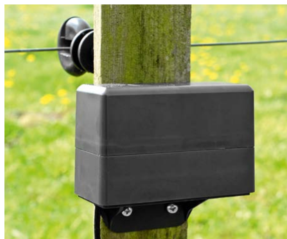
Bild 20: Befestigung der Basiseinheit an einem Weidezaunpfahl
