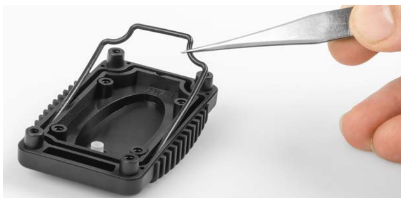
Bild 10: Einlegen der Gummidichtung in die Nut der Oberschale
