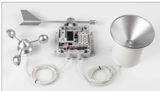
Anwendungsbeispiel: Basisboard mit ELV-Modulen und 3D-Druck-Komponenten
