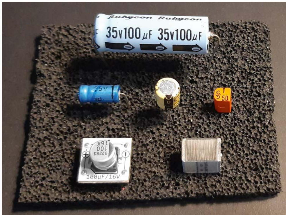
Bild 8: Elkos in verschiedenen Ausführungen
