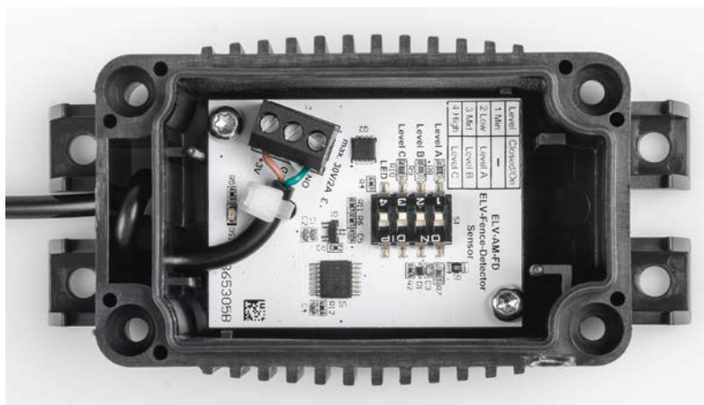
Bild 14: Befestigung der Platine mit den kürzeren Innensechskant-Schrauben
