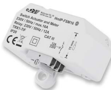
Bild 1: Homematic IP Smart Home Schalt-Mess-Aktor HmIP-FSM16
