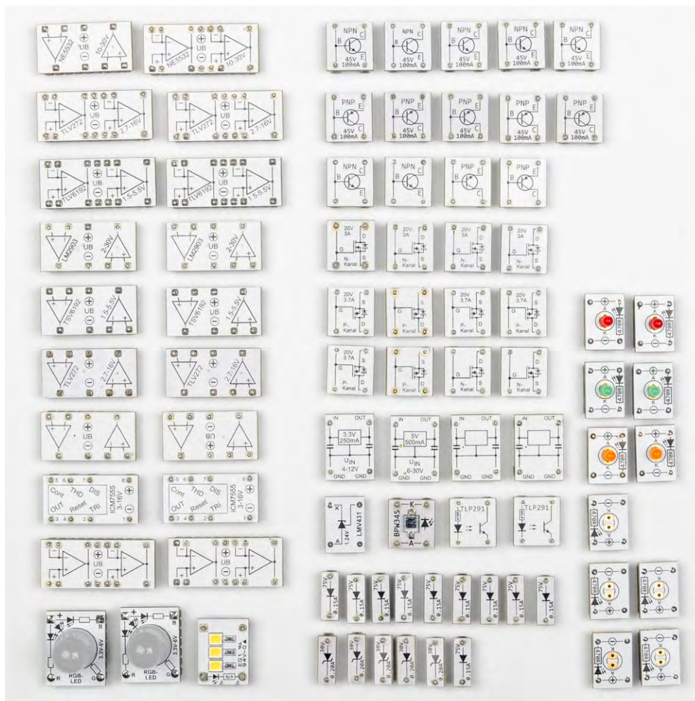
Bild 2: Das Set des PAD-PRO-L01 mit allen enthaltenen Modulen
