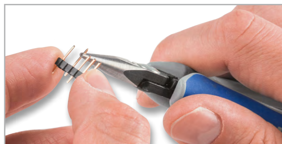
Bild 9: So kann man einzelne Stifte aus einer Stiftleiste herausziehen.
