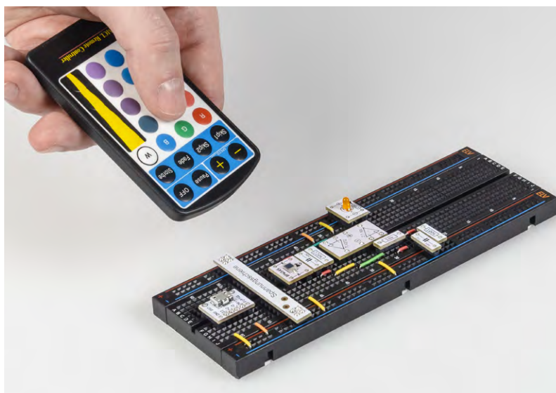
Bild 7: Der Abstand zwischen der zu testenden Fernbedienung und der Fotodiode sollte weniger als 10 cm betragen.
