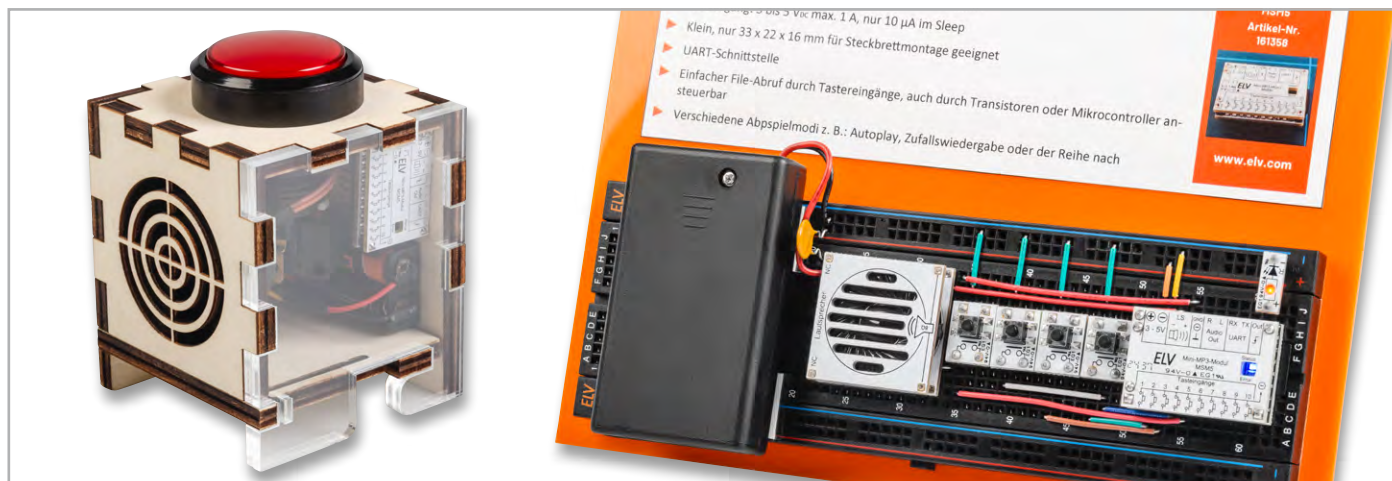
Bild 3: Demoaufbau mit Soundwürfel und mit einem Steckboard
