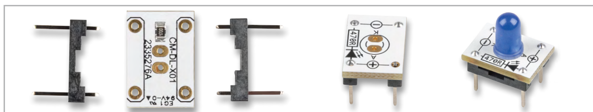
Bild 27: Leerplatine für LEDs mit Beispiel einer blauen 5-mm-LED
