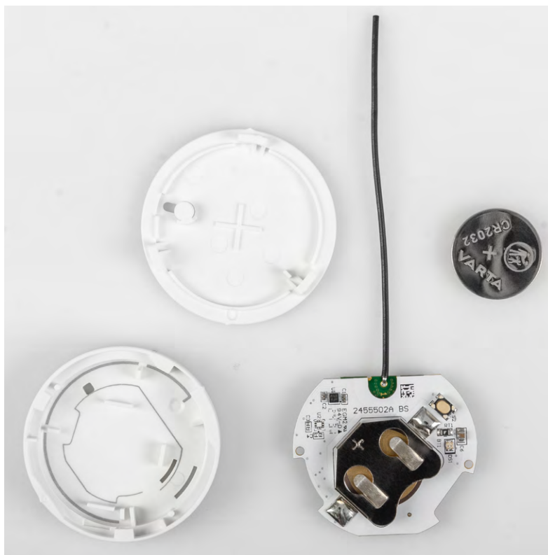
Bild 3: Bausatz aus nur vier Teilen – ganz ohne Löten
