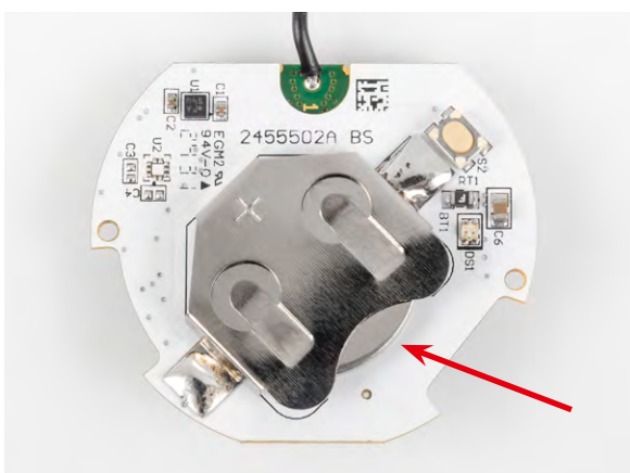
Bild 4: Knopfzelle mit der Plus-Seite nach oben in den Batteriehalter einschieben
