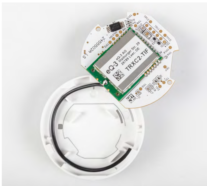
Bild 24: So wird die Antenne in das Gehäuseunterteil geklemmt.
