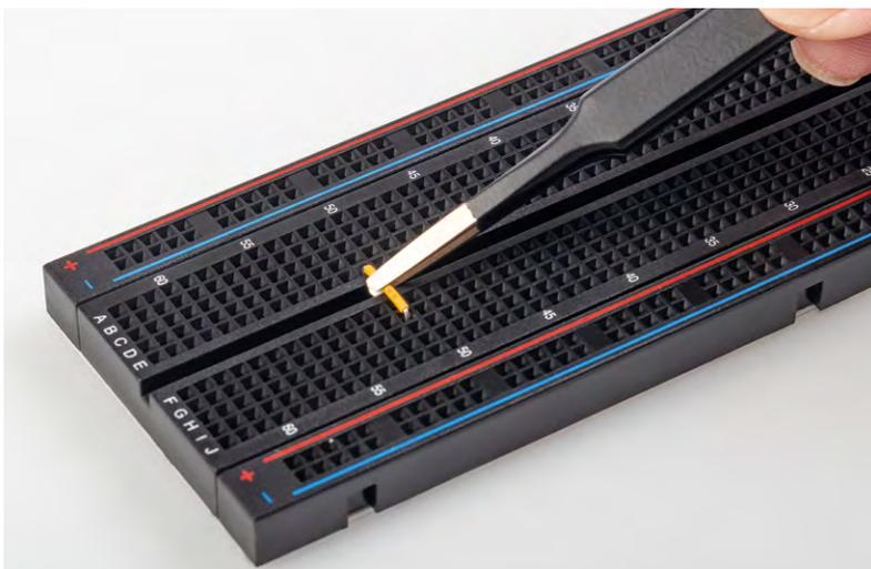
Bild 28: Mit einer Pinzette können die Steckbrücken einfach eingesetzt und entfernt werden.
