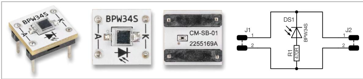
Bild 2: Der Helligkeits-/Lichtsensor BPW34S
