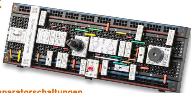
**Komparatorschaltungen mit Operationsverstärkern**
