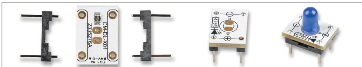
Bild 28: Fotos und Schaltbild der Platine CM-DL-RGB01 mit der RGB-LED und dem LED-Cluster (CM-DL-W01)
