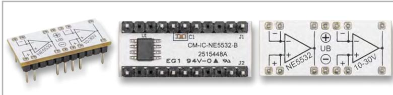
Bild 9: PAD-Modul des Operationsverstärkers NE5532 (große Platinenversion)
