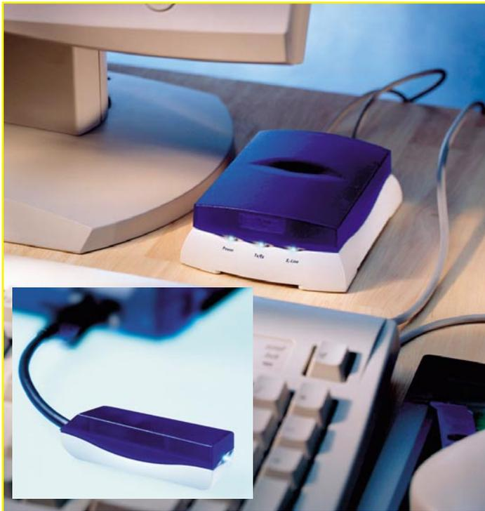
**Bild 9: Kein lästiges Modem-kabel mehr - Bluetooth macht Datenfunk bis zu 10 m möglich, hier das ELSA-Modem „Microlink ISDN Bluetooth“.**
