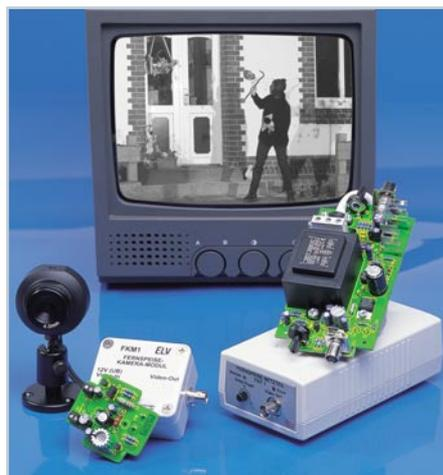
◀ **Fernspeisung für Überwachungskameras**
