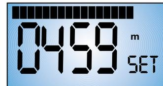
**Bild 9: Die Festsetzung der Alarmhöhe erfolgt über die SET-Funktion.**
