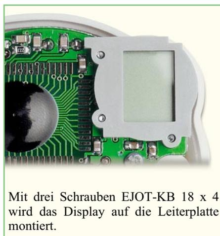
Mit drei Schrauben EJOT-KB 18 x 4 wird das Display auf die Leiterplatte montiert.
