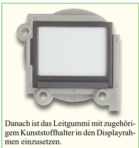
Danach ist das Leitgummi mit zugehörigem Kunststoffhalter in den Displayrahmen einzusetzen.
