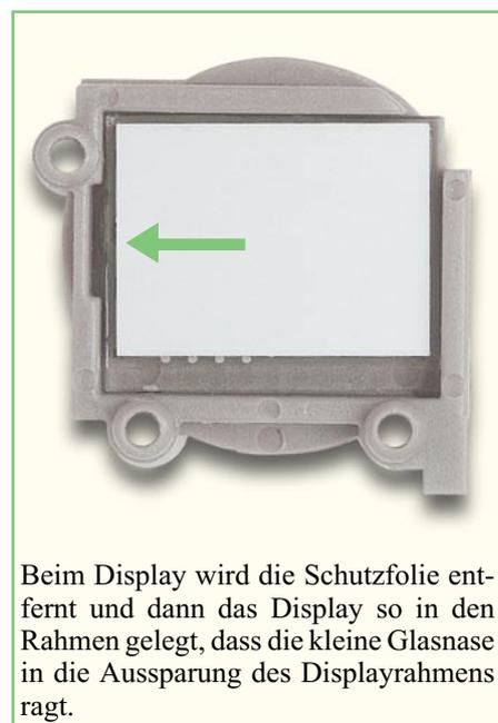
Beim Display wird die Schutzfolie entfernt und dann das Display so in den Rahmen gelegt, dass die kleine Glasnase in die Aussparung des Displayrahmens ragt.
