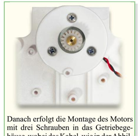
Danach erfolgt die Montage des Motors mit drei Schrauben in das Getriebegehäuse, wobei das Kabel, wie in der Abbildung gezeigt, zu verlegen ist. Wichtig ist, dass die Leitungen sorgfältig verdrillt werden.
