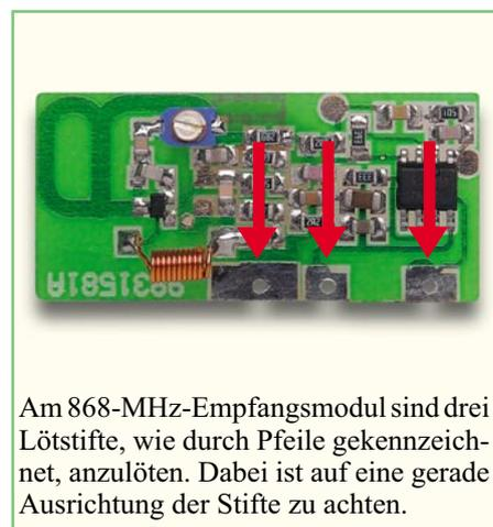
Am 868-MHz-Empfangsmodul sind drei Lötstifte, wie durch Pfeile gekennzeichnet, anzulöten. Dabei ist auf eine gerade Ausrichtung der Stifte zu achten.
