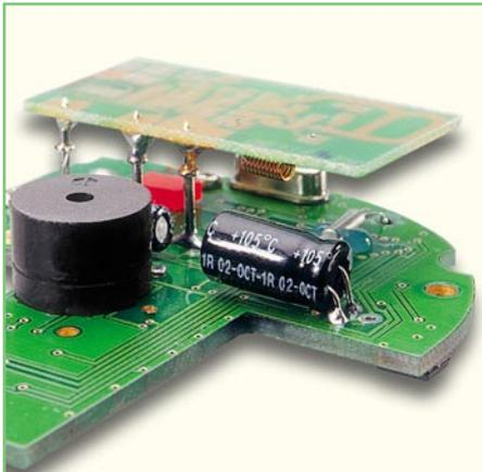
Das Modul wird unter Beachtung der korrekten Ausrichtung auf die Unterseite der Basisplatte gelötet.
