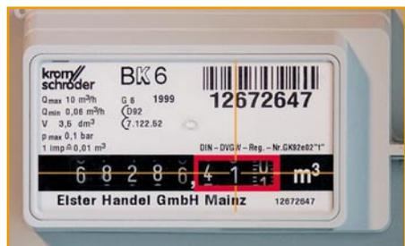
**Bild 2: Zielkreuz zur Markierung der Zahlenscheibe der Gaszähleruhr**
