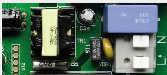
Bild 7: Die bessere Sicherheitslösung – eine Kleinstsicherung (SI 1) auf der Platine
