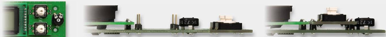
Bild 15: Die Platine als Gesamtsicht (links) sowie vor (Mitte) und nach (rechts) Abbrechen und Auflöten der Tasterplatine
