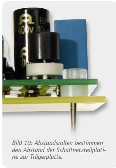
Bild 10: Abstandsrollen bestimmen den Abstand der Schaltnetzteilplatine zur Trägerplatte.
