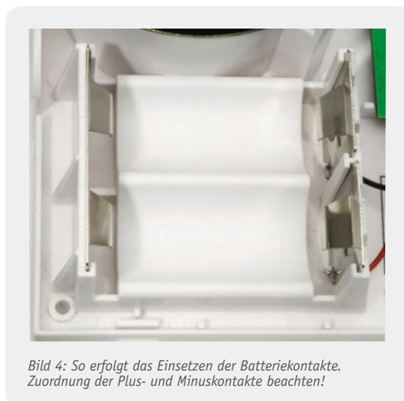
Bild 4: So erfolgt das Einsetzen der Batteriekontakte. Zuordnung der Plus- und Minuskontakte beachten!
