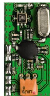
ISM-Superhet-Empfänger für 868,35 MHz mit Quarzoszillator und 10,7-MHz-ZF
