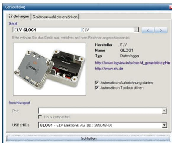
Bild 4: Mit LogView konfiguriert man den GLog1, ruft die Messdaten ab und wertet diese grafisch aus.
