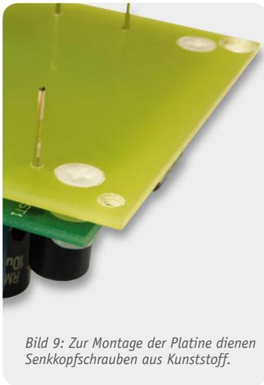
Bild 9: Zur Montage der Platine dienen Senkkopfschrauben aus Kunststoff.
