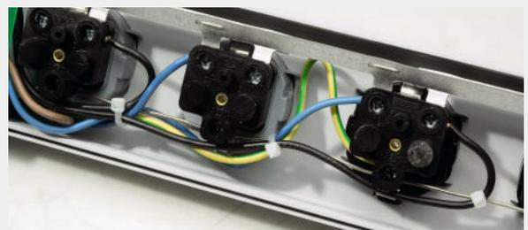
Bild 4: So fixiert hat ein Leistungsende auch beim Lösen aus der Verschraubung keinen großen Aktionsradius und löst allenfalls FI- oder LS-Schalter aus.
