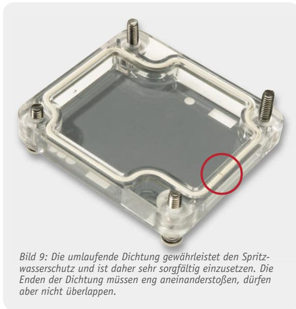
Bild 9: Die umlaufende Dichtung gewährleistet den Spritzwasserschutz und ist daher sehr sorgfältig einzusetzen. Die Enden der Dichtung müssen eng aneinanderstoßen, dürfen aber nicht überlappen.
