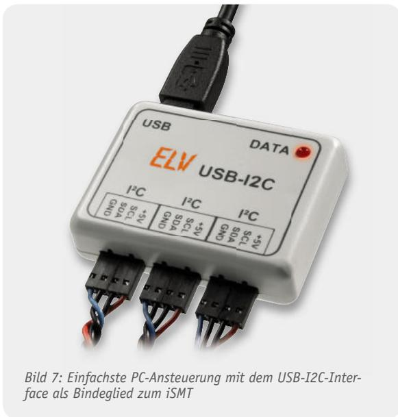
Bild 7: Einfachste PC-Ansteuerung mit dem USB-I2C-Interface als Bindeglied zum iSMT
