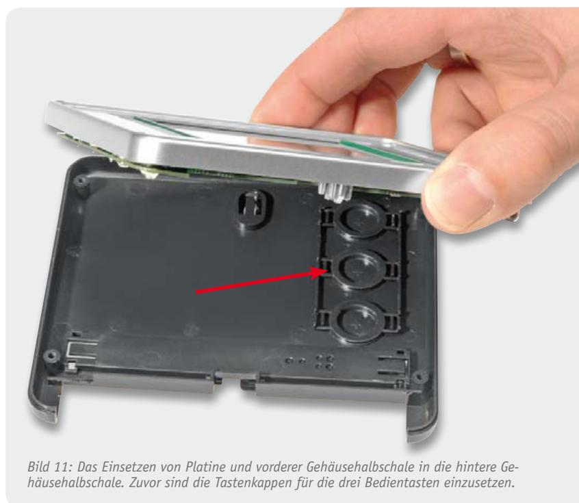
Bild 11: Das Einsetzen von Platine und vorderer Gehäusehälfte in die hintere Gehäusehälfte. Zuvor sind die Tastenkappen für die drei Bedientasten einzusetzen.
