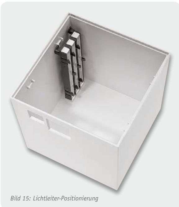
Bild 15: Lichtleiter-Positionierung
