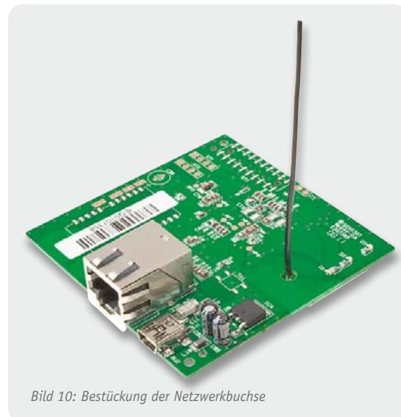
Bild 10: Bestückung der Netzwerkbuchse
