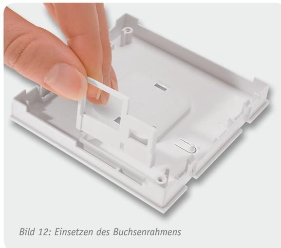
Bild 12: Einsetzen des Buchsenrahmens
