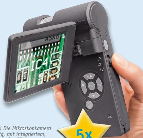
Für Schule, Hobby, Forschung und Beruf! Die Mikroskopkamera für den mobilen Einsatz – PC-unabhängig, mit integriertem, klappbarem Farbdisplay, 4fach-Zoom und microSD-Kartenspeicher. Mit der mitgelieferten PC-Vermessungssoftware sind die Aufnahmen hoch präzise auswertbar. Abstände, Flächen, Winkel mit einer Auflösung im Mikrometer-Bereich! Weitere Infos finden Sie im Web-Shop: Webcode #1218
