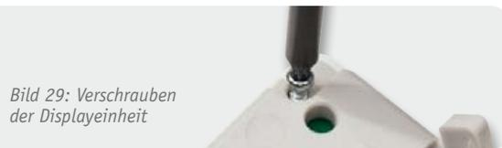
Bild 29: Verschrauben der Displayeinheit
