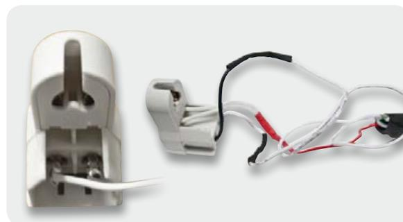
Bild 8: Mangelhafte Isolierungen der Netzspannung führenden Leitungen
