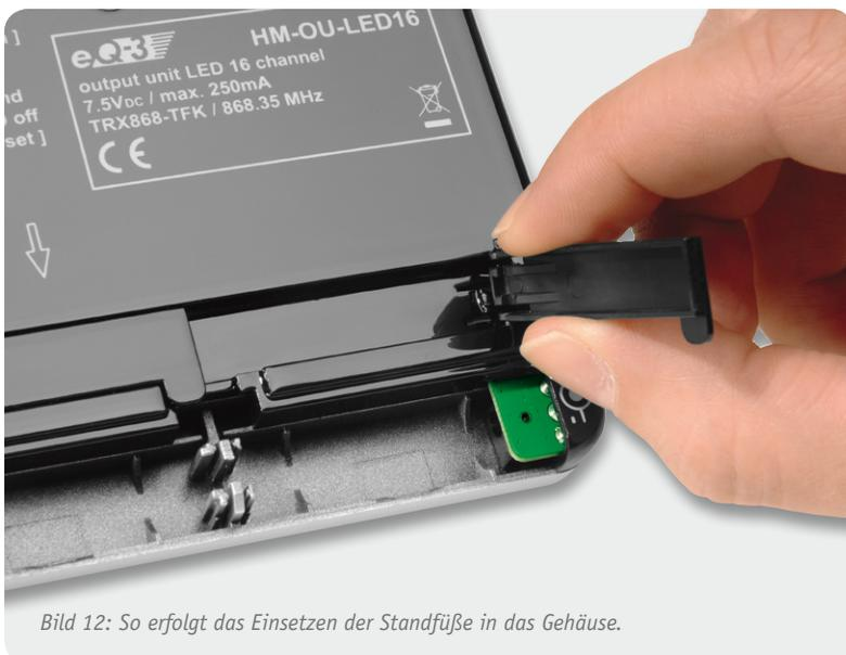
Bild 12: So erfolgt das Einsetzen der Standfüße in das Gehäuse.
