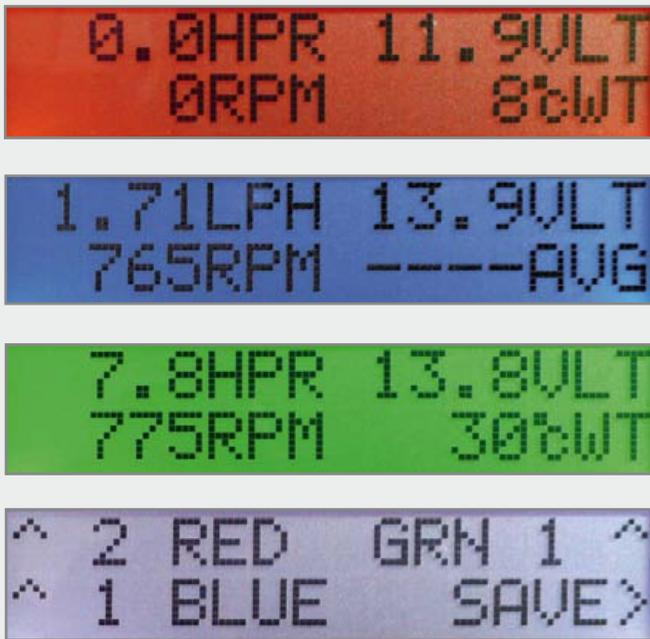
Bild 3: Die Display- und Tastenbeleuchtung ist individuell einstellbar.
