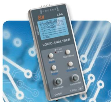
**6-Kanal-Logic-Analyser – Logikpegel erfassen, anzeigen, speichern**
