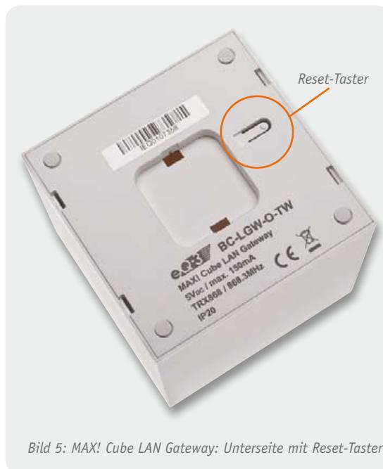
Bild 5: MAX! Cube LAN Gateway: Unterseite mit Reset-Taster
