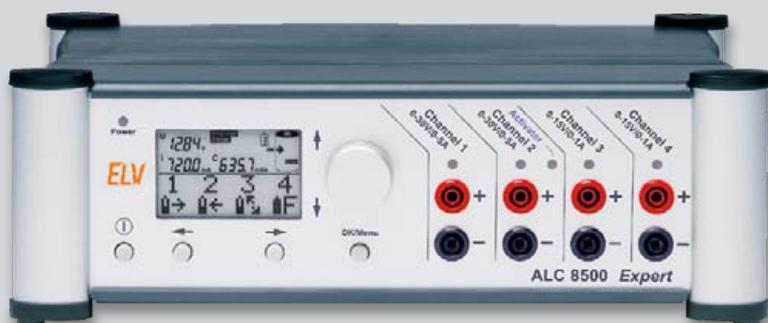
Ich möchte hochkapazitive NiMH-Akkus „artgerecht“ laden, Fast-, Topping- und Trickle-Charging mit entsprechender Delta-T-Überwachung (0,5 °C/min). Ich bitte um Angabe der notwendigen Einstellung der Ladeparameter für den ELV-Lader ALC 8500-2 Expert. Der Akku hat eine Kapazität von 9500 mAh.
