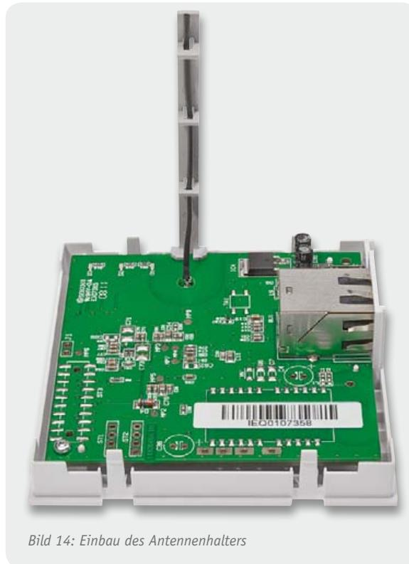
Bild 14: Einbau des Antennenhalters
