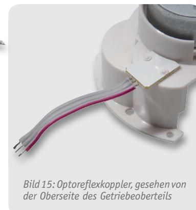
Bild 15: Optoreflektkoppler, gesehen von der Oberseite des Getriebeoberteils
