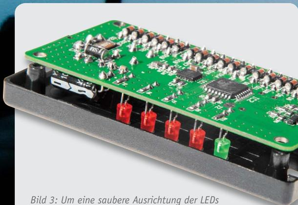
Bild 3: Um eine saubere Ausrichtung der LEDs zu erreichen, sollte die Platine zum Löten bereits in die Gehäuseoberseite eingelegt werden, die LEDs sollten in den zugehörigen Gehäusebohrungen liegen.
