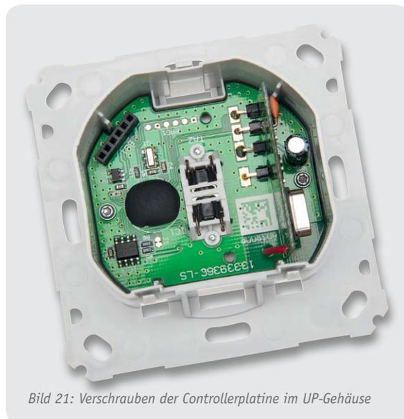
Bild 21: Verschrauben der Controllerplatine im UP-Gehäuse
