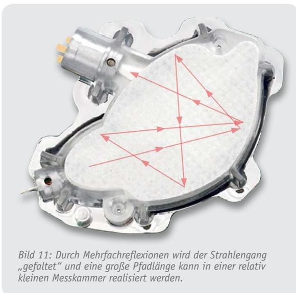
Bild 11: Durch Mehrfachreflexionen wird der Strahlengang „gefaltet“ und eine große Pfadlänge kann in einer relativ kleinen Messkammer realisiert werden.
