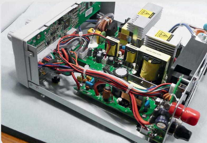
Bild 4: Sauberer Aufbau auf 5 Platinen, mit Steckverbindern verkabelt
