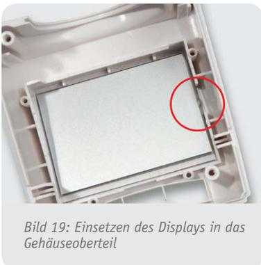
Bild 19: Einsetzen des Displays in das Gehäuseoberteil
