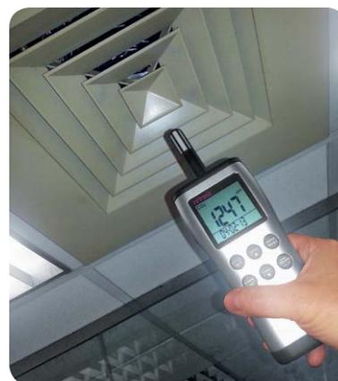
Bild 20: Aus dem Deckenauslass einer Lüftungsanlage sollte eigentlich CO<sub>2</sub>-arme Luft mit etwa 400 ppm kommen ... Mit dem Rotronic Handmessgerät CP11 kann man schnell nachweisen, ob hier alles in Ordnung ist.
