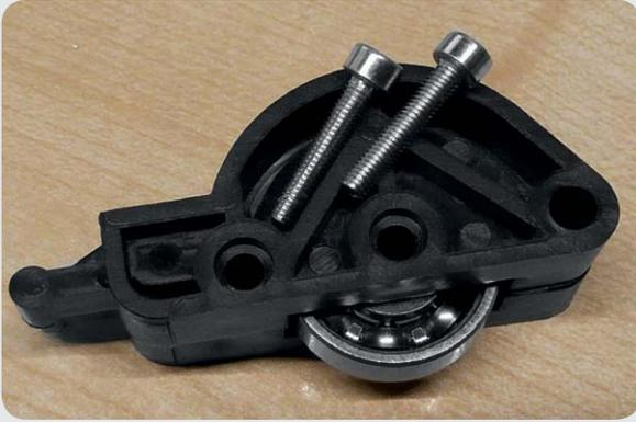
Bild 7: Filament-Führung – zu kurze Schrauben
