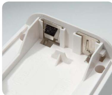
Bild 29: Einrasten der Batterie-Einzelkontakte
