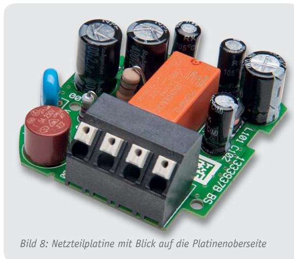
Bild 8: Netzteilplatine mit Blick auf die Platinenoberseite
