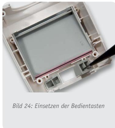
Bild 24: Einsetzen der Bedientasten
