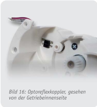
Bild 16: Optoreflexkoppler, gesehen von der Getriebeinnenseite
