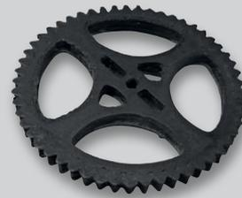
Bild 19: Das Zahnrad weist beim ersten Versuch noch gröbere Strukturen auf. Hier der Blick auf die Unterseite. Ein kleiner Grat ist im ersten Layer bei größeren Objekten nicht zu vermeiden und kann anschließend nachbearbeitet werden.
