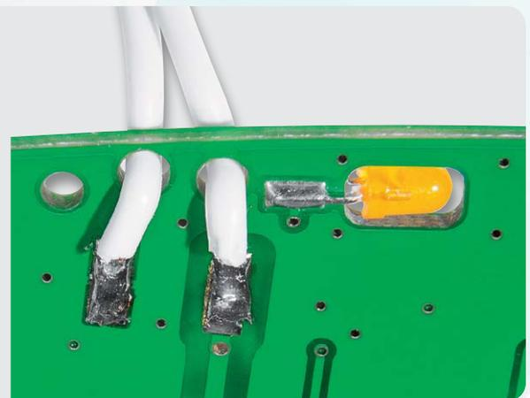
Bild 6: So wird die Anschlussleitung durch die Platine gefädelt und angelötet.
