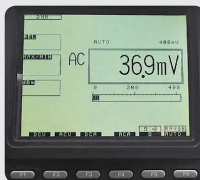
Bild 1: Restwelligkeit bei voller Ausgangsleistung, ein guter Wert
