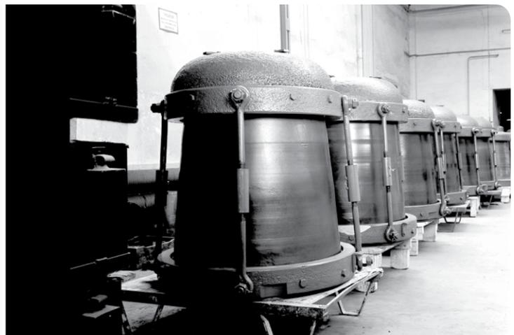
Bild 12: Nur mit entsprechend hochleistungsfähigen Prüffeldern waren Bauteile wie diese riesigen Mastfußisolatoren zu testen.
