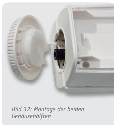
Bild 32: Montage der beiden Gehäusehälften
