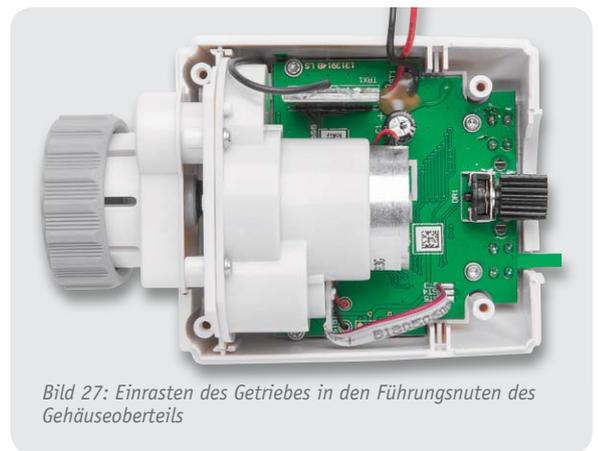
Bild 27: Einrasten des Getriebes in den Führungsnuten des Gehäuseoberteils
