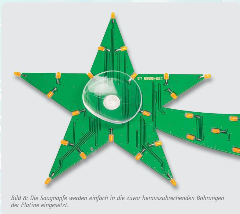
Bild 8: Die Saugnäpfe werden einfach in die zuvor herauszubrechenden Bohrungen der Platine eingesetzt.
