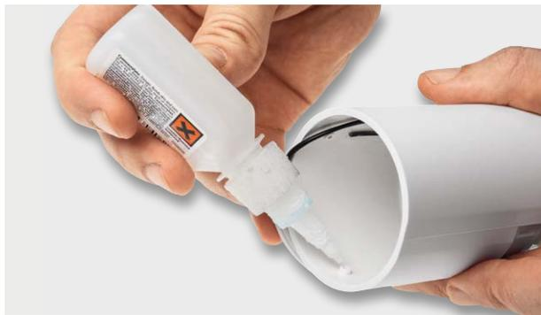
Bild 22: Sichern des Deckels mittels Sekundenkleber ...
