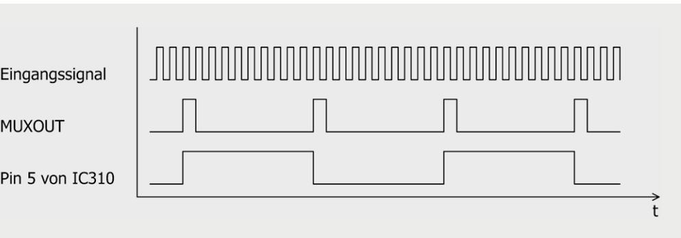
Bild 13: So erfolgt die Signalumformung des hochfrequenten Eingangssignals.
