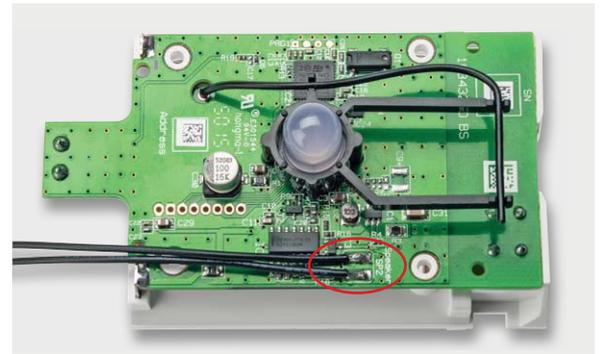
Bild 13: Hier sind die angelöteten Leitungen für den Piezo-Signalgeber zu sehen.
