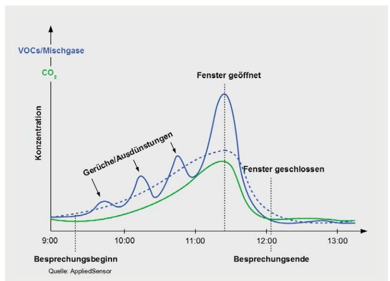
Bild 12: In Ruhe atmet ein Mensch in einer Stunde zwischen 12 und 15 l CO<sub>2</sub> aus. In der gleichen Zeit gibt er eine Vielzahl flüchtiger organischer Verbindungen (VOCs) aus den Stoffwechselprozessen ab. Kein Wunder, dass der Anstieg der Konzentrationen von CO<sub>2</sub> und VOCs in einem besetzten, geschlossenen Besprechungszimmer korreliert ist.
