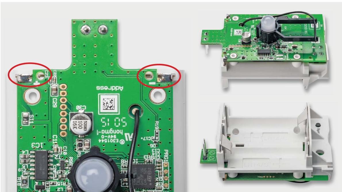
Bild 12: Nach dem Aufsetzen der Platine auf das Batteriefach sind die Batteriekontakte an die zugehörigen Lötspalten der Platine anzulöten. Rechts ist die exakte Lage der Platine auf dem Batteriefach zu sehen.
