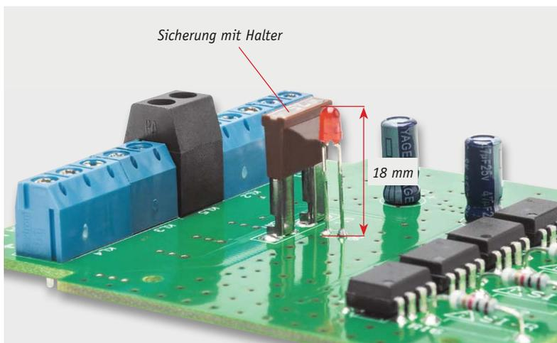
Bild 4: Die Einbauhöhe der LED beträgt 18 mm.
