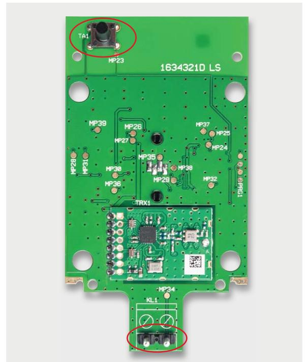
Bild 7: Hier sind die an ihrem Platz sitzenden Bauteile Stiftleiste für KL1 und Konfigurationstaster TA1 zu sehen.
