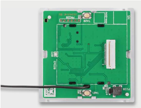
*Bild 12: So erfolgt das Aufsetzen der Controllerplatine mit durchgeführter Antenne auf die Funkplatine. Dabei ist sorgfältig auf das Einführen der Steckkontakte des 12-poligen Steckverbinders sowie auf das saubere Einrasten der Platinenhalter zu achten.*
