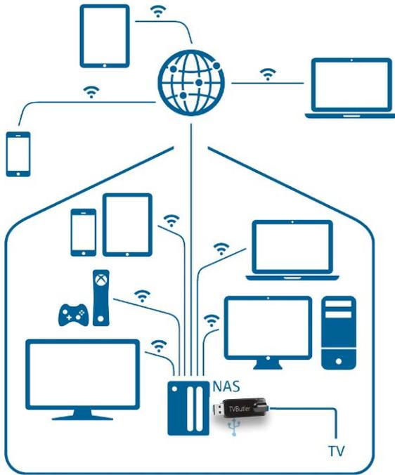
Das DVBLogic-TV-Tuner-Paket, das aus einem USB-TV-Empfänger und der zugehörigen DVBLink-Software besteht, eröffnet eine Vielfalt von Möglichkeiten, Fernsehsendungen zu empfangen, aufzuzeichnen und Aufnahmen NAS-basiert auf verschiedenen Clients, vom Smartphone bis zum TV-Gerät, wiederzugeben, auch unabhängig von Ort und Zeit. Wir baten 10 Leser, diese noch neue Technik zu testen.
