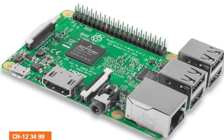
Mit den Drahtlos-Schnittstellen WLAN und Bluetooth an Bord wird der Mini-Computer Raspberry Pi 3 noch universeller und einfacher einsetzbar. Dazu kommen ein neuer, leistungsfähiger Prozessorkern sowie eine überarbeitete interne Stromverteilung, sodass nun die USB-Ports mehr Strom liefern können.
