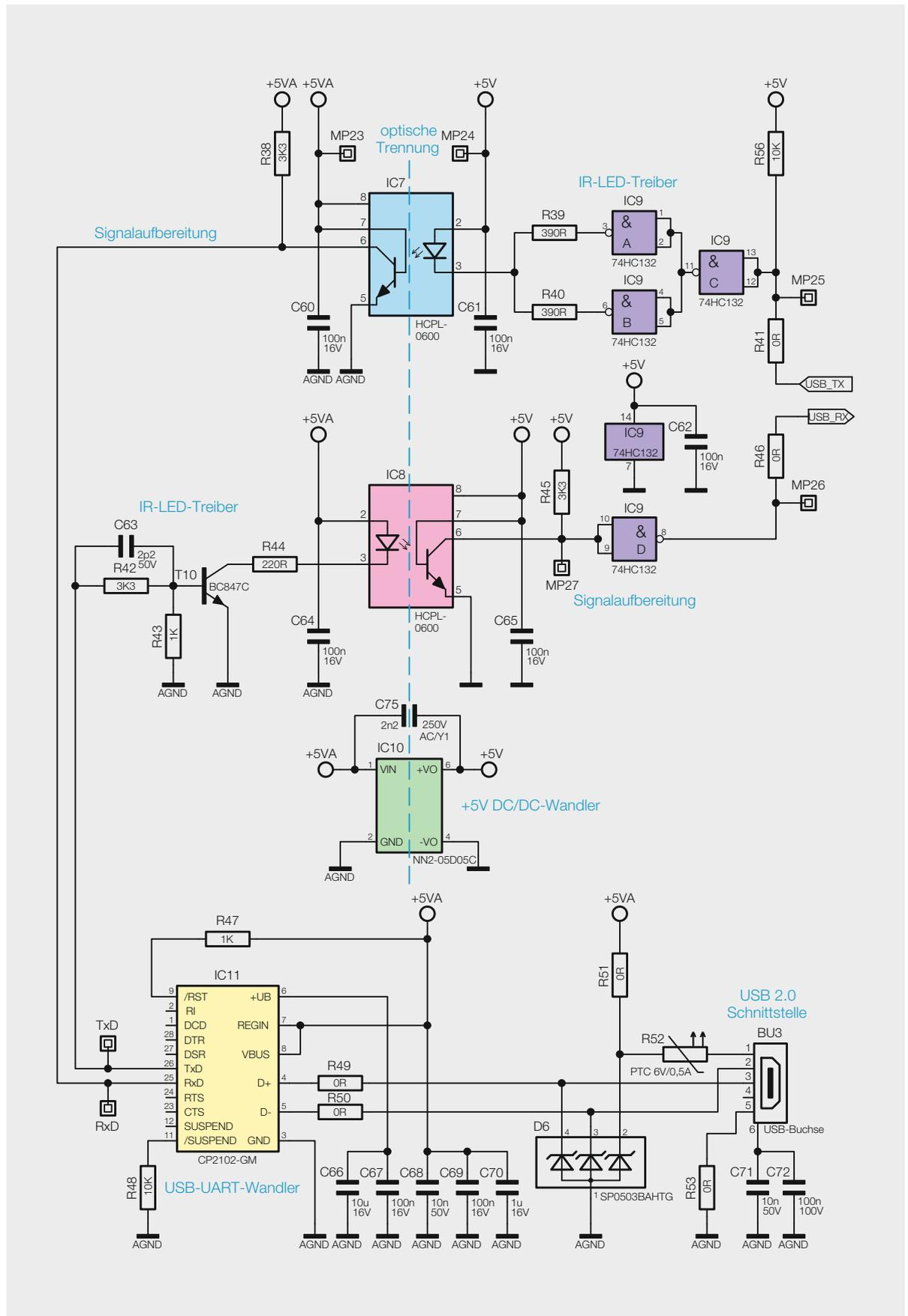
Bild 7: Das Schaltbild der USB-Schnittstelle des TD0200
