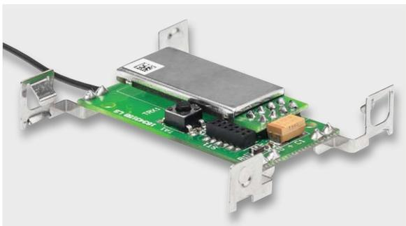
Bild 8: Die komplett bestückte Funkplatine
