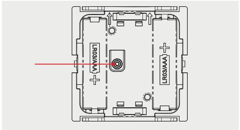
Bild 23: Der Konfigurationstaster befindet sich auf der Geräterückseite.
