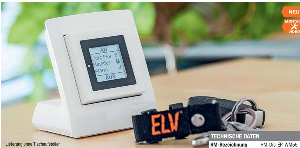
Die Funk-Statusanzeige mit 1,54"-Electronic-Paper-Display hat neben der Funktion eines elektronisch beschriftbaren 2fach-Funk-Wandsenders die zusätzliche Funktion, u. a. die Zustände von Geräten, die über HomeMatic gesteuert werden, mithilfe von Texten und Icons zu visualisieren.
