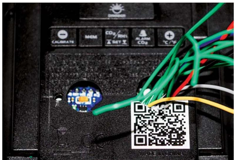
Bild 7: Durchführung der Kabel durch die Rückwand des technoline WL1030
