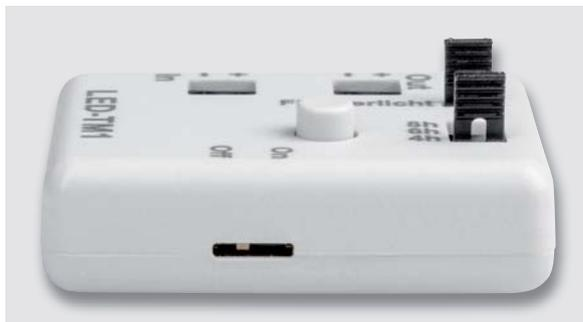
Bild 15: On-/Off-Schiebeschalter im Gehäuse
