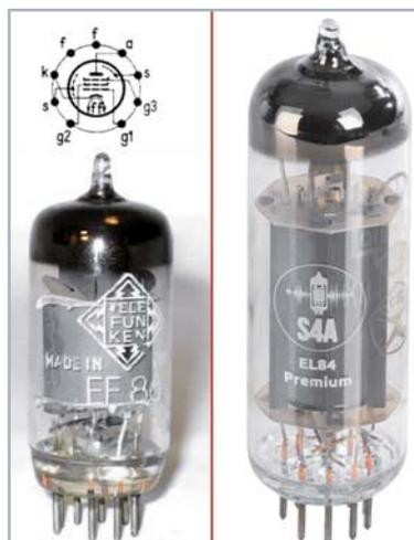
Bild 4: Vorverstärkerpentode EF 86 und Endpentode EL 84.
