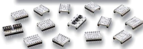
**Prototypenadapter (PAD)** sind ein praktisches Hilfsmittel zum professionellen Experimentieren auf dem Breadboard. Denn viele elektronische und mechanische Bauteile sind nicht Breadboard-kompatibel – die Anschlussdrähte sind zu dünn, zu kurz, zu lang, zu flexibel, nicht im Rastermaß oder haben die falsche Ausrichtung.
