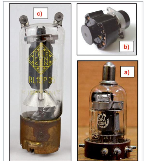
Bild 5: Pentode RV12 P 2000 (a) und RL12 P35 (c). Mit der RV12 P 2000 wurden erste Rundfunkempfänger gebaut, und sogar eines der ersten röhrenbestückten Hörgeräte (Siemens Phonophor-Super, [5]) kam 1948 mit dieser Röhre auf den Markt. Für die P2000 gab es eine eigens für sie geschaffene Fassung (b). Die RL12 P35 kam bei Kurzwellenamateuren beim Aufbau ihrer Sender zum Einsatz.
