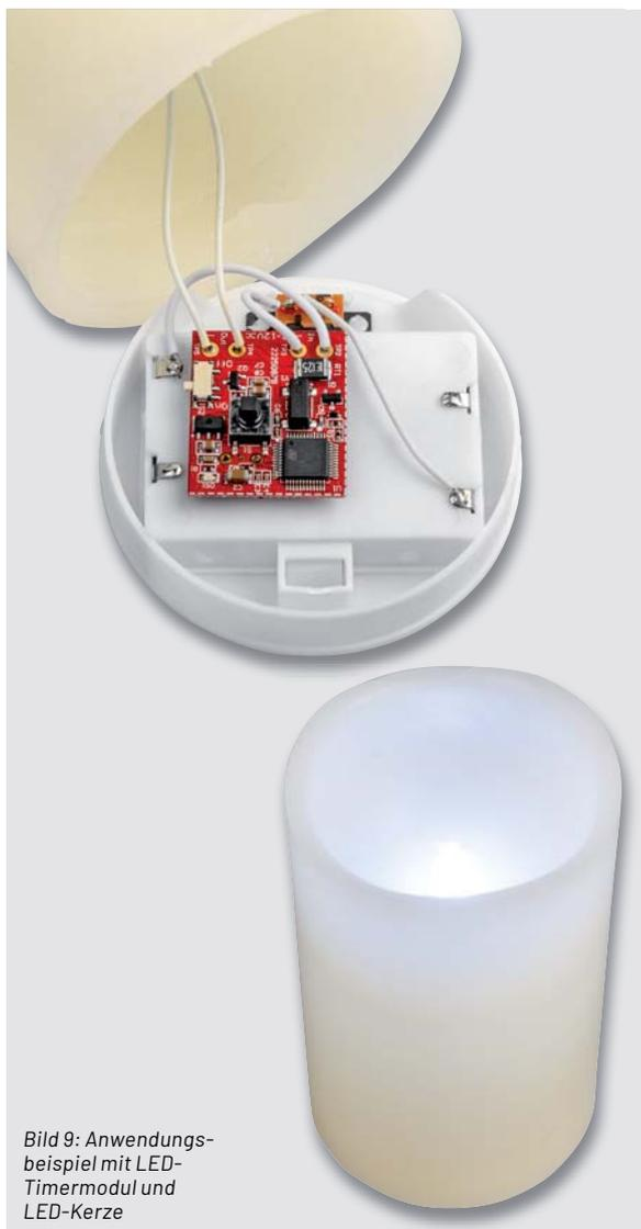
Bild 9: Anwendungsbeispiel mit LED-Timermodul und LED-Kerze
