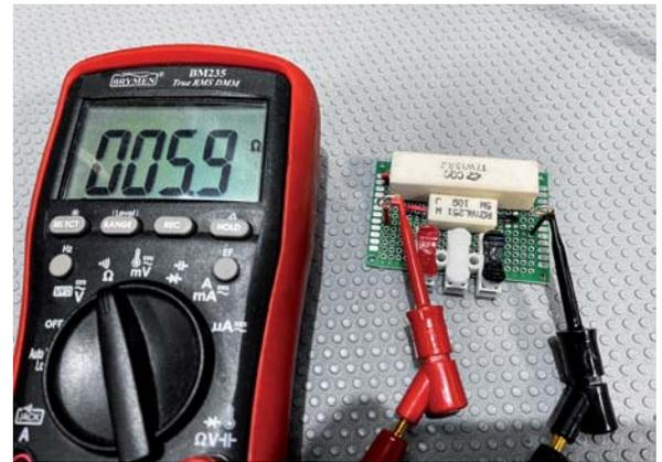
Bild 9: Blindlast mit parallel geschalteten Widerständen
