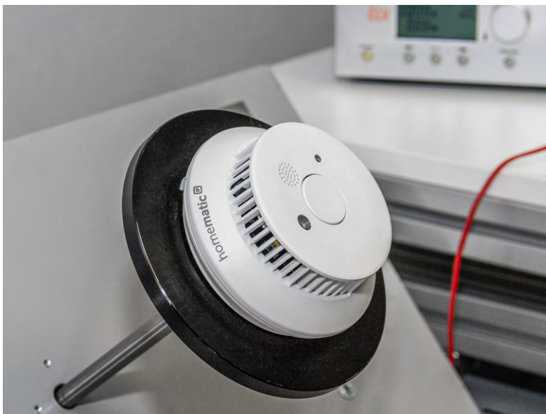
Bild 2: Der Prüfling wird im Rauchkanal an einem Drehteller zur Messung der Ansprechempfindlichkeit aus unterschiedlichen Anströmrichtungen montiert.
