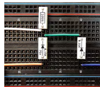
Abb. 4.42 Einfache Diodenlogik für eine Oder-Verknüpfung als Schaltbild (links) und als Aufbau auf dem Steckbrett (rechts). Die zugehörige Messung ist in der folgenden Abb. 4.43 gezeigt
