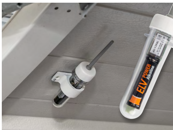
Bild 16: Mithilfe der via 3D-Druck erstellten Halterung kann der TACO auch direkt am Torflügel montiert werden.
