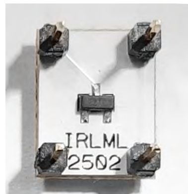
Bild 6: Der MOSFET selbst ist nur wenige Millimeter groß!
