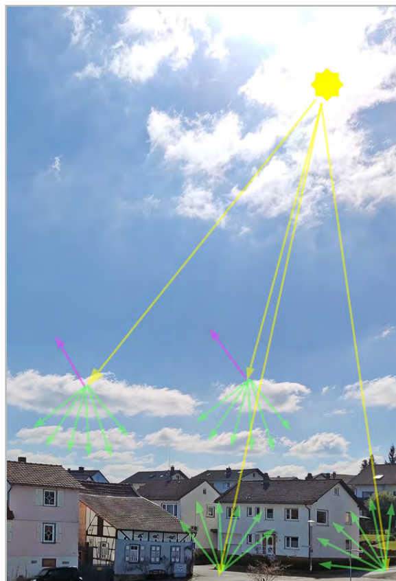
Bild 3: Das Sonnenlicht erreicht die Erdoberfläche entweder als direkte Strahlung oder in der Atmosphäre diffus gestreut. Beide Anteile überlagern sich zur Globalstrahlung.
