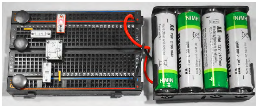
Bild 5: LED-Dimmer mit „Touch“-Funktion
