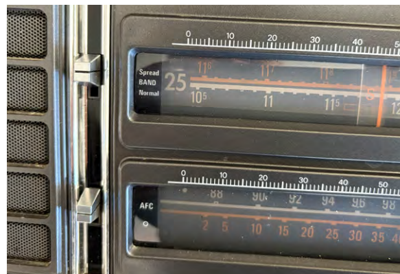
Bild 5: Normal- und Spread-Wahlschalter ermöglicht „Feinabstimmung“ innerhalb der SW-Bänder.
