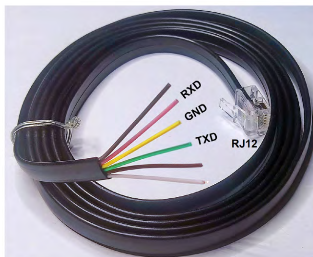
Bild 4: In einem ersten Anlauf wurde aus diesen Komponenten ein RS232-USB-Adapter selbst „gestrickt“.
