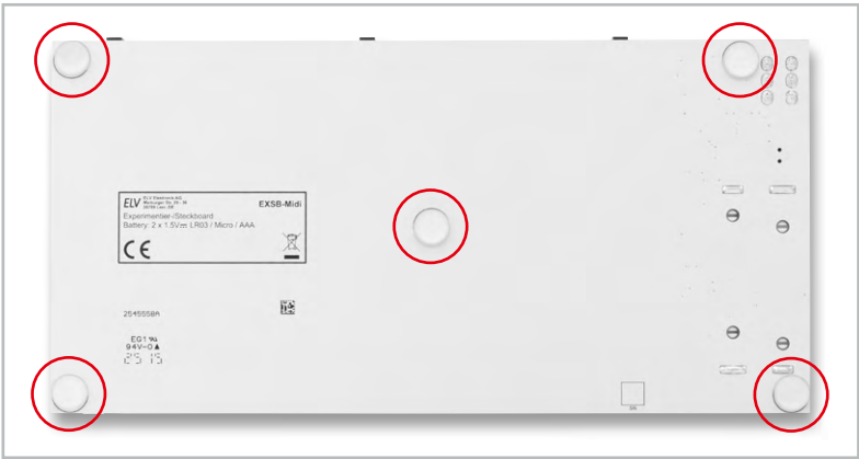
Bild 8: An den markierten Stellen werden die Klebefüße angebracht.
