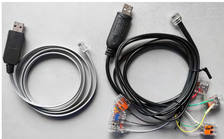
Bild 5: Links das von ACT erhältliche Adapterkabel und rechts die funktionsgleiche, aber nicht so schöne Do-it-yourself-Alternative.
