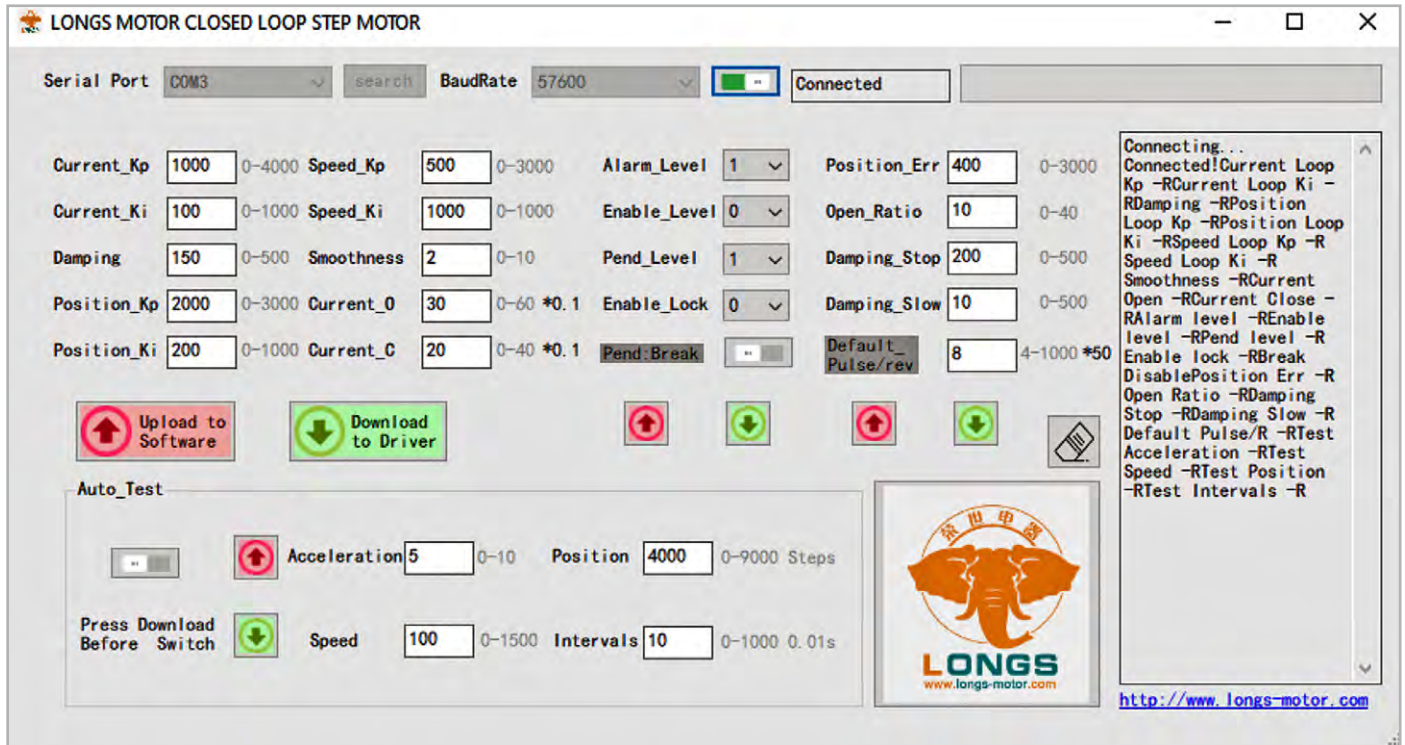
Bild 7: Wenn die Verbindung zwischen der USB-Schnittstelle des Windows-PCs und der RS232-Schnittstelle des ACT-Treibers mit RJ12-Buchse hergestellt ist, liest die Software LONGS_HBS_pro_Turn.exe als Erstes die Treiberparameter aus.
