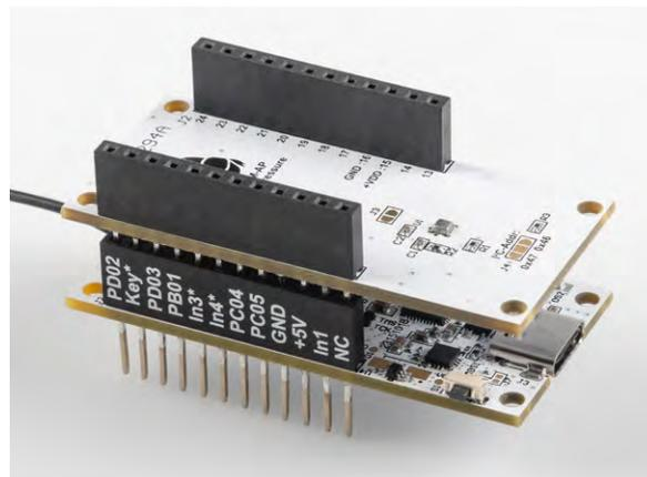
Bild 1: Die ELV Smart Home Sensor-Base (unten) mit dem ELV Applikationsmodul Luftdruck (oben)
